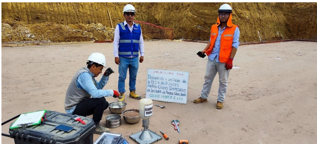
Figura 179: Verificación de ensayos de densidad de campo punto 01 – módulo 09 y 10.
