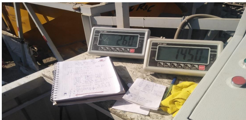
Figura 95: Se aprecia el tablero de control donde se realizan las dosificaciones.
