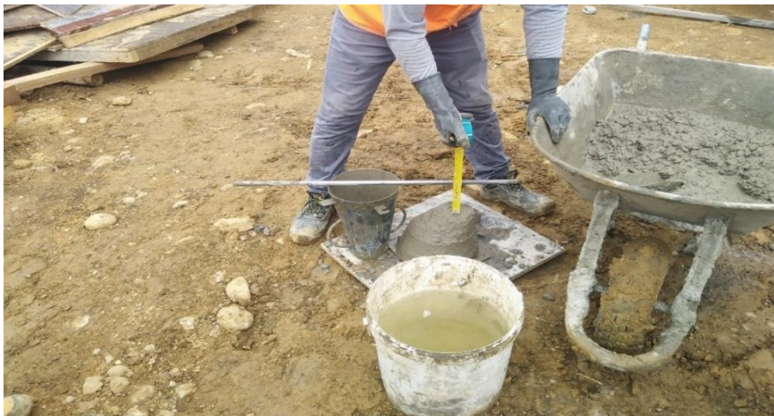
Figura 223: Prueba de slump y/o asentamiento del concreto premezclado.
