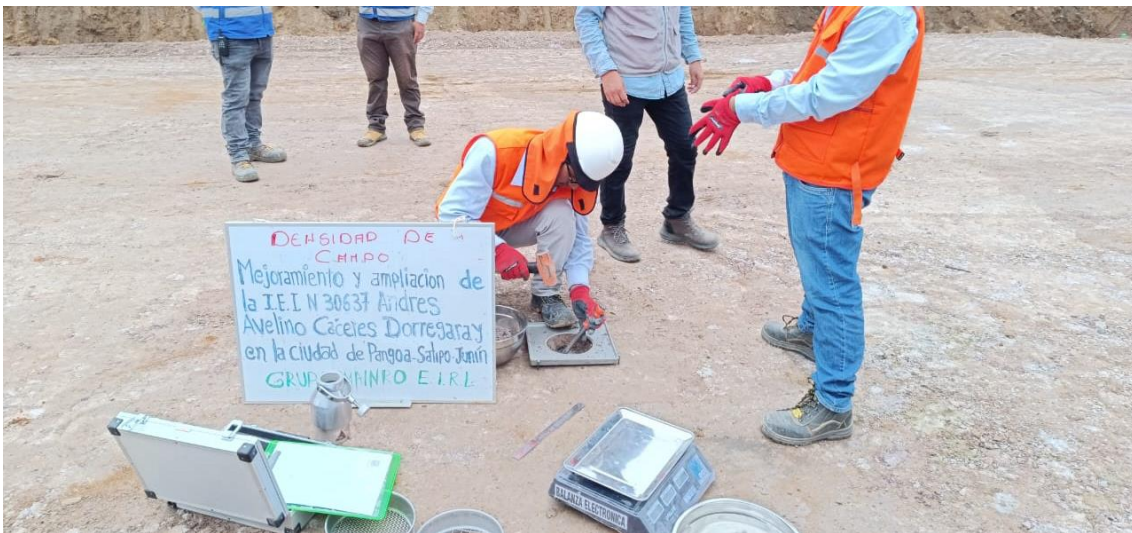
Figura 196: Ensayo de densidad de campo – Bloque 11.
