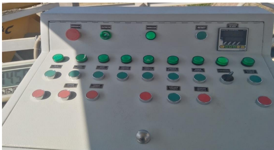
Figura 95: Se aprecia el tablero de control donde se realizan las dosificaciones.
