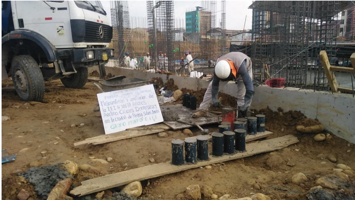
Figura 140: Extracción de testigos de concreto f'c=280 \text{ kg/cm}^2 – vaciado de losa de cimentación módulo 4.
