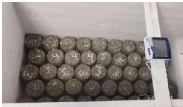
Fig. 6. Muestras de concreto permeable dentro de la congeladora para ser sometidas a ciclos FT.
