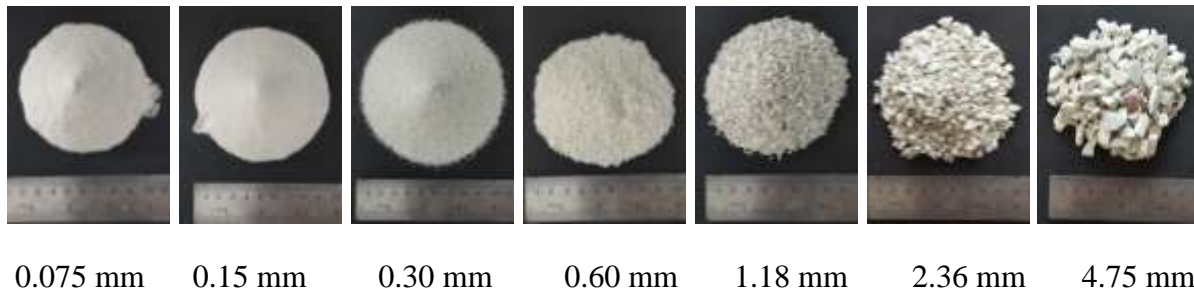
Fig. 1. PW triturada y tamizada en el rango de agregado fino (0.075-4.75mm).
