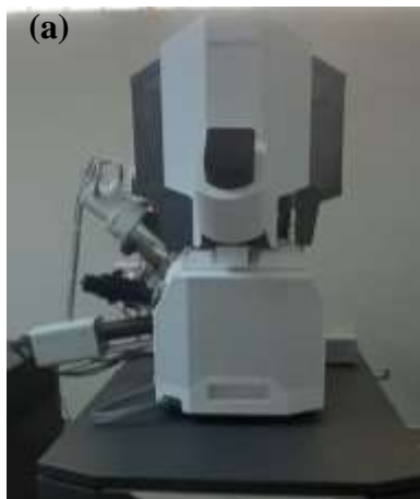
Fig. 7. (a) Microscopio electrónico de barrido - FIB – SEM Scios 2 LoVa, (b) muestras recubiertas en oro.
