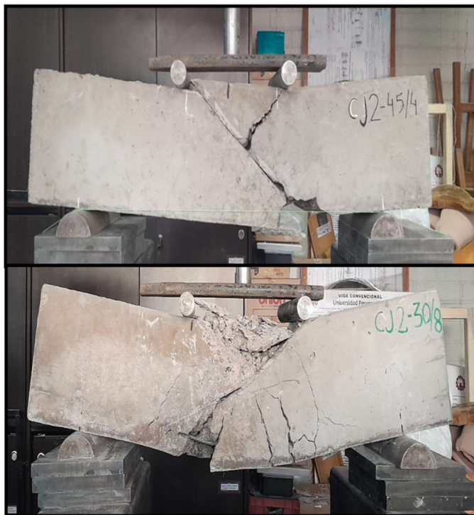
Figura 12. Patrones de grietas finales en el grupo B (Arriba- junta con inclinación a 45^\circ ) y C (Abajo - junta con inclinación a 30^\circ ).
