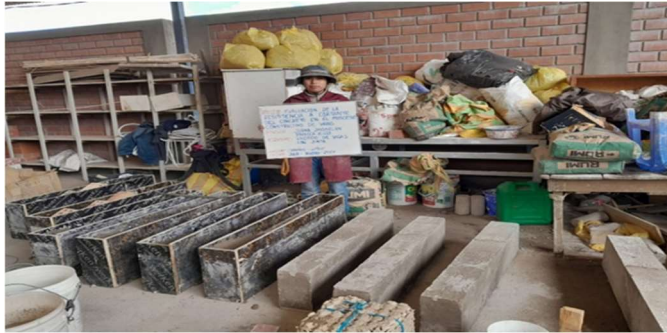
Figura 9. Vaciado de especímenes en las instalaciones de la universidad Peruana Unión.
