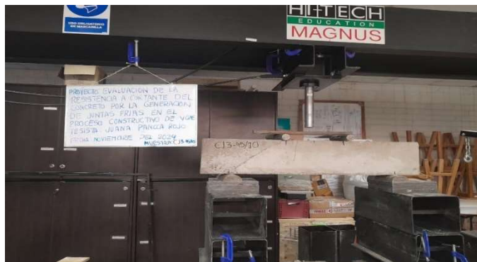
Figura 10. Resistencia a corte de vigas sometidas por ensayo a flexión.
