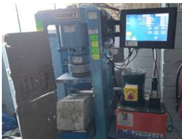
Figura 13. Ensayo de Modulo de rotura.
