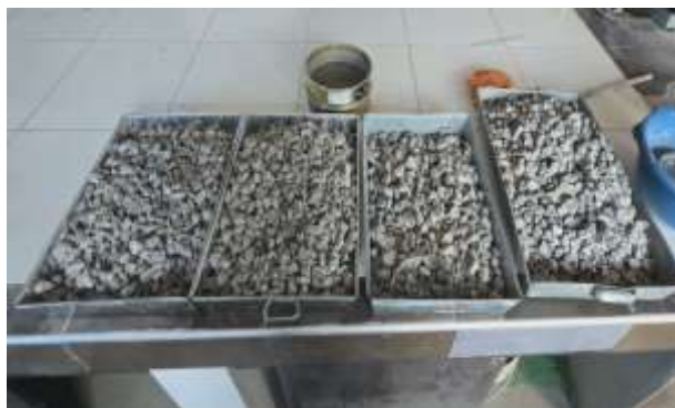
Figura 3. Proceso de tamizado de RAP, \frac{3}{4} " y \frac{1}{2} ".
