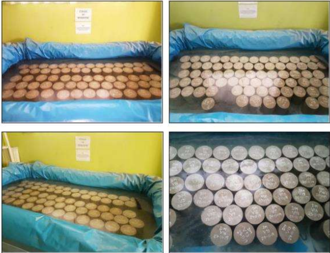
Fotografía 37. Curado de briquetas de las distintas obras en el distrito Cm Gregorio Albarracín Lanchipa.
