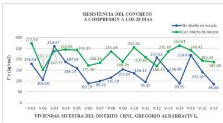
Fig. 4. Comparación entre la resistencia a la compresión de concreto estructural elaborado mediante un diseño de mezcla y aquel sin un diseño específico.
