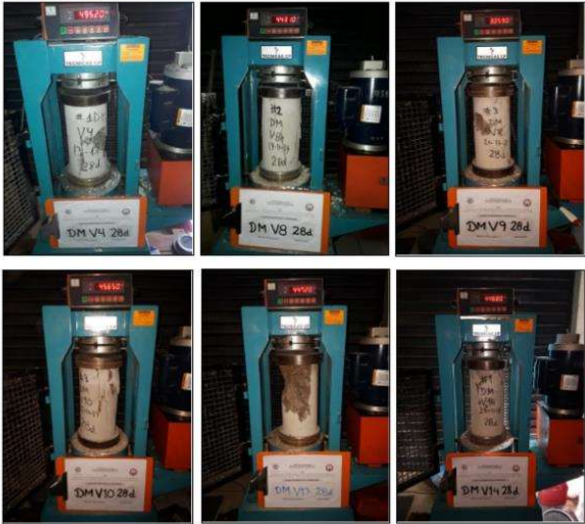
Fotografía 39. Briquetas ensayadas a compresión, concreto elaborado en base a un diseño de mezcla.
