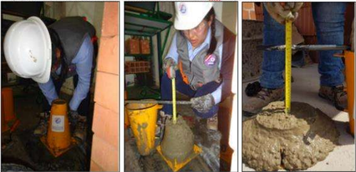
Fotografía 33. Ensayo de Cono de Abrams ( Slump ).
