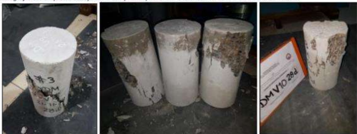
Fotografía 40. Briquetas luego de ser ensayadas a compresión, concreto elaborado en base a un diseño de mezcla.
