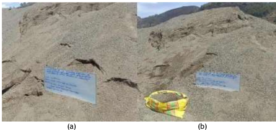
Fig. 3 En la figura (a) se muestra la arena chancada y en la figura (b) se aprecia la arena natural
