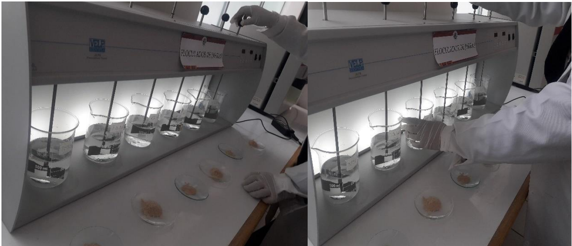
Preparando el floculador de jarras para empezar con la prueba de bioadsorción con la biomasa de tara.
