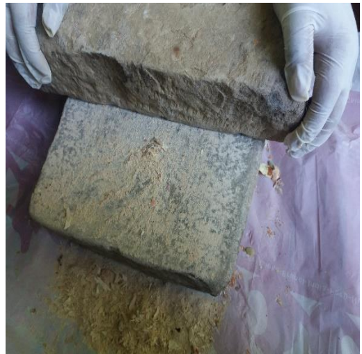
Obtención de las biomásas de la vaina de tara y frijol, utilizando molino manual (Batán)
