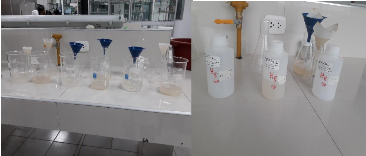
Filtración de la solución y acondicionamiento del mismo.
