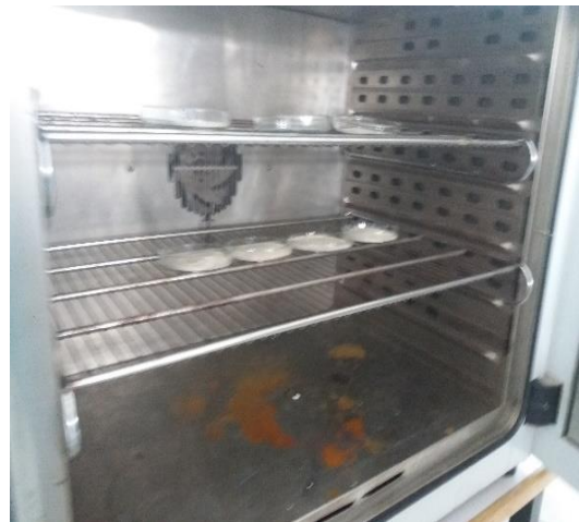
Desecado de las biomásas a una temperatura de 105 ^{\circ} C durante 40 min.
