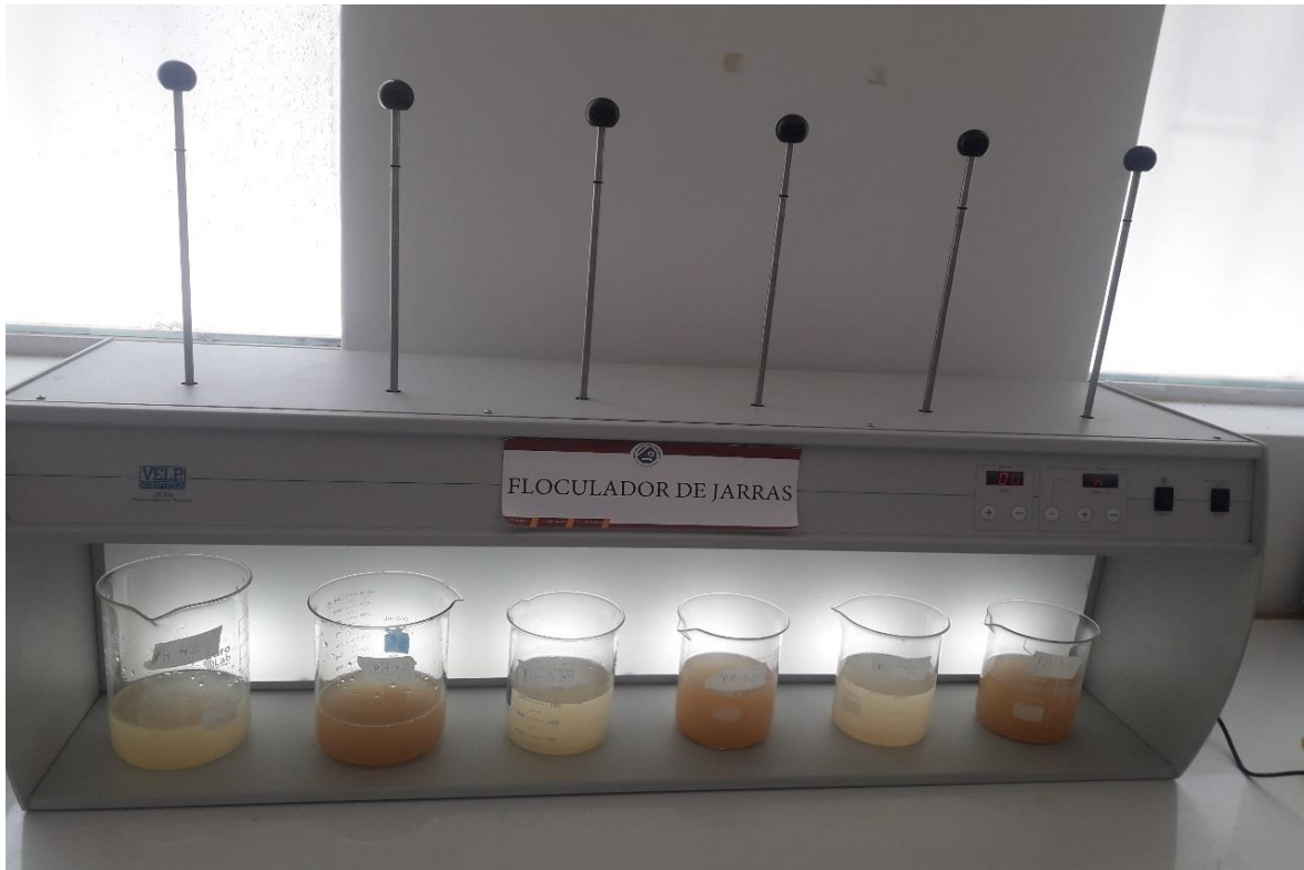
Sedimentación de la solución tratada con la biomasa de tara durante 30 min.
