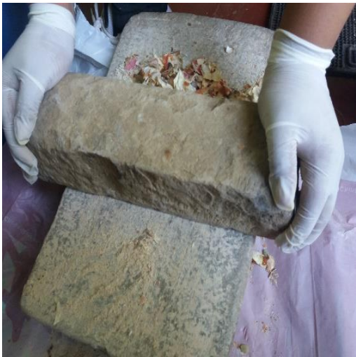
Obtención de las biomásas de la vaina de tara y frijol, utilizando molino manual (Batán)
