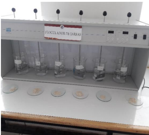
Preparando el floculador de jarras para empezar con la prueba de bioadsorción con la biomasa de frijol.
