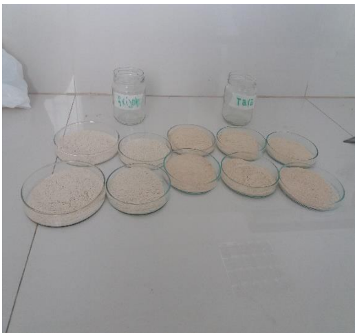
Desecado de las biomásas a una temperatura de 105 ^{\circ} C durante 40 min.
