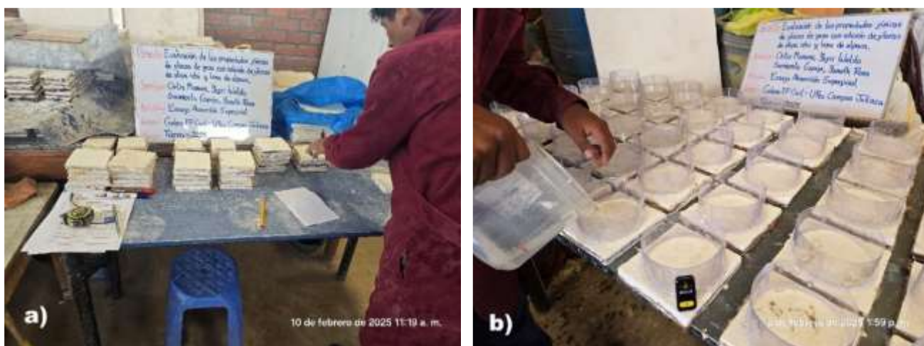
Figura 3: (a) Elaboración de probetas y (b) Medición de tasa de absorción superficial de probeta. Fuente: Elaboración propia.
