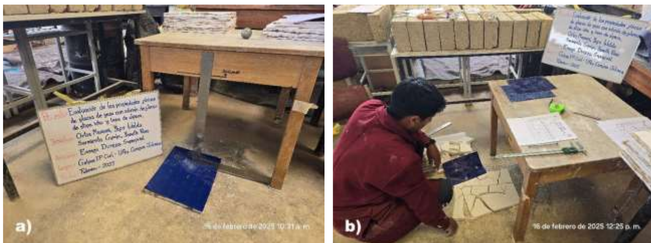
Figura 8: (a) Equipo empleado para el ensayo de dureza superficial y (b) Falla frágil por carga de impacto en probeta de control. Fuente: Elaboración propia.
