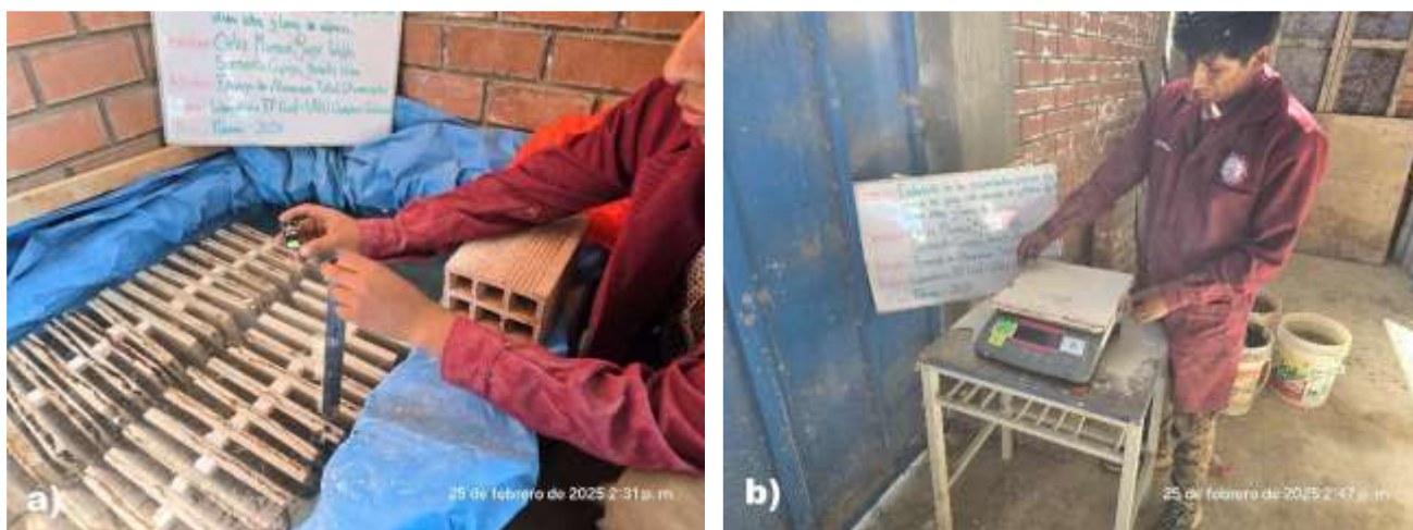
Figura 4: (a) Probetas sumergidas totalmente durante 2 horas y (b) Registro de peso húmedo de probetas. Fuente: Elaboración propia.
