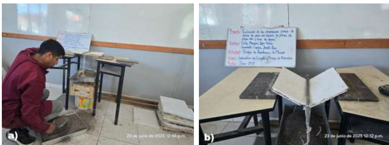
Figura 7: (a) Medición de resistencia a flexión y (b) Falla por flexión de probeta ensayada. Fuente: Elaboración propia.
