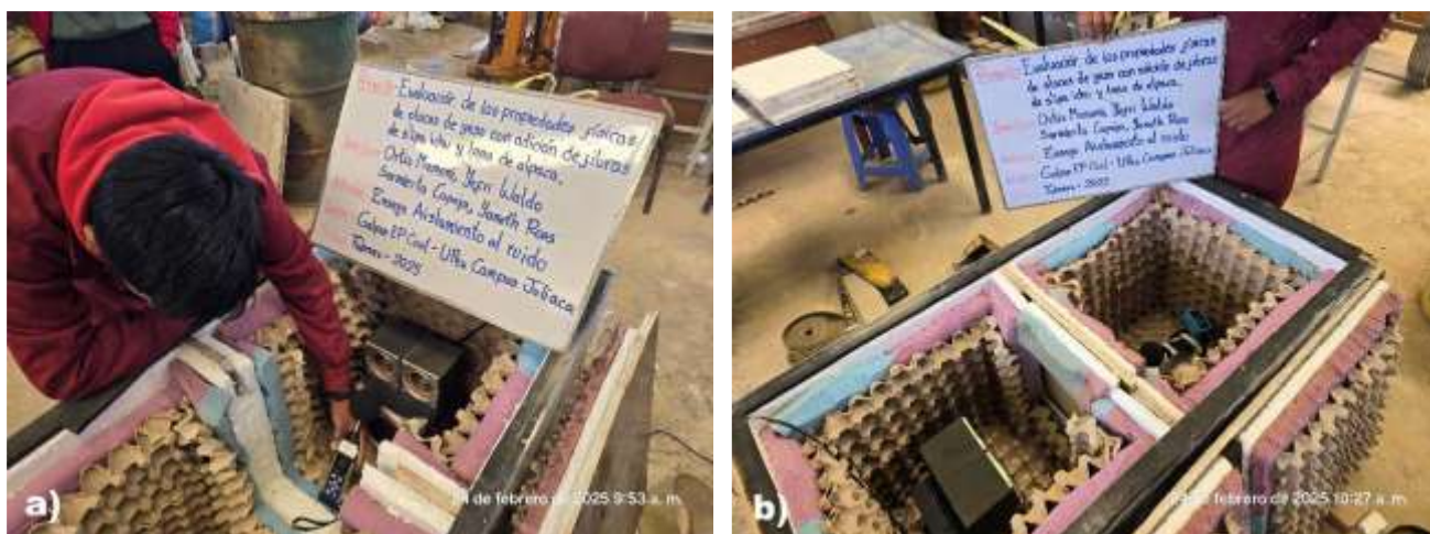
Figura 5: (a) Medición de ruido en punto emisor y (b) Colocado de muestra entre cámaras. Fuente: Elaboración propia.
