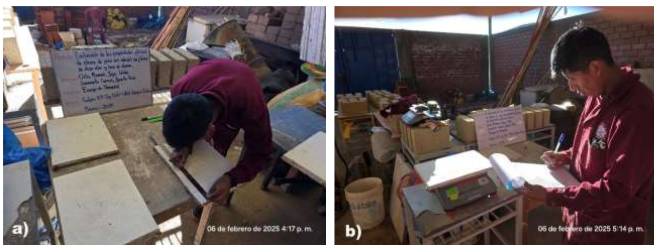
Figura 2: (a) Medición de dimensiones de probeta y (b) Medición de peso de probetas. Fuente: Elaboración propia.
