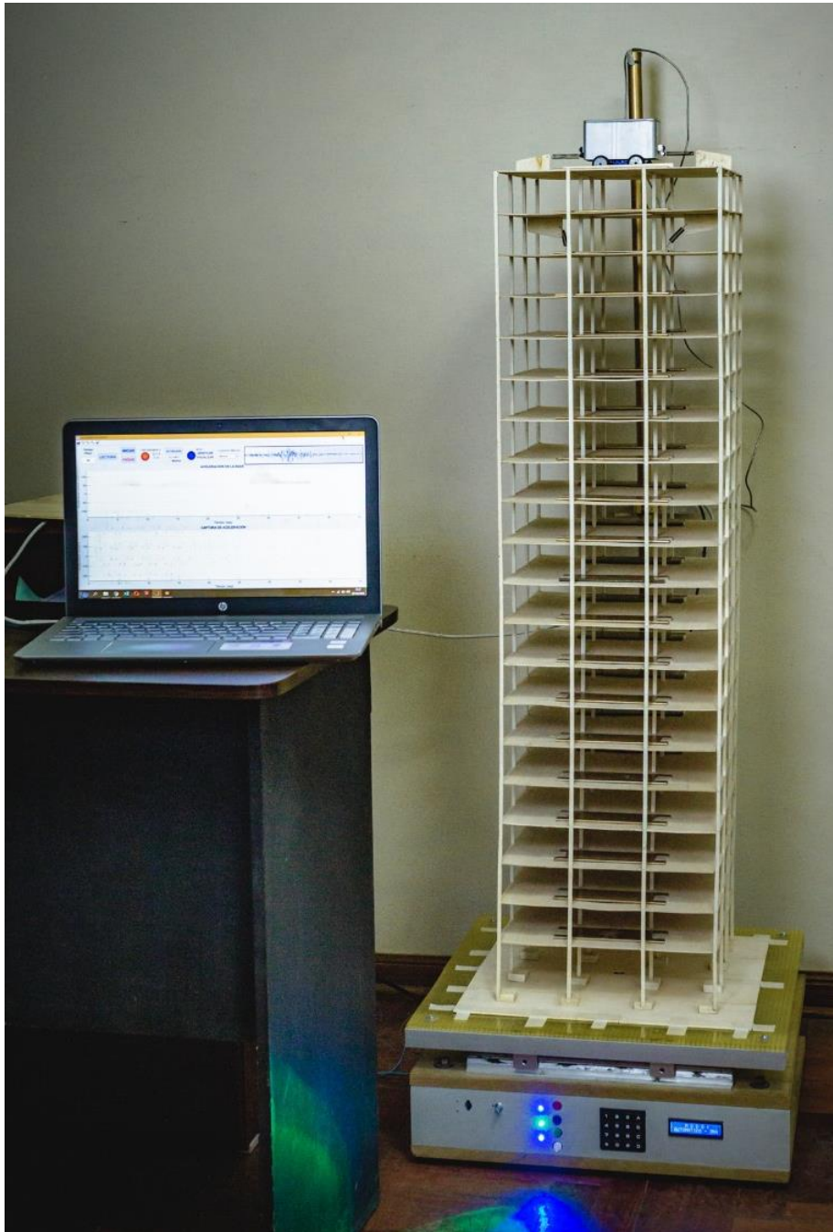
Figura 53. Medición 2 - estructura con AMS convencional. Fuente: Elaboración propia
