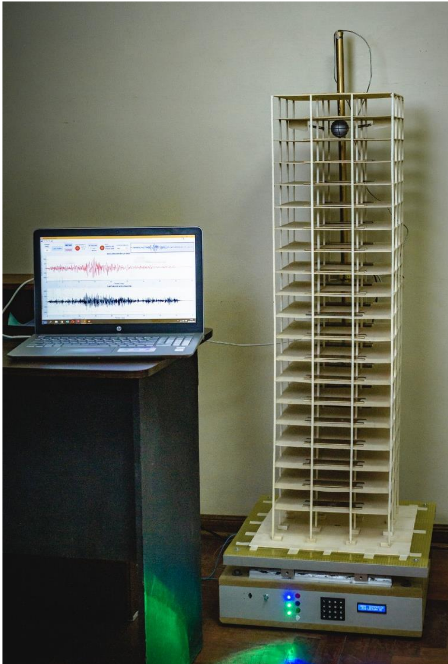
Figura 54. Medición 3 - estructura con AMS Pendular. Fuente: Elaboración propia
