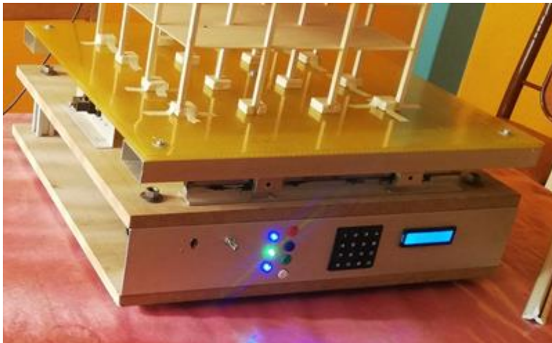
Figura 47. Mesa vibratoria finalizada. Fuente: Elaboración propia
