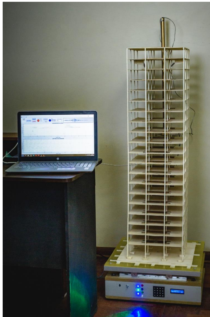
Figura 52. Medición 1 - estructura sin AMS. Fuente: Elaboración propia
