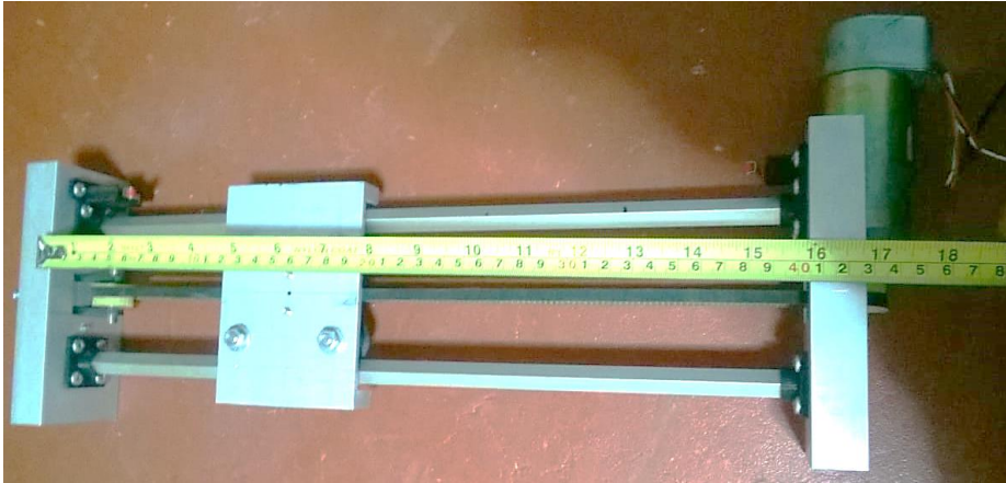
Figura 41. Estructura previa hecha con perfiles de aluminio. Fuente: Elaboración propia
