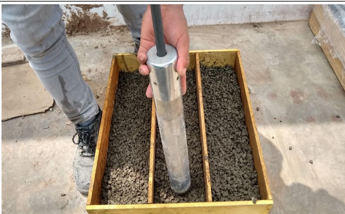
Fotografía N° 22. Compactación ligera de viguetas de concreto permeable con martillo proctor estandar.
