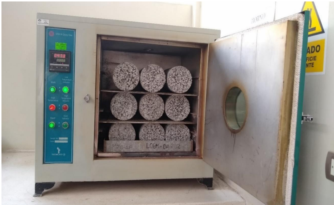
Fotografía N° 27. Secado de especímenes en el horno a una temperatura de 110 \pm 5 °C por 24 horas.
