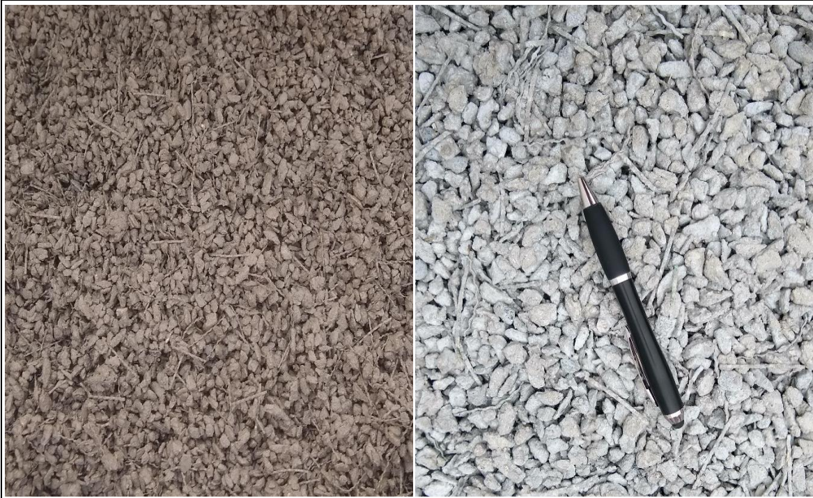
Fotografía N° 43. Fibras PET en concreto permeable en estado fresco y en estado endurecido.
