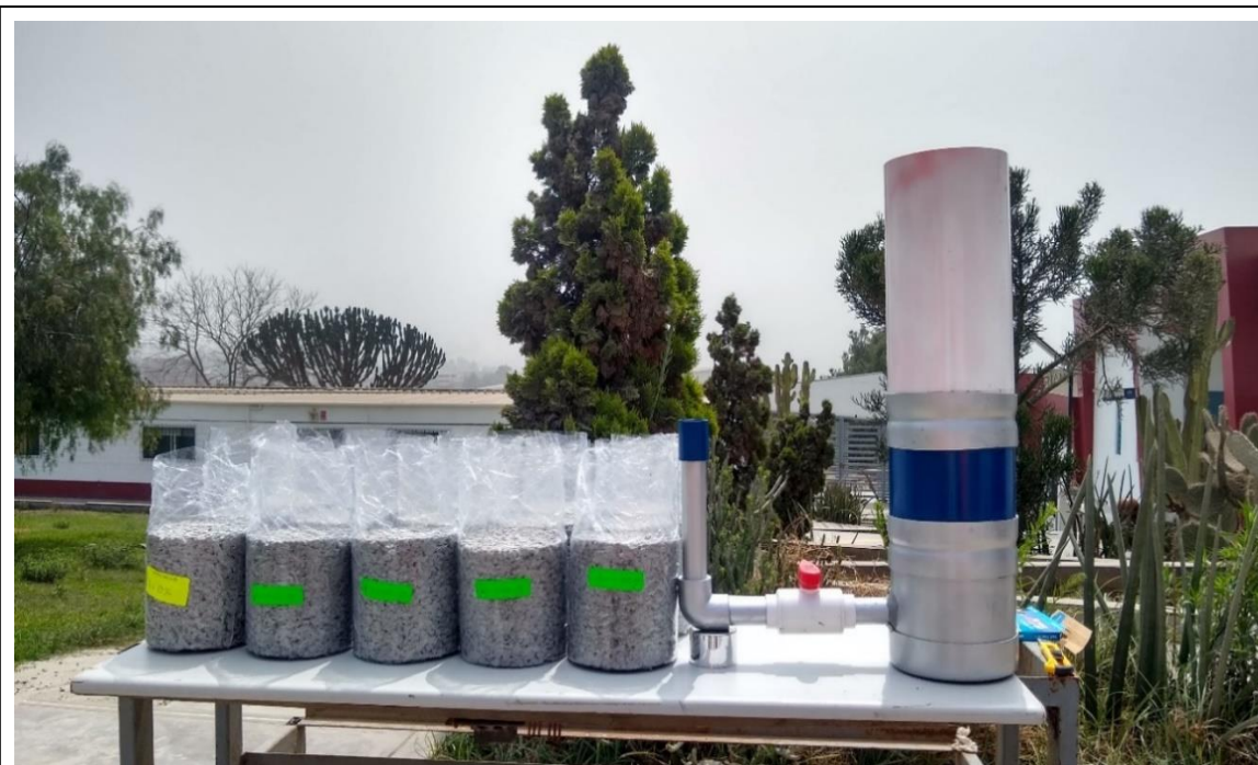
Fotografía N° 30. Ensayo de permeabilidad en un permeámetro de cabeza descendente con especímenes de 15 x 15 cm envueltos con film para evitar que el agua fluya por los lados de la muestra.
