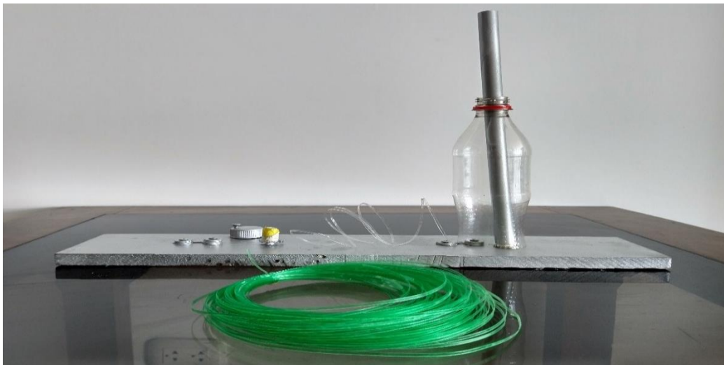
Figura 18. Obtención de tiras de botella en la cortadora.
