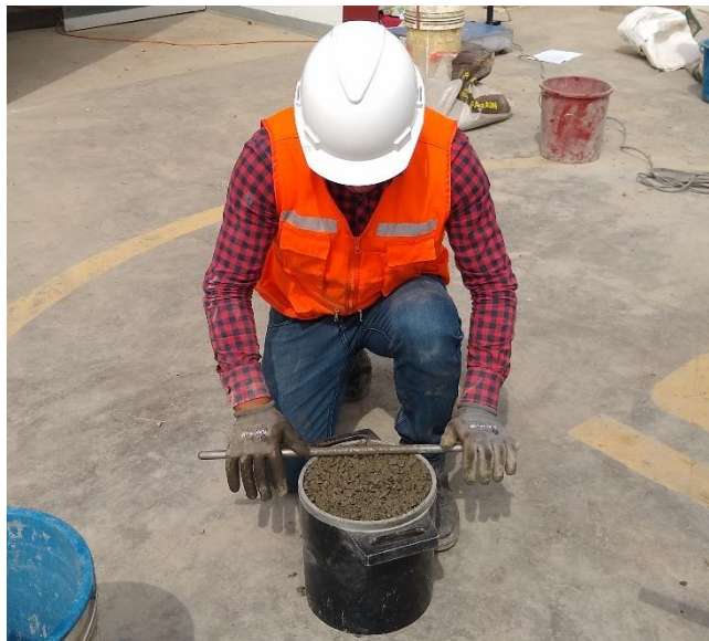
Figura 24. Ensayo de Peso Unitario de concreto permeable con adición de fibras PET.
