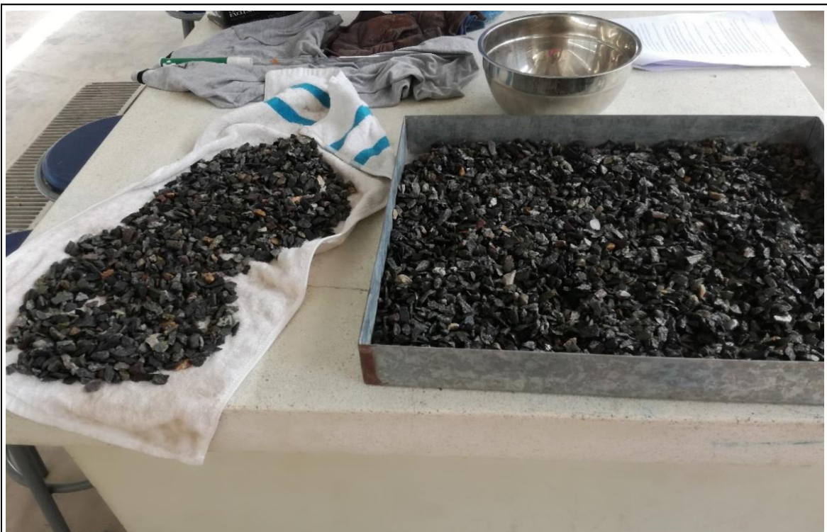
Fotografía N° 06. Proceso de eliminar agua con una toalla para que este saturado superficialmente seca
