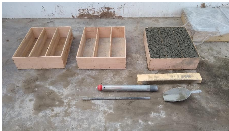
Figura 28. Elaboración de viguetas compactando con martillo proctor estándar en moldes de madera.
