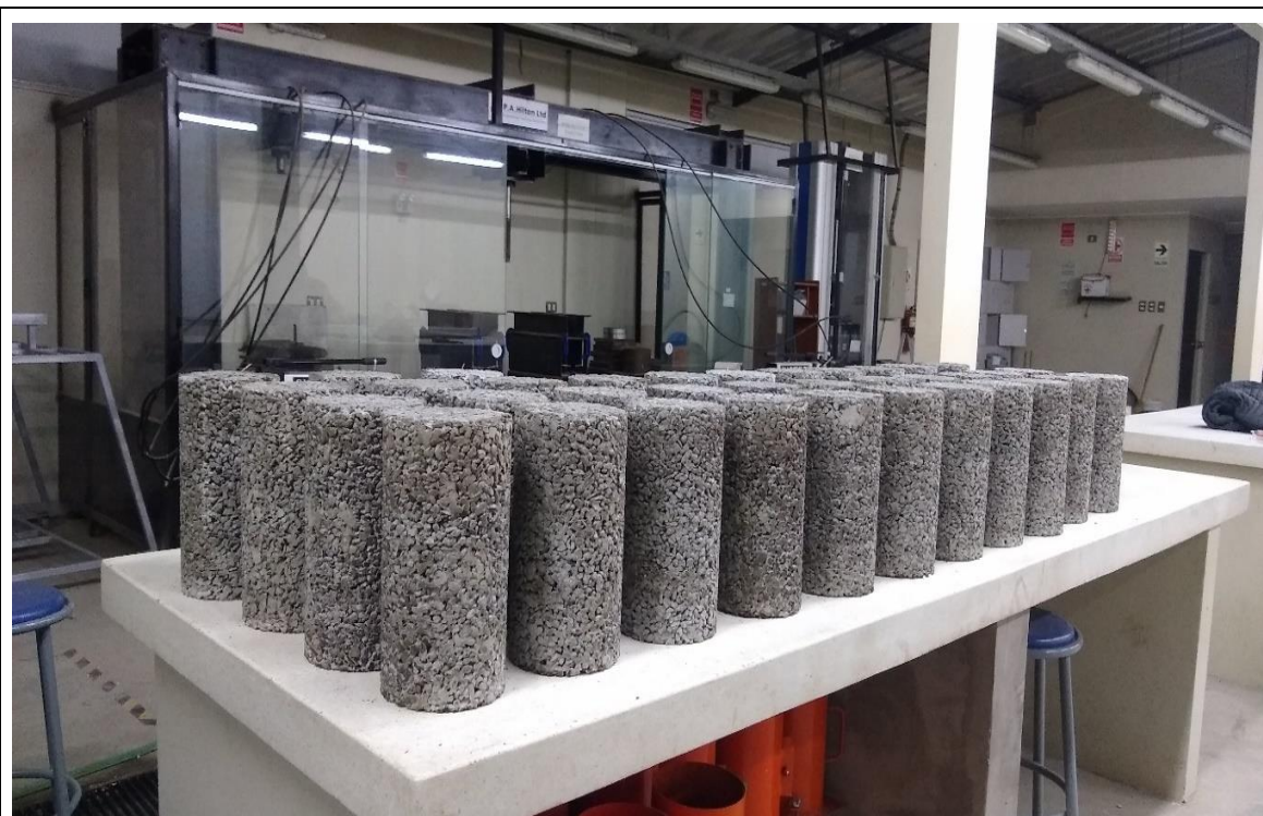
Fotografía N° 18. Especímenes de concreto permeable después de cumplir su edad en cámara de curado.
