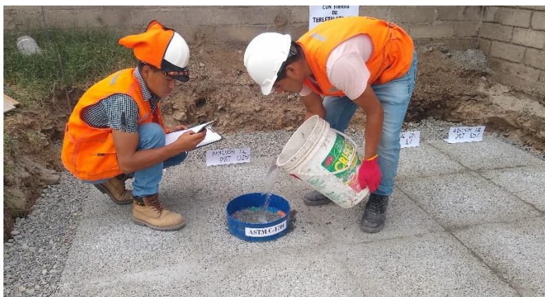
Figura 33. Ensayo de tasa de infiltración en pavimento de concreto permeable con adición de fibras PET.
