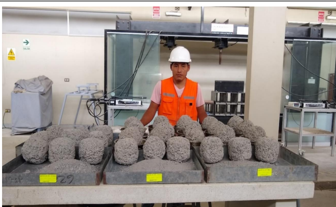
Fotografía N° 32. Especímenes después de pérdida de masa por ser sometidas a la acción combinada de impacto y abrasión.
