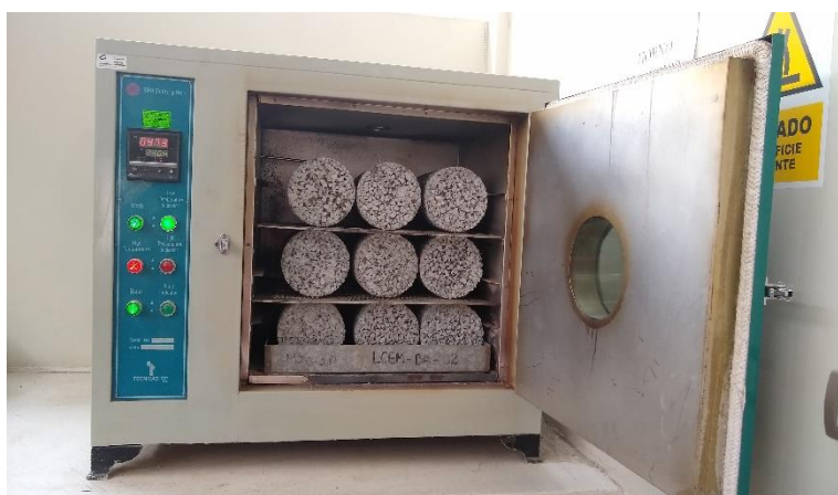
Figura 29. Secado de especímenes en horno a una temperatura de 110 \pm 5 °C
