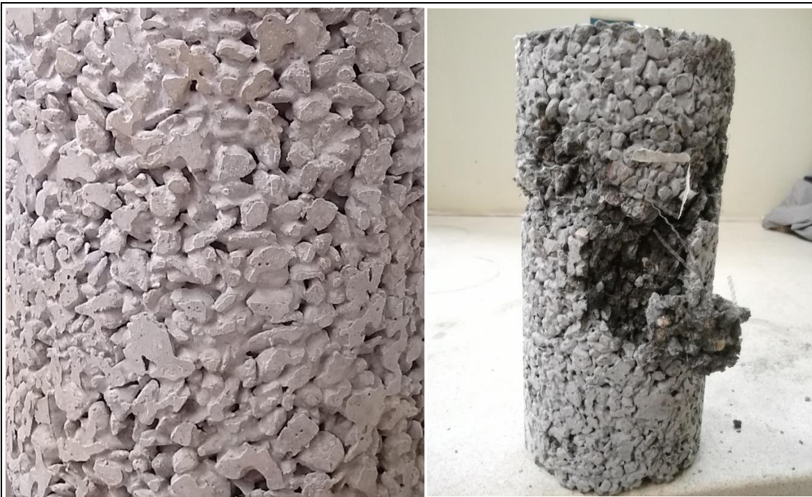
Fotografía N° 44. Muestra de porosidad en concreto permeable en estado endurecido; briqueta después del ensayo a compresión con fibras PET.
