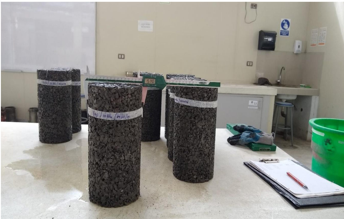
Fotografía N° 19. Registro de medición de especímenes con vernier digital para ser ensayados.
