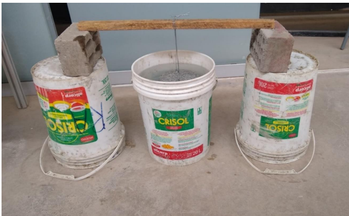
Fotografía N° 28. Saturación de especímenes de concreto permeable en agua.
