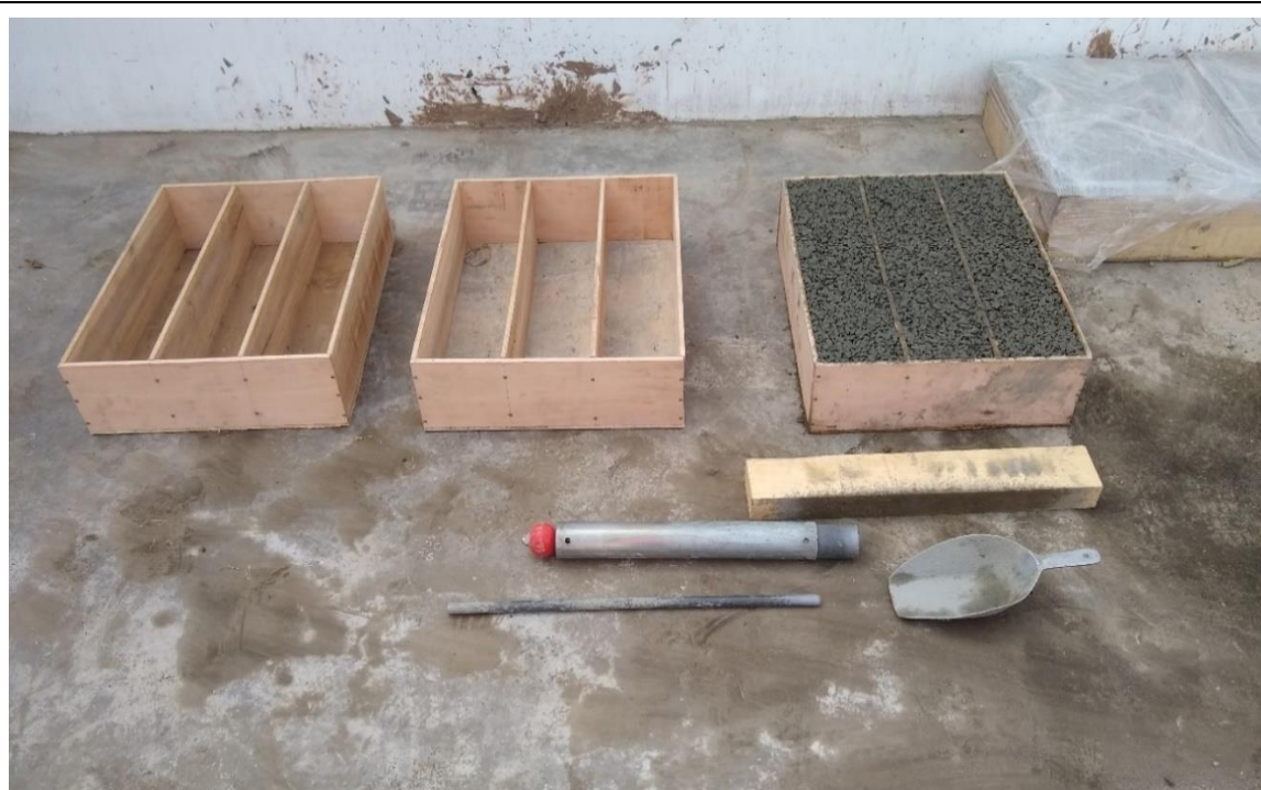
Fotografía N° 21. Elaboración de viguetas 15x15x55 cm en moldes de madera
