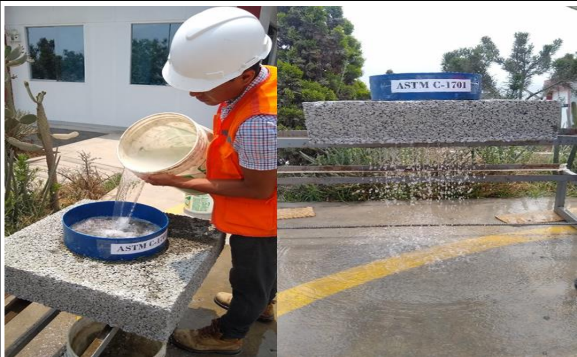
Fotografía N° 35. Ensayo de tasa de infiltración usando 18 kg de agua manteniendo una cabeza entre líneas marcadas a una altura de 10 y 15 mm siendo constante para registrar el tiempo de infiltración.
