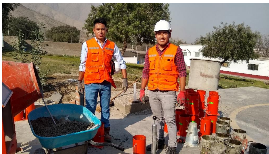
Figura 26. Compactación con martillo proctor estándar de concreto permeable con adición de fibras PET.
