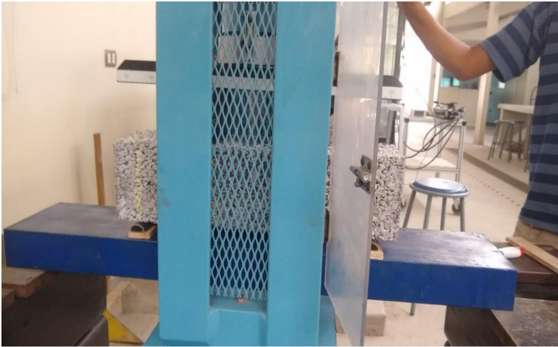
Fotografía N° 25. Ensayo de viguetas en la prensa de compresión con dos apoyos y con dos cargas puntuales.
