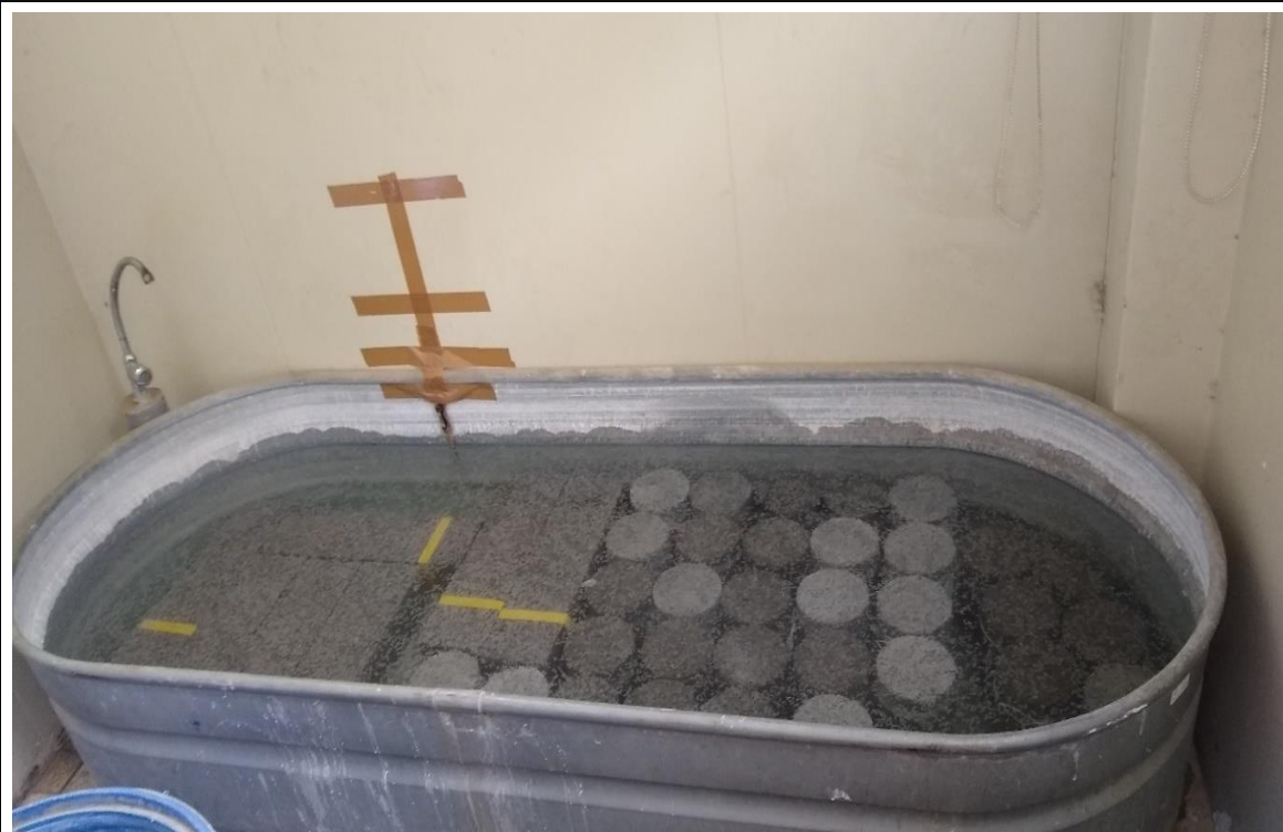
Fotografía N° 17. Viguetas y especímenes de concreto permeable en cámara de curado controlado por un termómetro digital.
