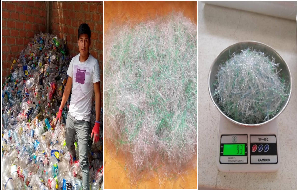
Fotografía N° 11. Reciclaje de botellas de PET y fibras PET para adicionar a la mezcla de concreto permeable.
