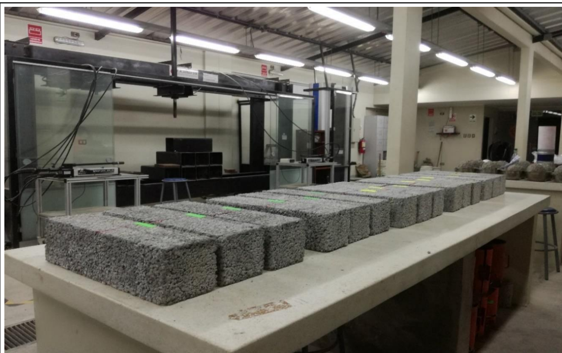
Fotografía N° 24. Medición de viguetas después del curado para ser ensayados con sus respectivas etiquetas por grupo de adición.
