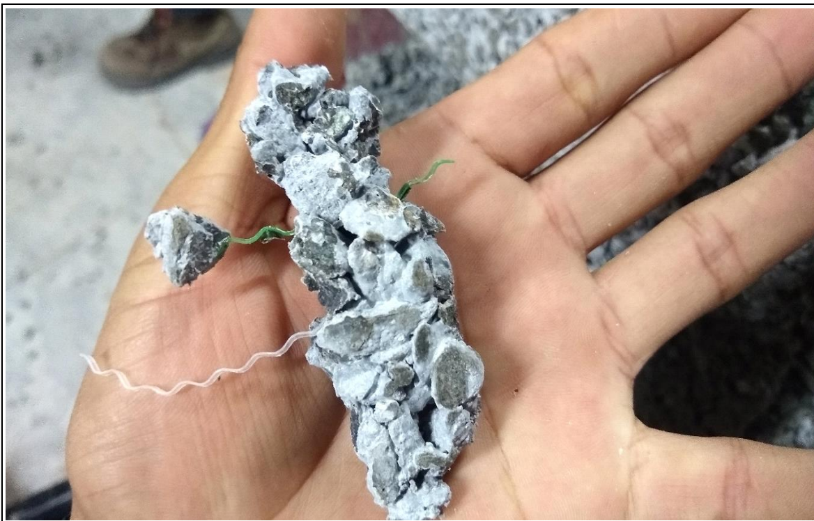
Fotografía N° 46. Adherencia de fibras de tereftalo de polietileno con el concreto permeable.
