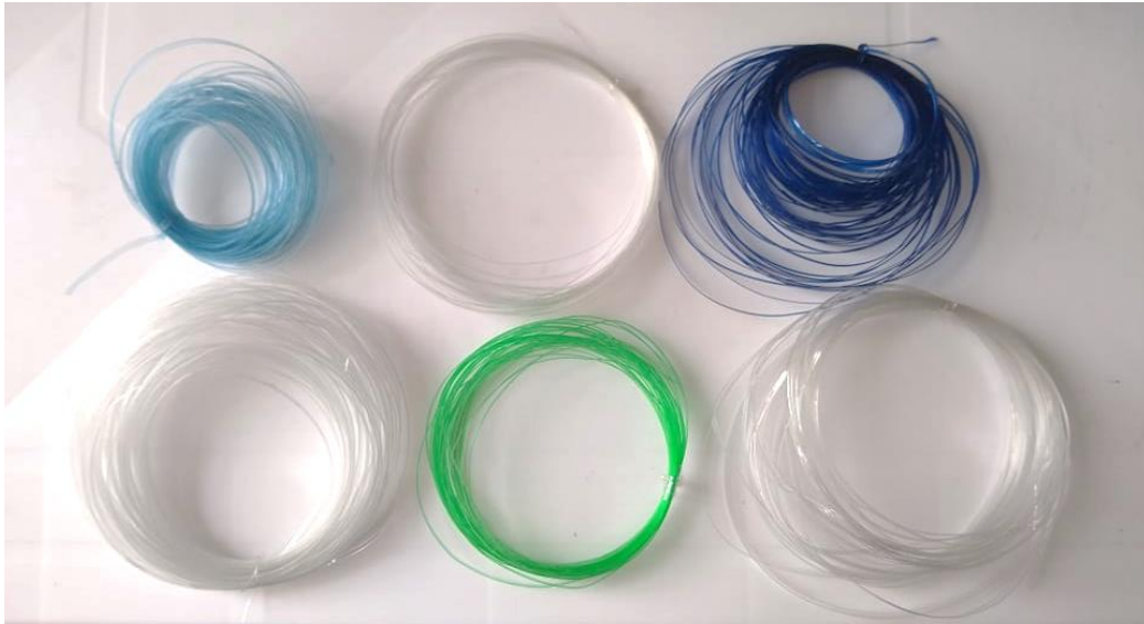
Figura 19. Rollos de tiras de botellas de tereftalato de polietileno reciclado.
