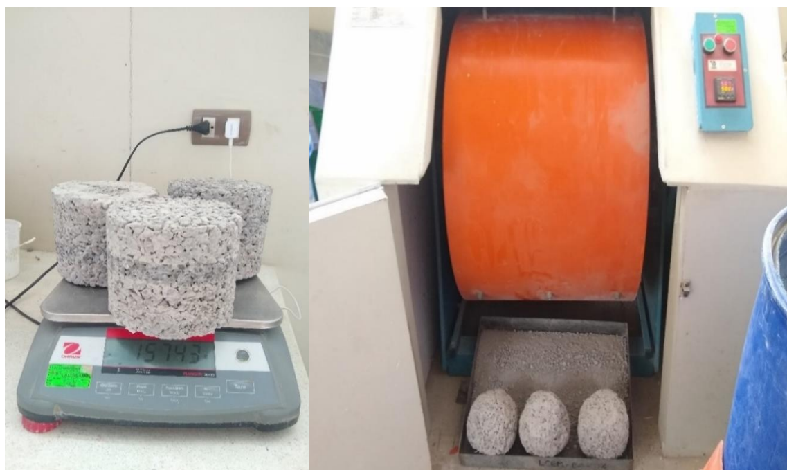
Fotografía N° 31. Ensayo de resistencia potencial a la degradación por impacto y abrasión con especímenes de 15x15 cm en un tambor de acero rotatorio durante 500 revoluciones.
