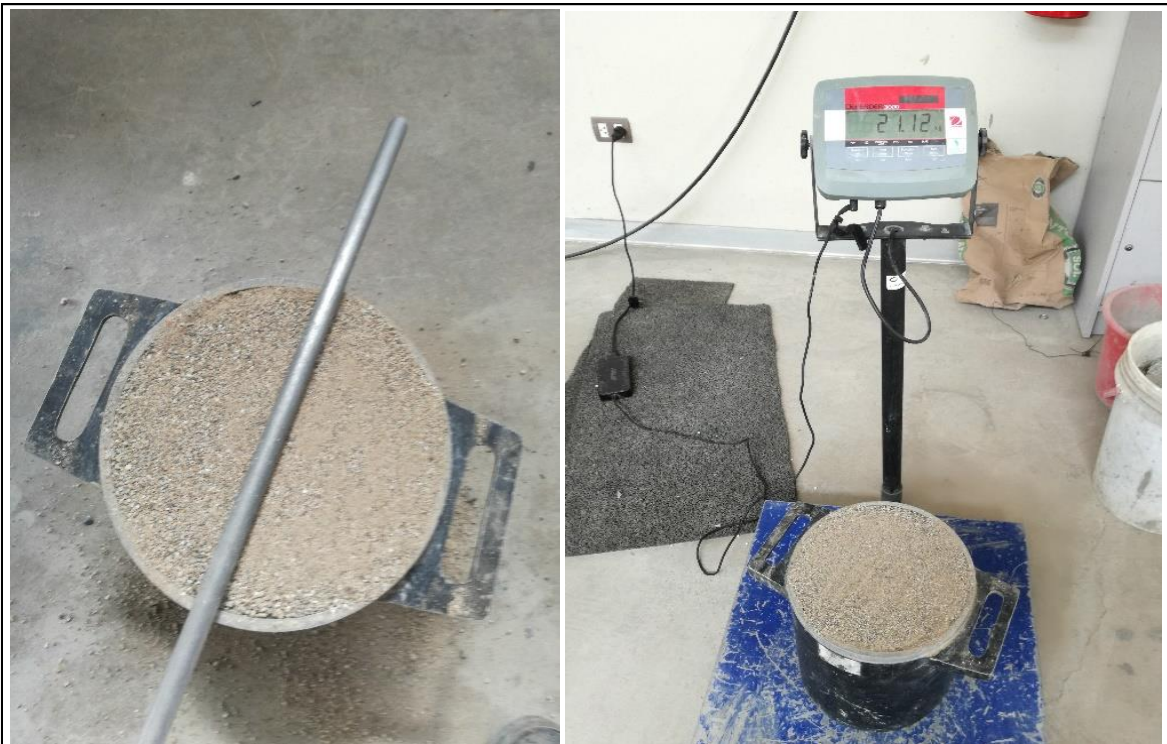
Fotografía N° 08. Ensayos de peso unitario en arena gruesa
