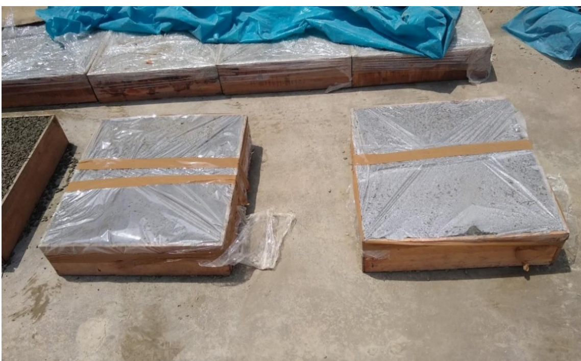
Fotografía N° 34. Curado de losas de concreto permeable forrado con film por 14 días.
