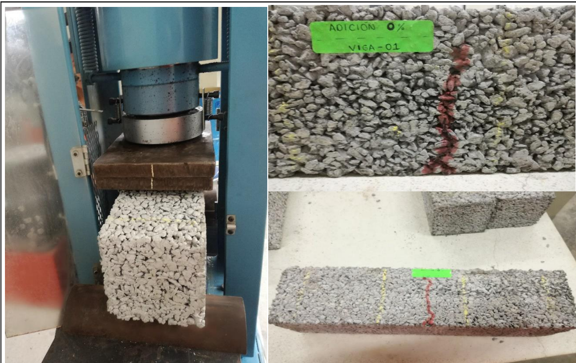
Fotografía N° 26. Fallas en la vigas se presentan en la parte central.
