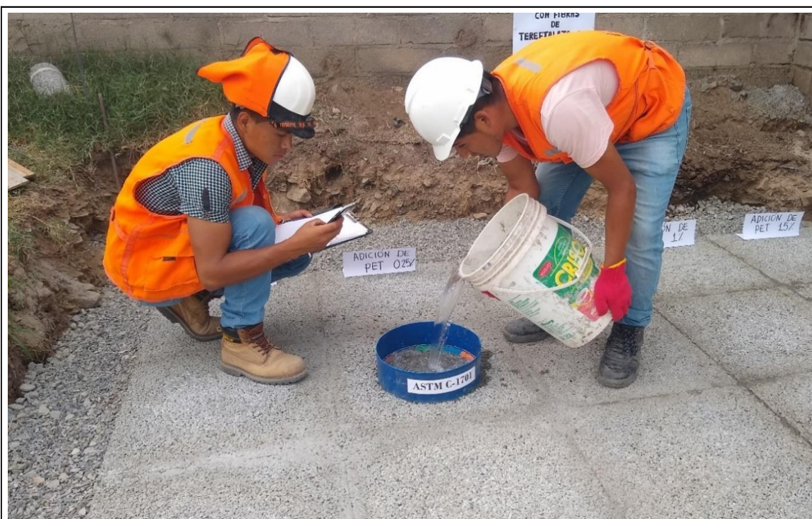
Fotografía N° 40. Ensayo de tasa de infiltración en pavimento permeable - campo..
