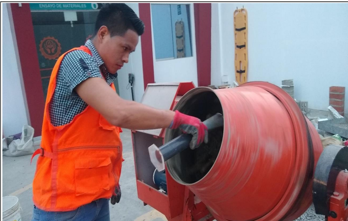
Fotografía N° 10. Adición de aditivo en el momento de mezclado de concreto permeable.
