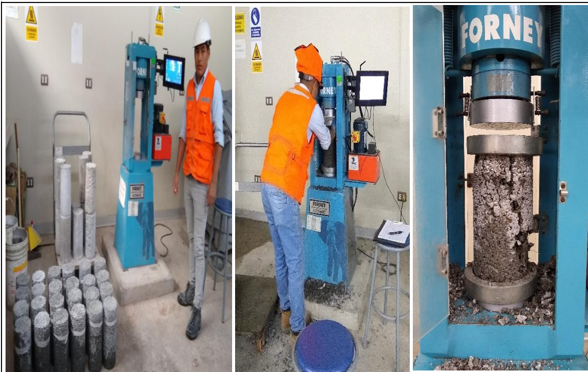
Fotografía N° 20. Ensayo de especímenes en máquina de ensayo de Resistencia a Compresión.
