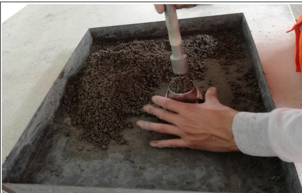
Fotografía N° 04. Colocación de muestra suelta al tope del cono y ligeramente apisonado con 25 golpes con la barra compactador.
