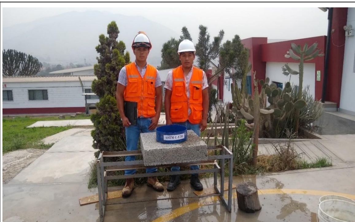
Fotografía N° 36. Ensayo de tasa de infiltración en laboratorio usando un anillo sellado a la losa.
