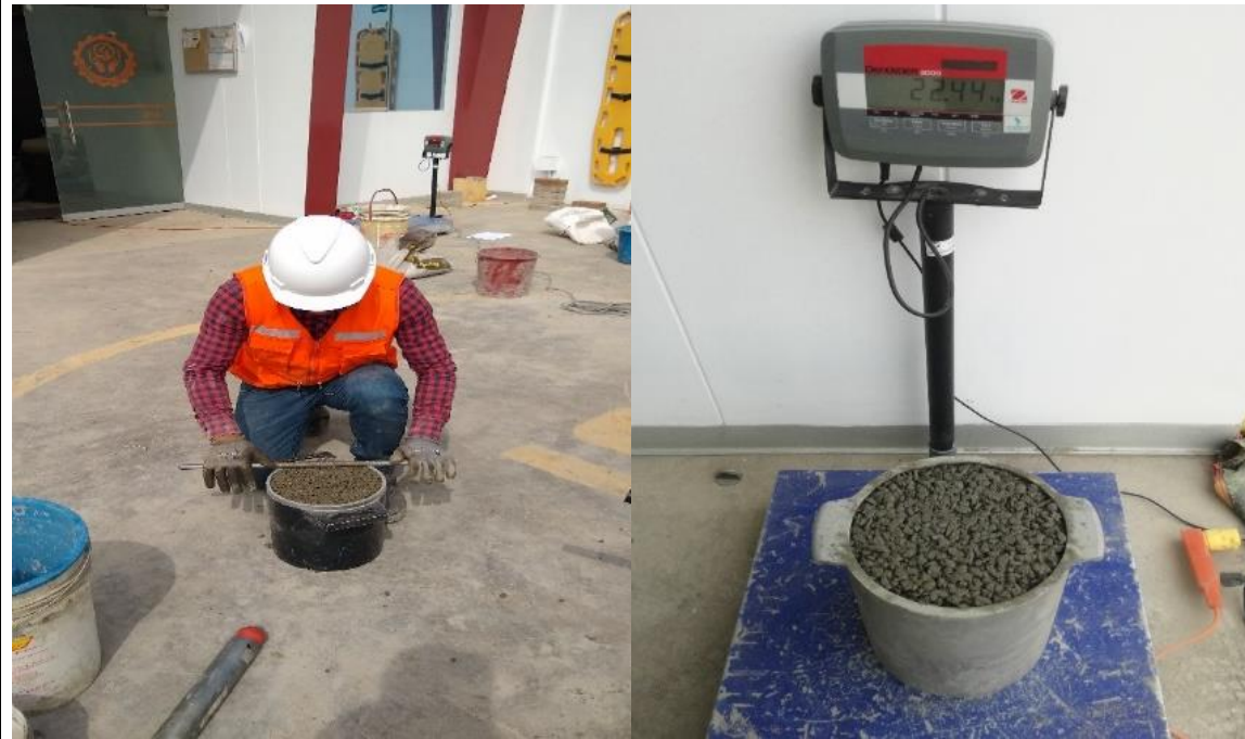
Fotografía N° 13. Realización de ensayo de peso unitario de concreto permeable.
