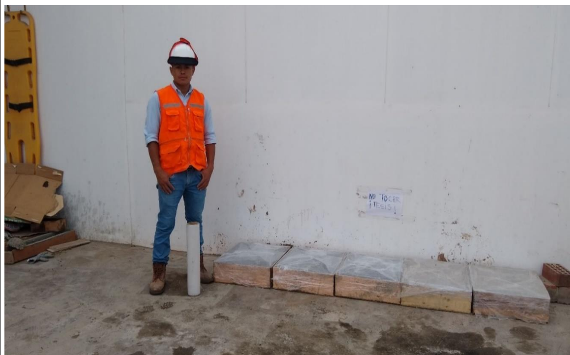
Fotografía N° 23. Curado inicial de viguetas cubriendo con film por 24 horas para luego pasar a cámara de curado.
