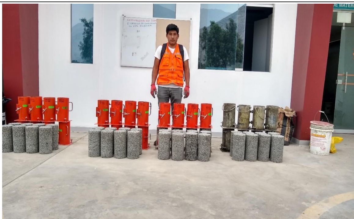
Fotografía N° 16. Especímenes desmoldados por grupos de adición de fibras PET para ingresar a curado.
