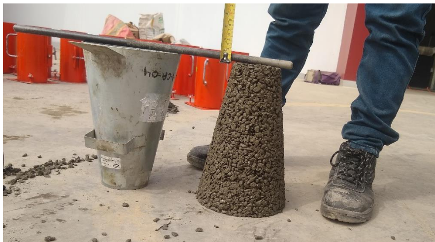
Figura 23. Ensayo de consistencia (slump) para medir asentamiento.
