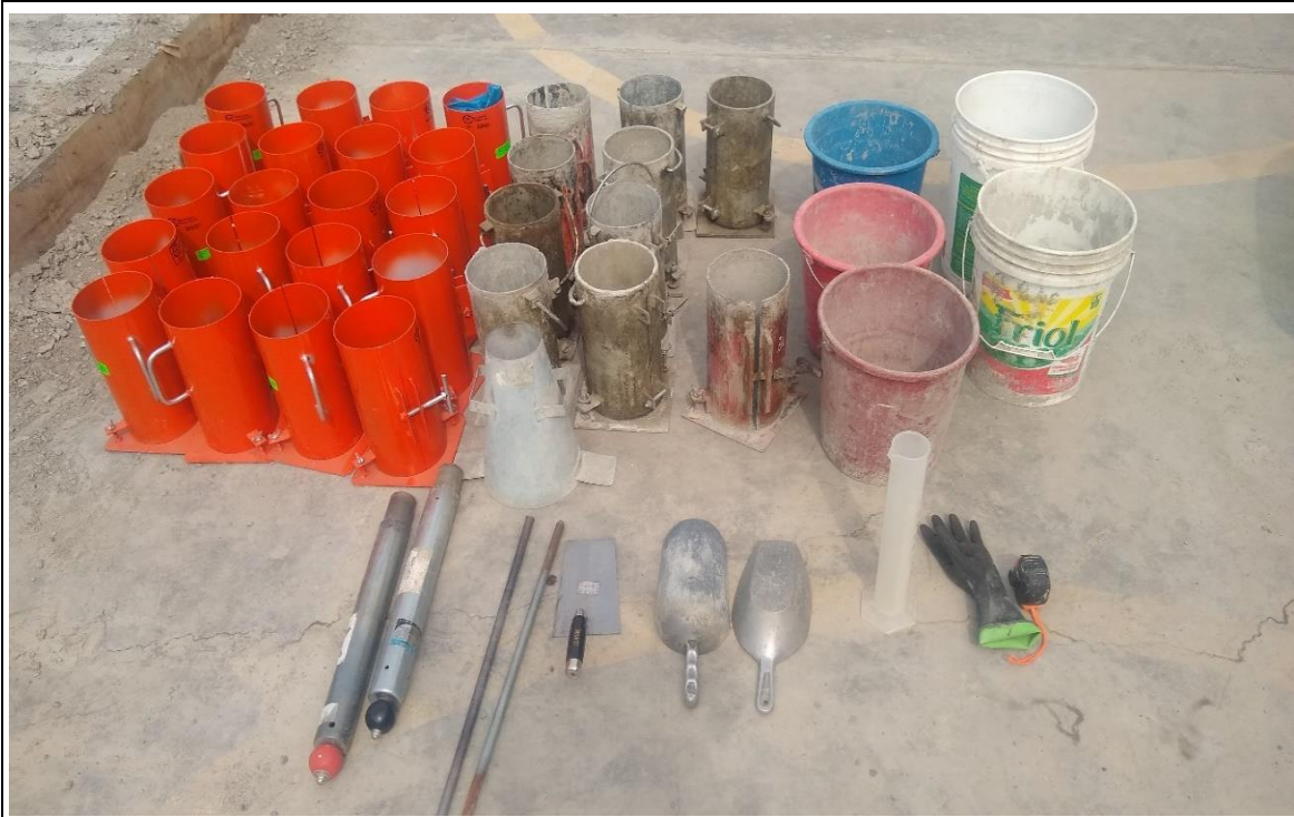
Fotografía N° 09. Materiales para elaboración de especímenes 15 x 30 cm de concreto permeable.
