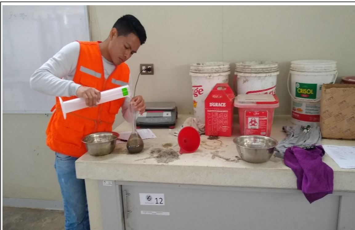
Fotografía N° 03. Llenando parcialmente al picnómetro con agua para eliminar las burbujas de aire visible.
