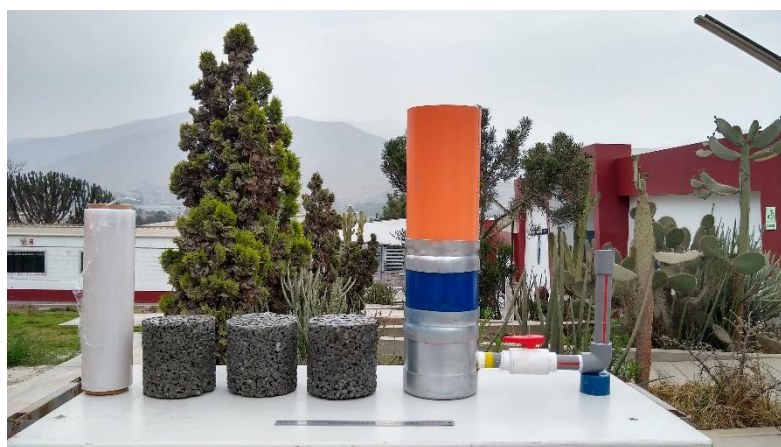
Figura 30. Ensayo de permeabilidad en un permeámetro de cabeza descendente.
