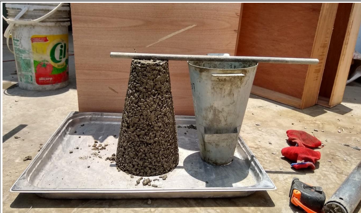
Fotografía N° 14. Ensayo de consistencia (slump) de concreto permeable en un cono de Abrams.
