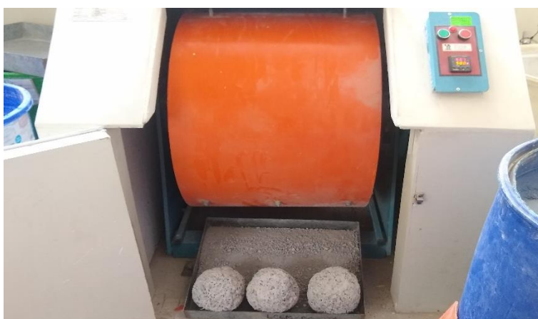
Figura 31. Ensayo de resistencia potencial a la degradación por impacto y abrasión en tambor de acero rotatorio.
