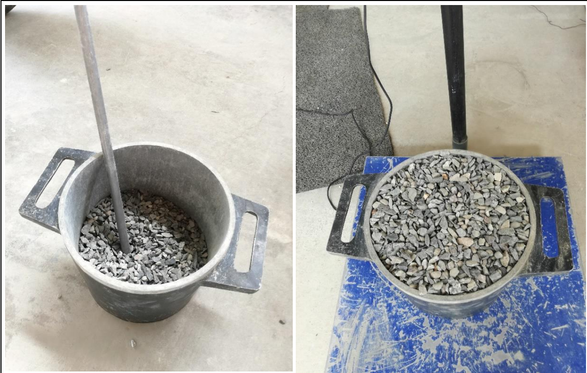
Fotografía N° 07. Ensayo de peso unitario de agregado grueso
