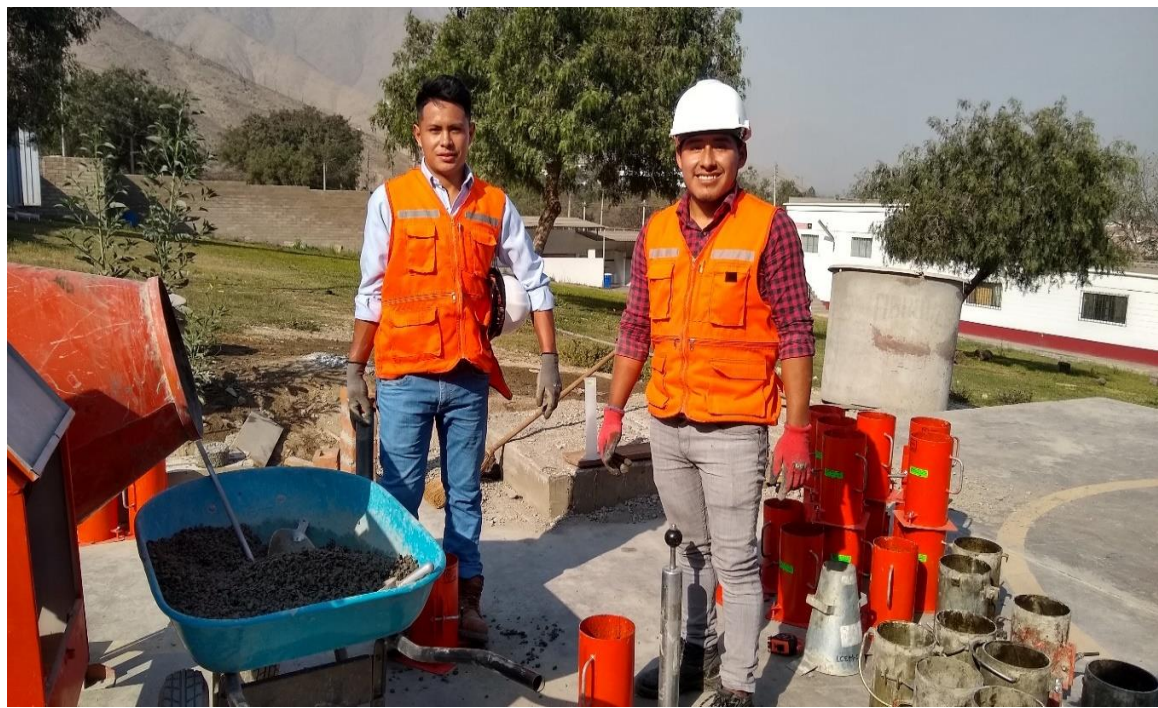
Fotografía N° 15. Elaboración de especímenes 15 x 30 cm, con compactación ligero usando martillo de proctor estandar
