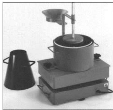
Figura 4. Consistómetro vebe descrito en ACI 211.3 (Escalaya, 2006).
