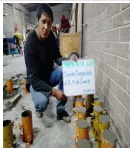
Grafico 18: Especimenes de concreto compactado con 5% de Cemento
