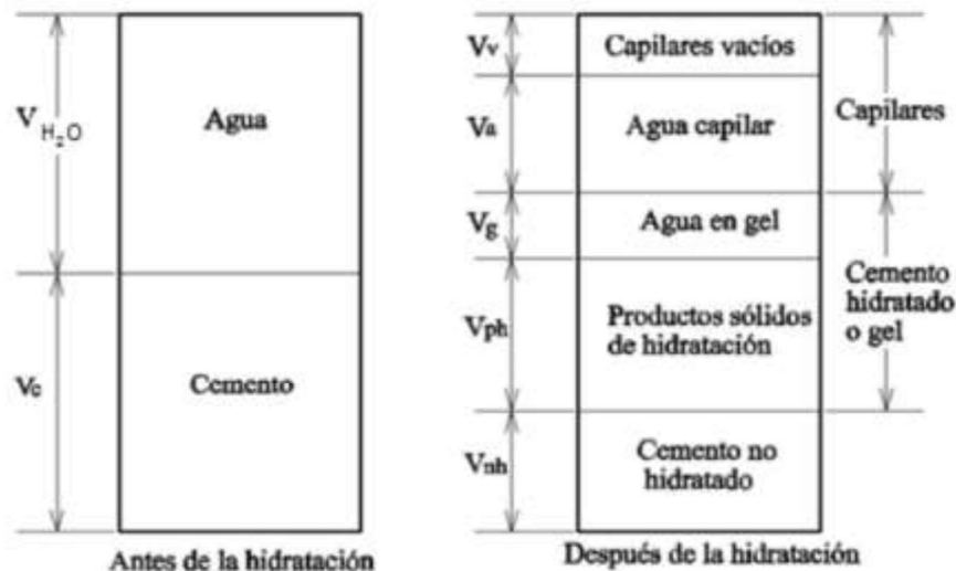
Figura 3. Representación esquemática de las proporciones volumétricas en la pasta de cemento antes y después de la hidratación. (Aguilar et al., 2009).
