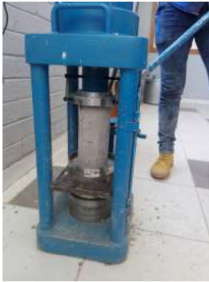
Grafico 25: Ensayo a la compresion uniaxial de especimenes
