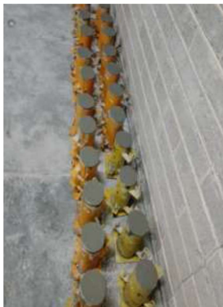
Grafico 14: Moldeo de Briquetas f_c=280\text{kg/cm}^2 .
