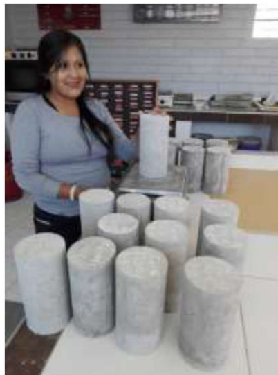
Grafico 24: Muestras antes de ser ensayas a resistencia a la compresion
