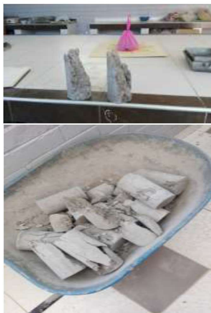
Grafico 26: Tipo de fractura de los cilindros de concreto
