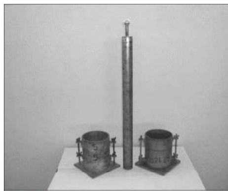
Figura 5. Equipo Para Ensayo ASTM D 1557 (Escalaya, 2006).
