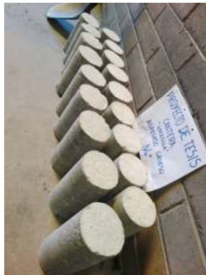
Grafico 22: Colocacion de especimenes a la intemperie para curado a aspersion.
