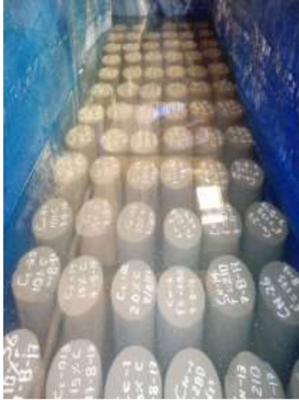
Grafico 21: Ensayo de absorcion en concretos compactados y convencionales
