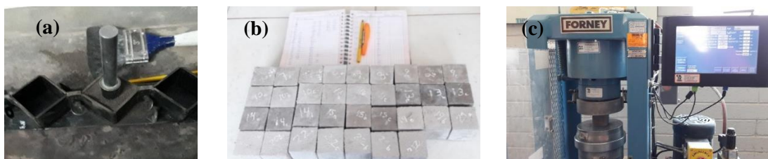
Figura 3. (a) Elaboración de dados , (b) Codificación y toma de datos , (c) rotura de especímenes cúbicos . Fuente: los autores.
