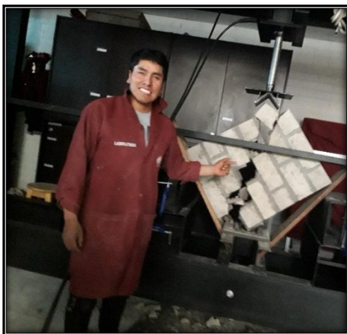
57) Falla tipo escalonado
