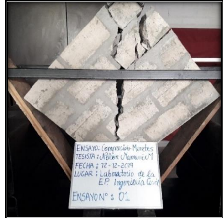
56) Falla por tracción diagonal
