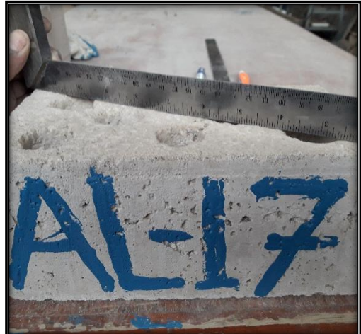
50) Toma de datos – Alabeo
