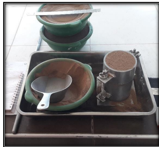
22) Ensayo de peso unitario - suelo
