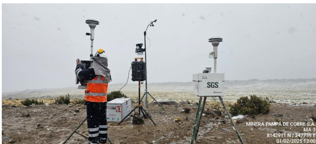
Figura 2 Instalación de Equipos y ubicación de los puntos designados de Monitoreo de Aire en la Minera Pampa de Cobre
