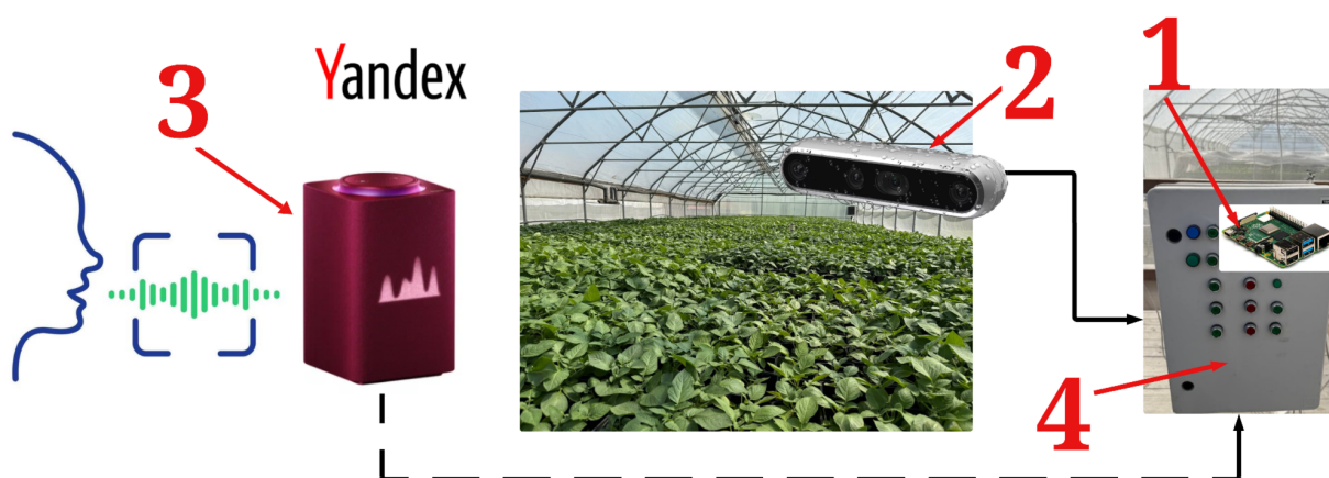
Fig. 2. Sistema de monitoreo visual automático y control por voz para gestión ambiental en invernadero.
