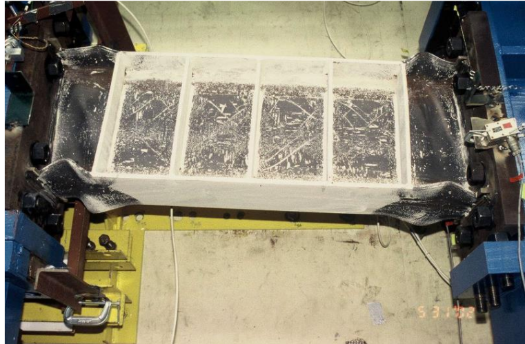
Figura 41: Falla de enlace intermedio (flexión y corte).
