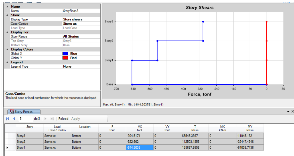
Figura 26: Cortantes por piso (ETABS).
