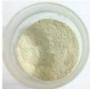
FIGURA N°1. Muestra de bagazo de naranja con cloruro de sodio.
