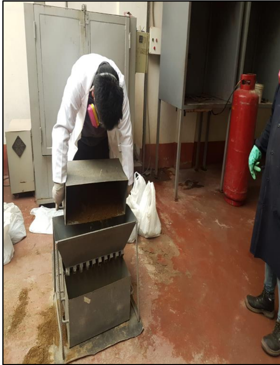
Fotografía 4. Cuarteador de muestra de suelo
