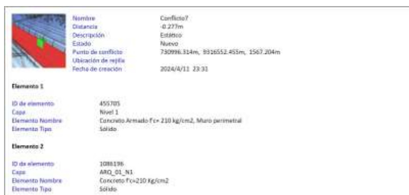
Figura 13. Interferencia generada por Navisworks, buzón colisiona con muro de contención.
