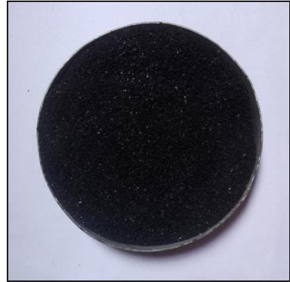
Figura 6. Filtro de Carbón activado
