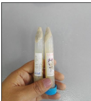
Figura 3. Obtención del sólido previamente centrifugado
