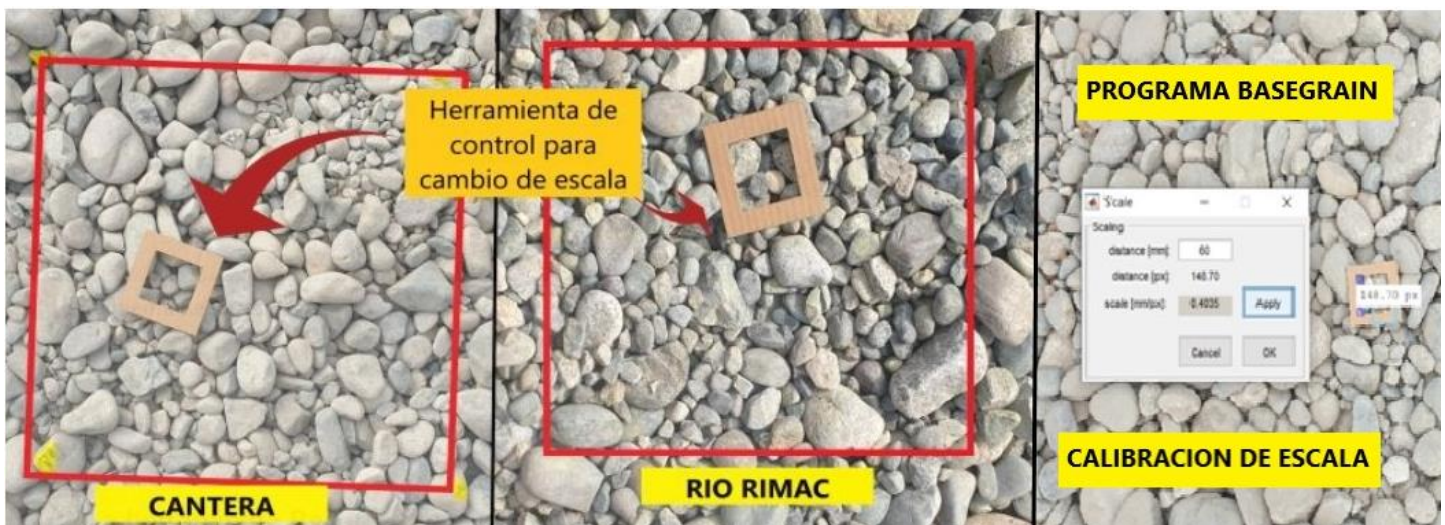
FIGURA 3: Herramienta de control para el cambio de escala usado para el programa BaseGrain como una calibración
