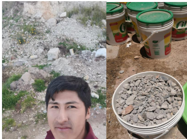
Figura 3. Trituración del concreto y balde de concreto reciclado
