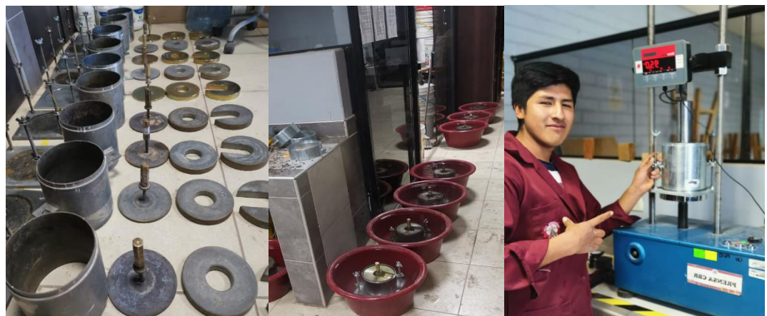
Figura 4. Moldes utilizados, saturación de los moldes y penetración de
