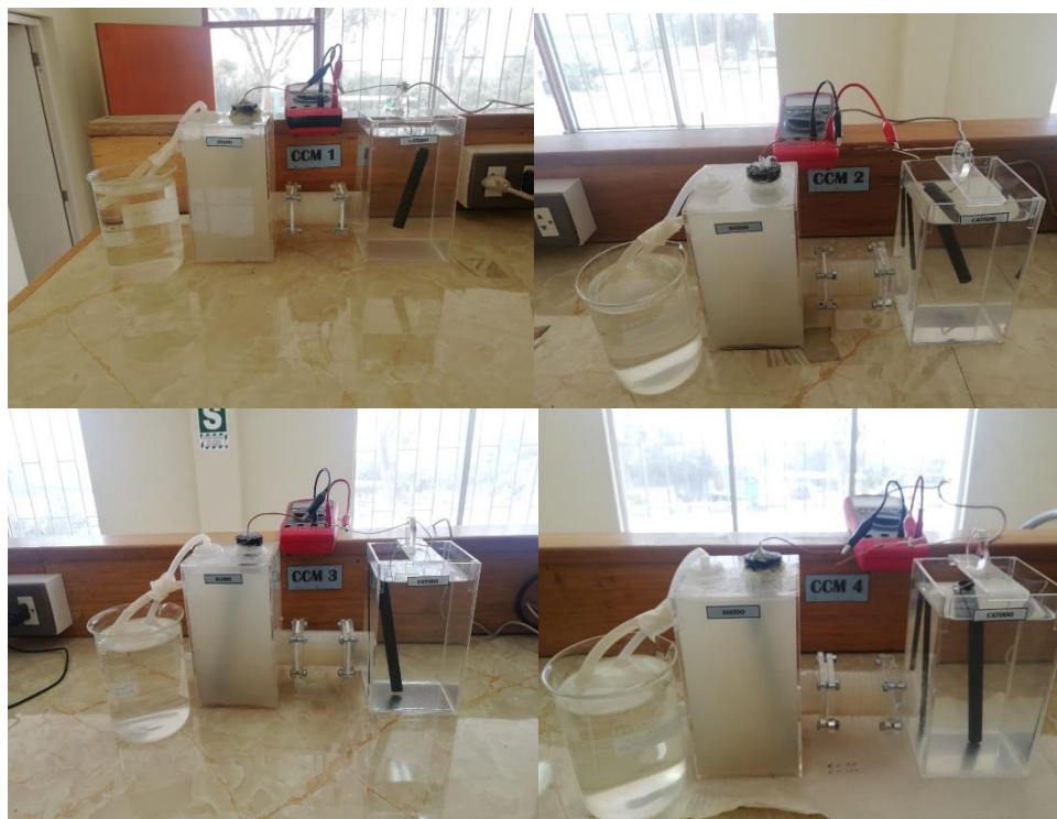
Figura 23. Puesta en marcha de las 4 celdas (CCM1, CCM2, CCM3 y CCM4)
