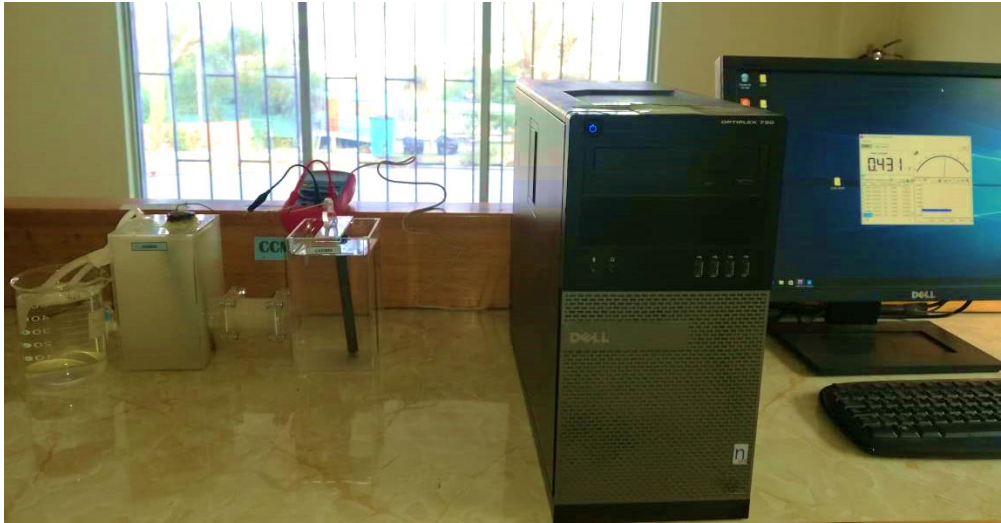
Figura 24. Configuración completa de la CCM para medir la bioelectricidad generada en términos de voltaje.
