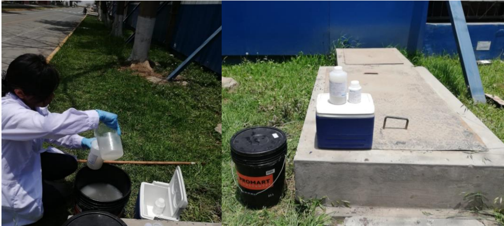
Figura 19. Toma de muestra de agua residual pre tratamiento
