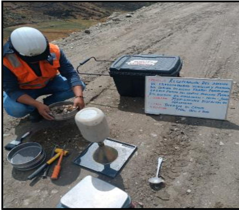
Figura N° 80 Vista del trabajo del profesional realizando la prueba de densidad de campo.
