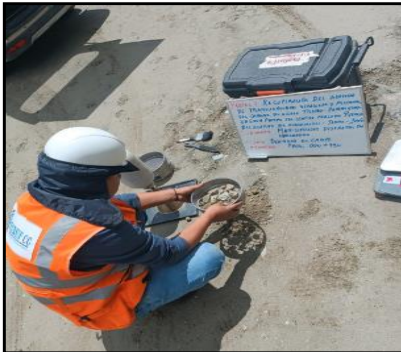
Figura N° 81 Vista del trabajo del profesional realizando la prueba de densidad de campo.
