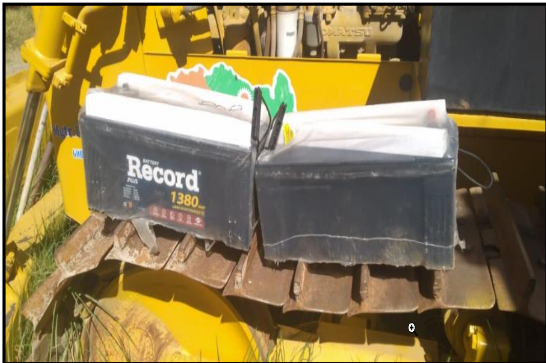
Figura N° 68 Vista del mantenimiento de tractor oruga, baterías.
