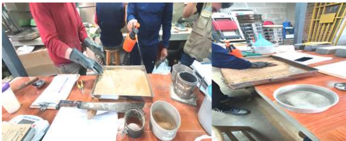
Figura 1. Mezclado de aditivo Consolid 444 y Con-Aid con suelo arcilloso. Fuente: los autores
