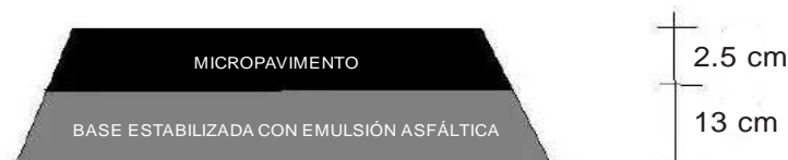
Figura 3. Espesores Obtenidos de la Estructura de Micropavimento y Full Depth (Base Estabilizada con Emulsión Asfáltica CSS-1h de rotura lenta)
