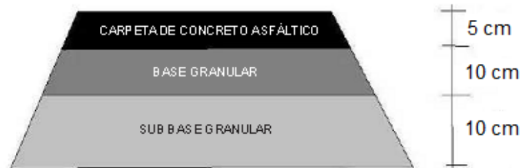
Figura 5. Espesores Obtenidos de la Estructura de Pavimento de Concreto Asfáltico
