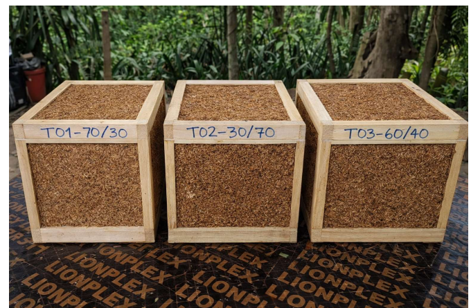
Figura 4. Paneles acústicos (T1, T2 y T3)
