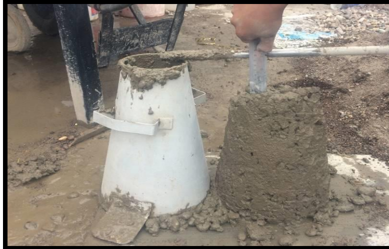
Figura 14. Asentamiento del concreto patrón de 3”
