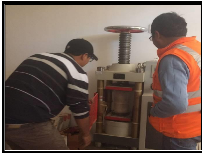
Figura 19. Máquina para el ensayo a compresión del concreto
