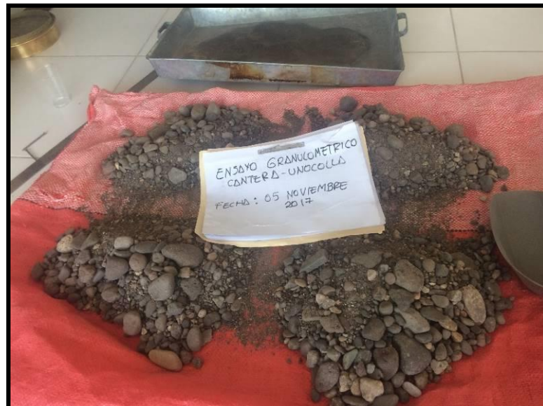
Figura 4. Proceso de cuarteado de agregado grueso
