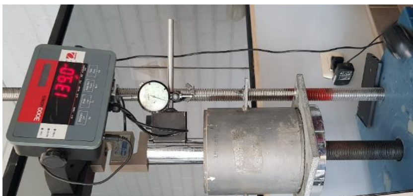
Figura 26: realización de penetración
