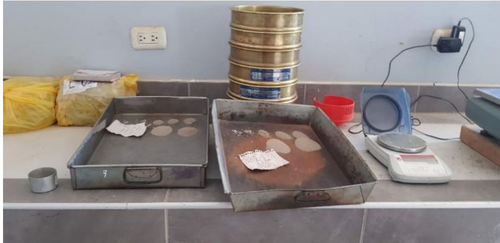
Figura 21: Muestra tamizado después de lavado y secado en horno Calicata N°01 y N02
