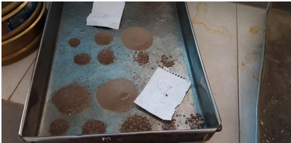
Figura 22: Muestra tamizado después de lavado y secado en horno Calicata N°01 y N02
