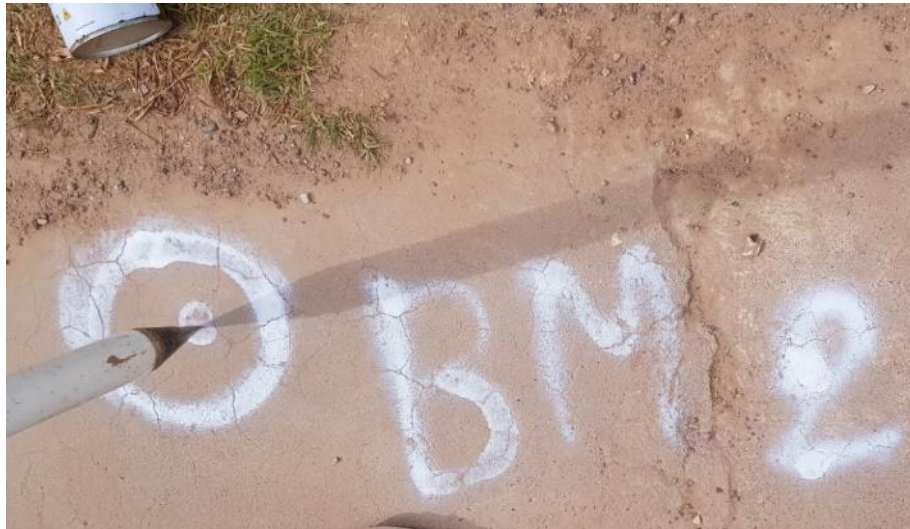
Figura 15: Punto de referencia BMs. 2 Fuente: Elaboración propia
