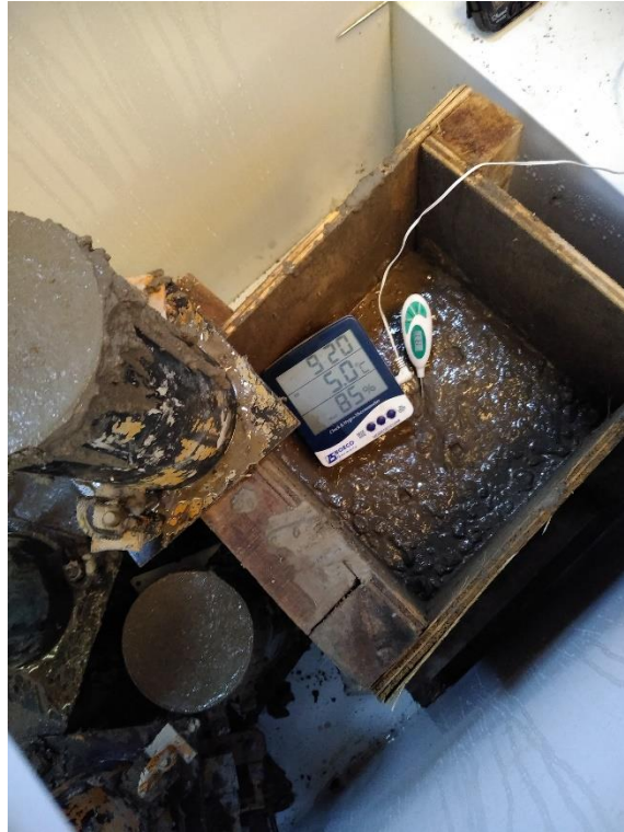
Fotografia 25. Control de la temperatura del concreto a 5°C para determinar el calor de hidratacion en cubos de (25cmx25cmx25cm).
