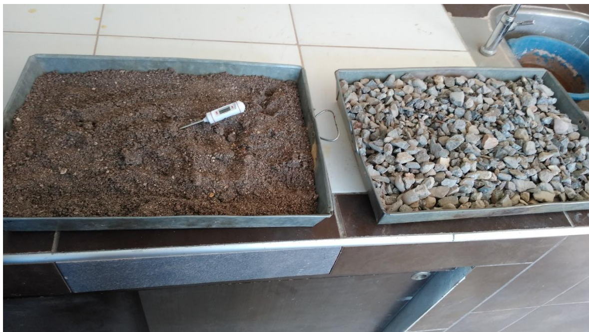
Fotografía 5. Selección y pesado de agregado fino y agregado grueso para su posterior secado en el horno.
