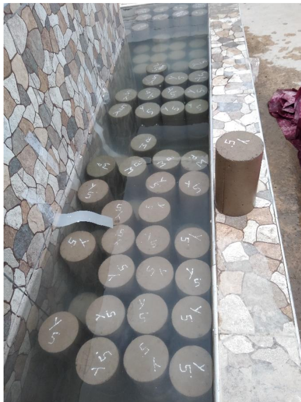
Fotografía 28. Curado de especímenes en la poza (patio del laboratorio de concreto y ensayo de materiales- UPeU)
