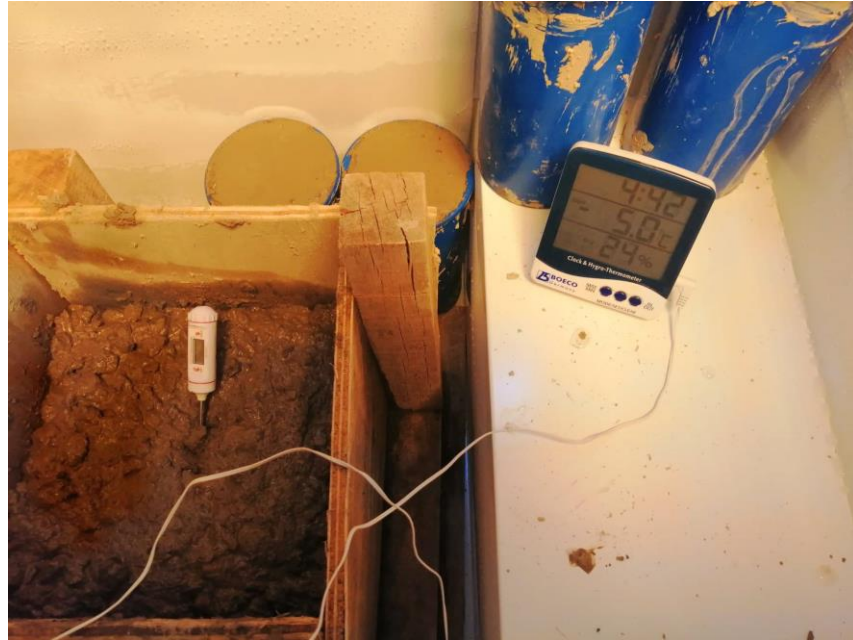
Fotografía 27. Especímenes colocados en la congeladora para ser sometidos a temperaturas de 5°C durante el fraguado inicial y control de la temperatura del concreto (25cm x25cmx25cm)
