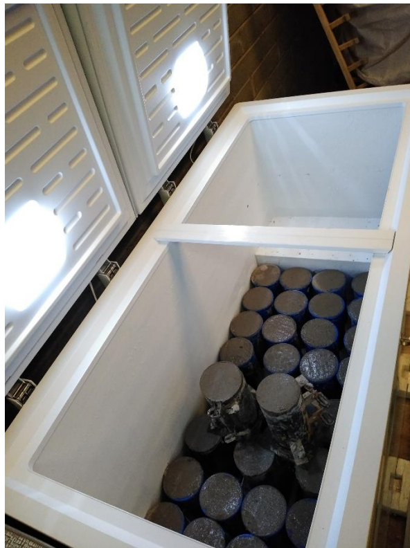
Fotografía 24. Especímenes colocados en la congeladora para ser sometidos a temperaturas de -5°C y 5°C durante el fraguado inicial.
