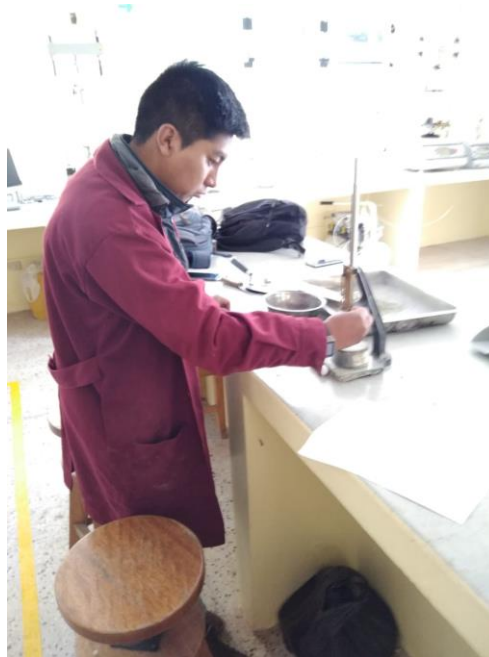
Fotografia 17. Ensayos a cada 15 minutos para ver el desarrollo del fraguado del cemento con el aparato de Vicat.
