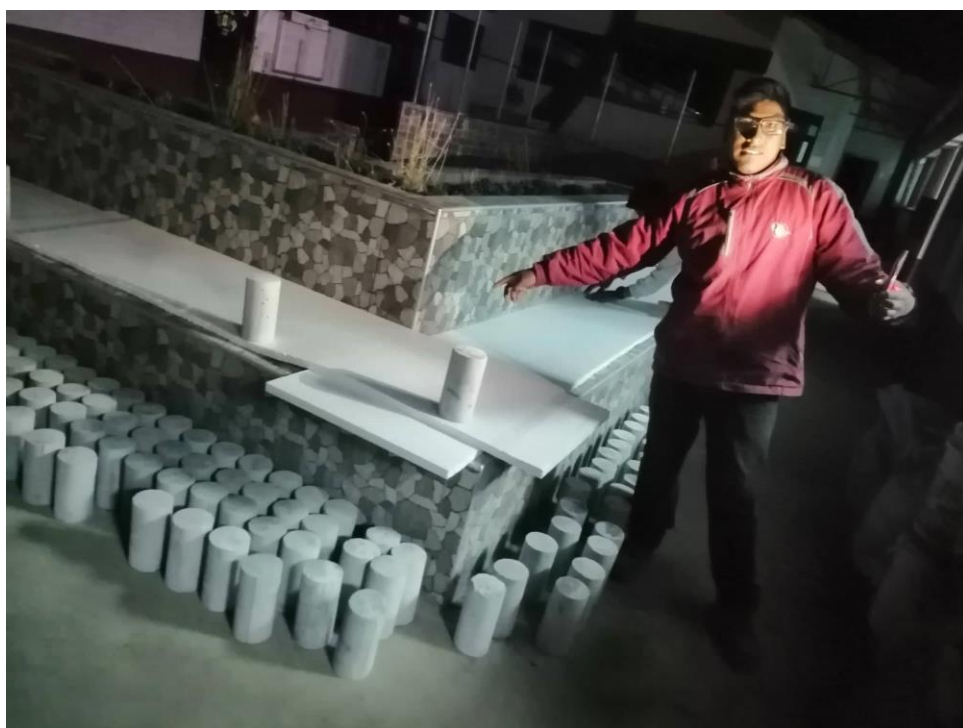
Fotografia 30. Control de la temperatura ambiente de la poza durante la noche, para controlar la temperatura del agua con polietileno.
