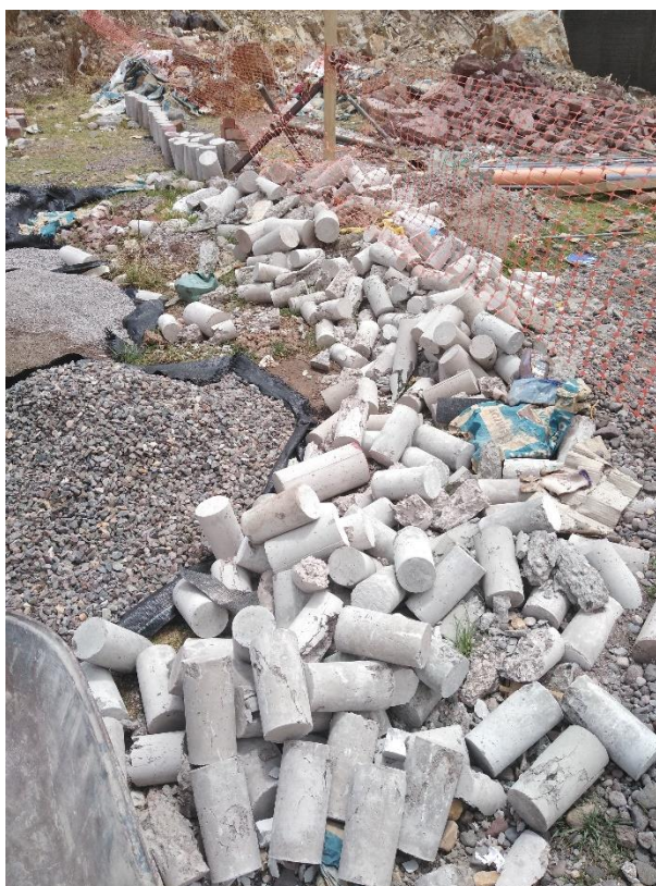
Fotografía 40. Probetas ensayas a compresión durante el Proyecto de tesis que constan de concretos dosificado con cemento Rumi IP, Yura IP, Frontera IP y Wari I.
