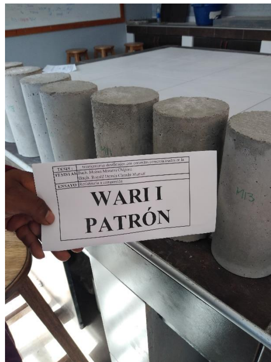
Fotografia 36. Testigos de concreto dosificado con cemento Wari I concreto patrón para el ensayo de resistencia a compresión.
