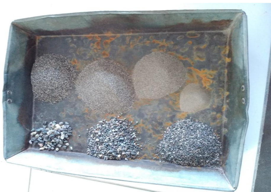
Fotografía 8. Granulometría del agregado fino y grueso e identificación de los diámetros de muestras.
