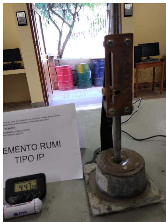
Fotografia 14. Ensayo de consistencia del cemento Rumi IP para su posterior ensayo del fraguado inicial del cemento.
