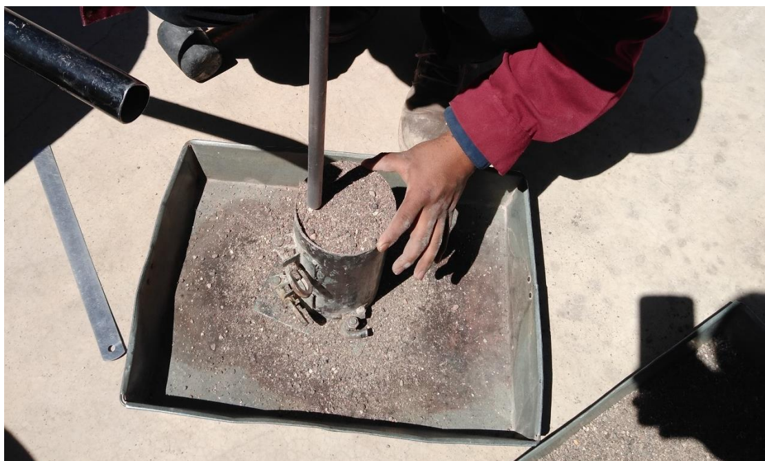
Fotografía 6. Ensayo del peso unitario compactado del agregado fino en moldes de 10 cm x 20 cm.
