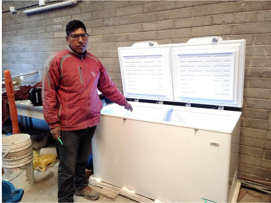
Fotografía 23. Congeladora MABE para someter los especímenes y los cubos de concreto (25cmx25cmx25cm) a temperaturas de 5°C y -5°C.
