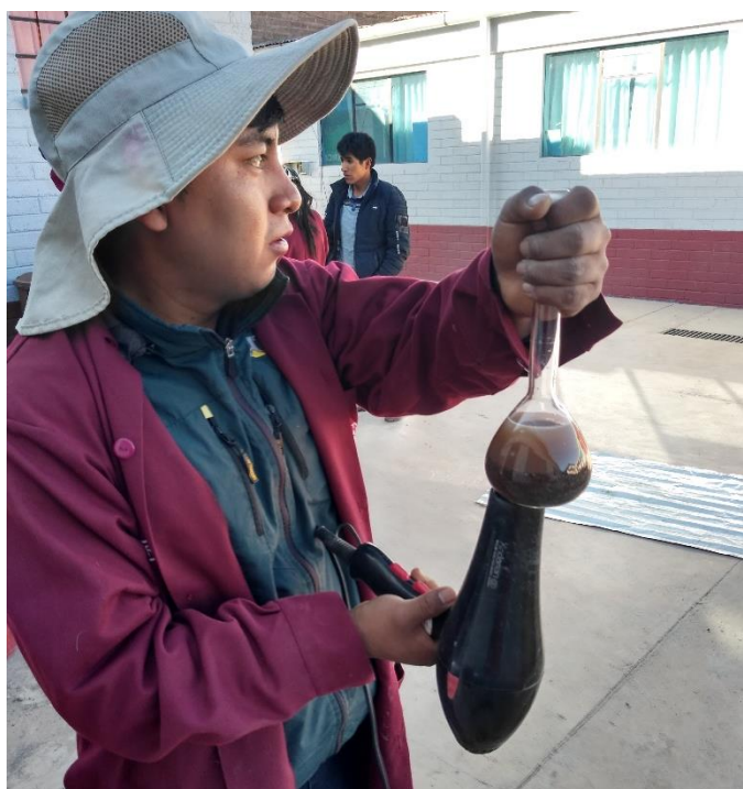
Fotografia 9. Ensayo del peso especifico del agregado fino en fiola de 250 gr.
