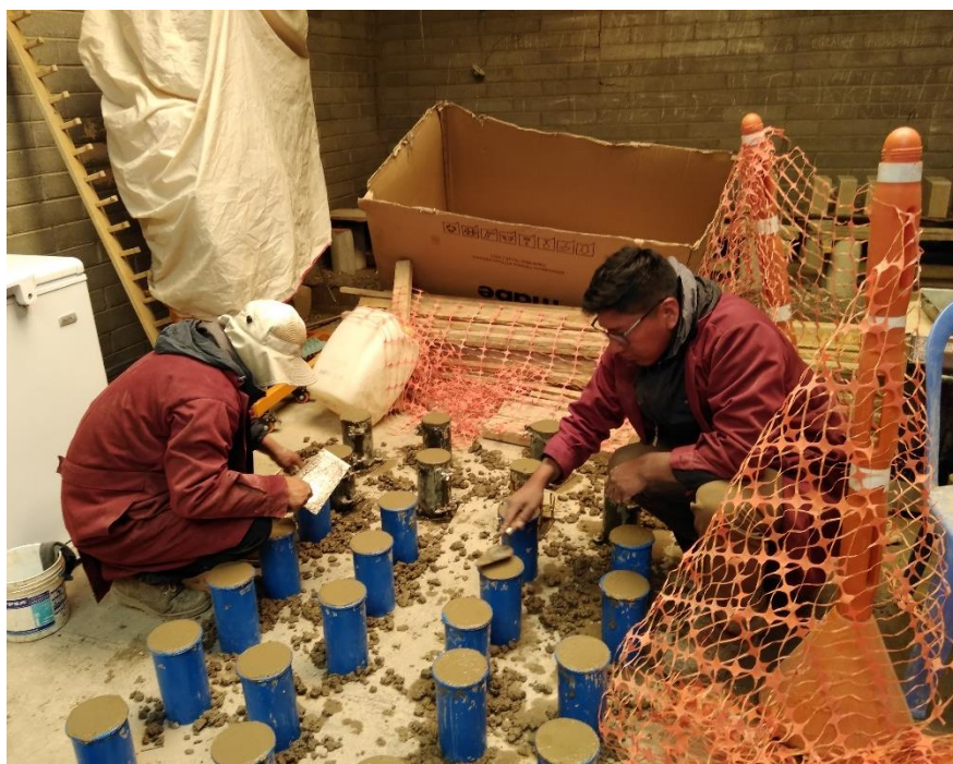
Fotografía 22. Elaboración de especímenes en moldes de 10 cm x 20 cm.
