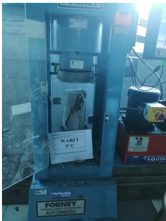
Fotografia 37. Rotura de probeta del concreto dosificado con cemento Wari tipo I a una temperatura 5 °C y edad de 28 días.
