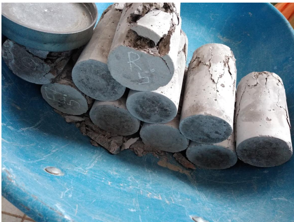
Fotografia 38. Probetas de concreto ya ensayadas a compresión.
