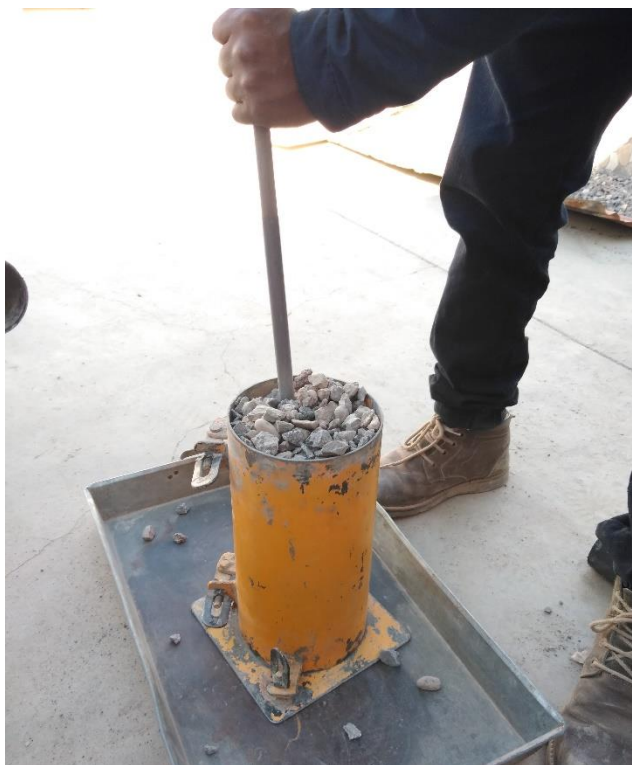
Fotografía 7. Ensayo del peso unitario compactado del agregado grueso en moldes de 15 cm x 30 cm.
