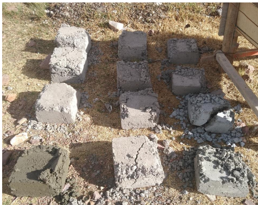
Fotografía 39. Muestras de concreto donde se realizaron los controles para obtener el calor de hidratación del concreto (cubos de 25cmx25x25cm)
