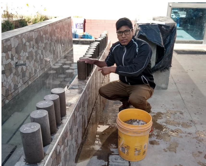
Fotografia 31. Testigos de concreto despues de extraer de la poza para el secado y posteriormente ser ensayados.
