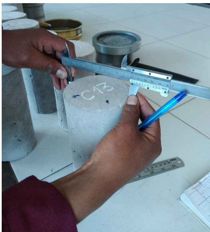
Fotografia 32. Realizando las respectivas mediciones de diámetros y alturas de las muestras listos para ser ensayados en la prensa digital automática.
