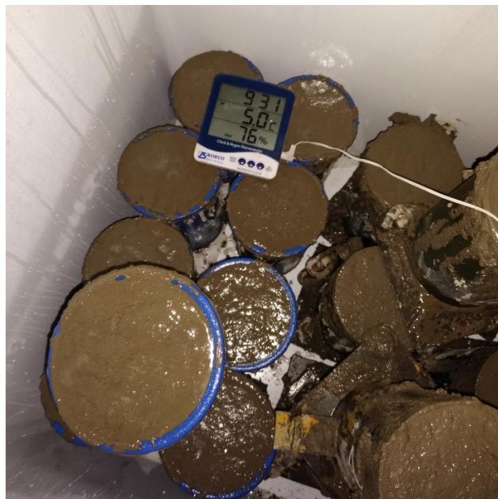
Fotografia 26. Especímenes colocados en la congeladora para ser sometidos a temperaturas de 5°C durante el fraguado inicial.
