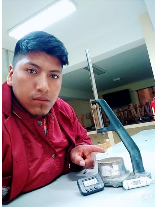
Fotografia 15. Instrumentos necesarios para controlar el fraguado inicial con el Aparato de Vicat (termómetro, cronometro).
