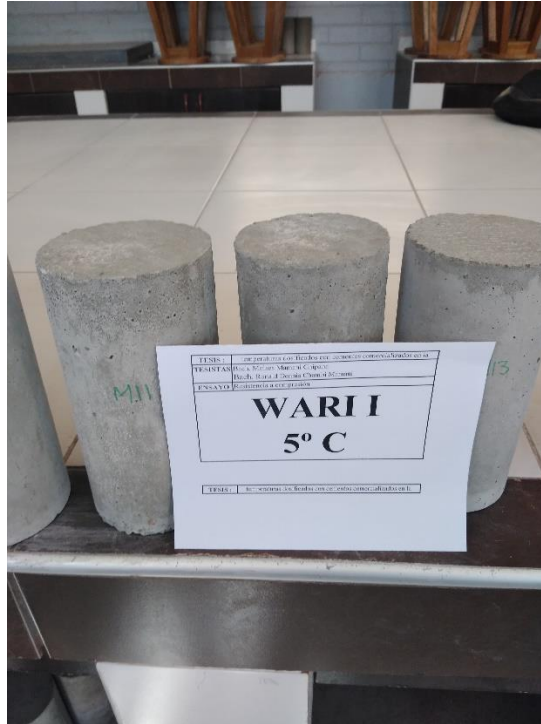
Fotografia 35. Testigos de concreto dosificado con cemento Wari I a una temperatura de 5°C para el ensayo de resistencia a compresión.
