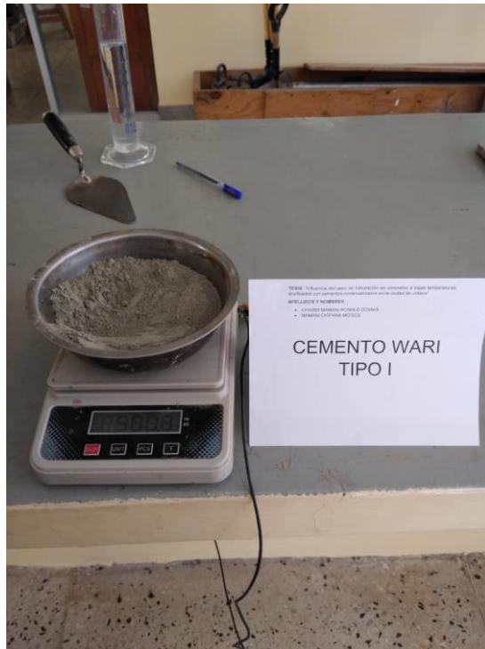
Fotografia 13. Peso del cemento Wari tipo I para el ensayo del fraguado inicial realizado en los laboratorios de la Universidad Andina del Cusco.
