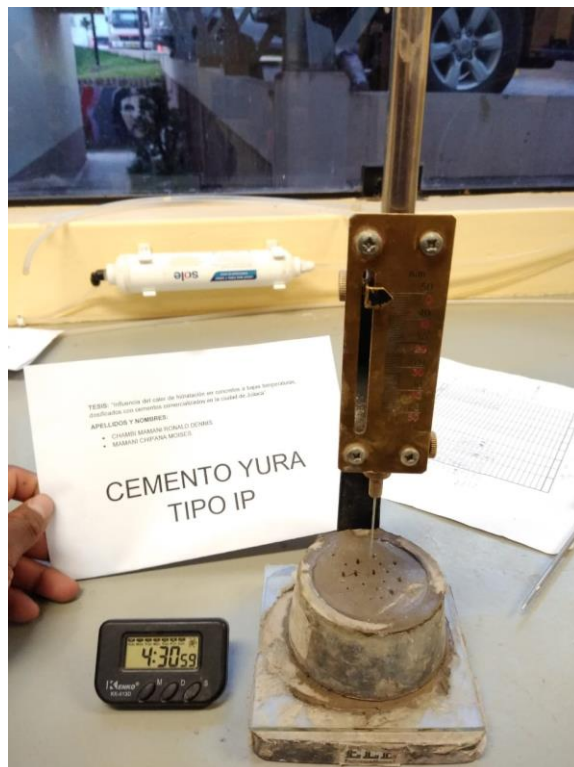
Fotografia 16. Fin del fraguado inicial del cemento Yura IP al tiempo mostrado en el cronometro.
