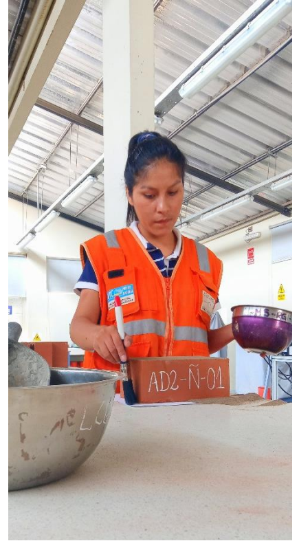
Figura 71. Ensayo de porcentaje de vacíos de los ladrillos ÑOÑO - parte 1.
