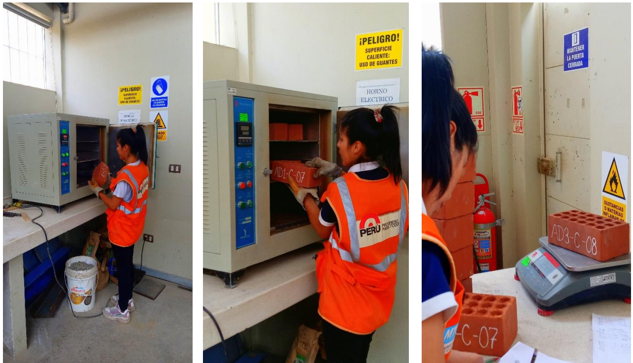
Figura 87. Ensayo de absorción de los ladrillos CERANDES –Parte 1.
