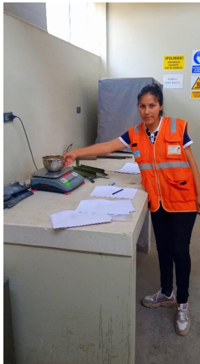
Figura 72. Ensayo de porcentaje de vacíos de los ladrillos ÑOÑO - Parte 2.
