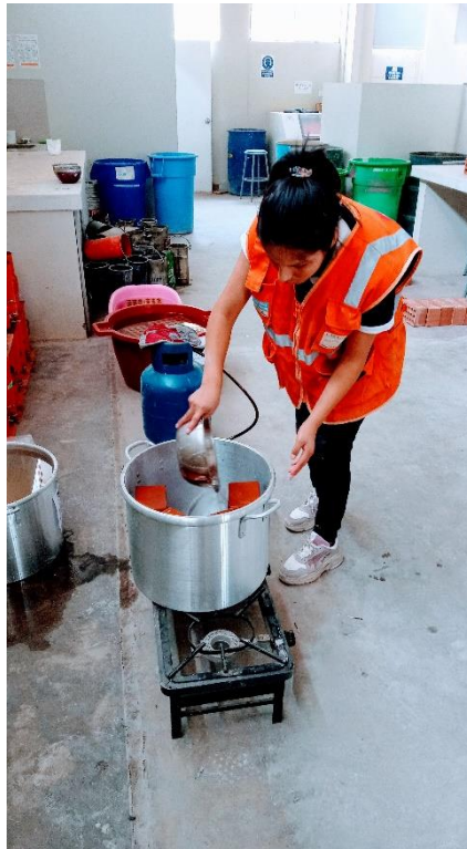
Figura 89. Ensayo de absorción máxima de los ladrillos CERANDES – Parte 1.
