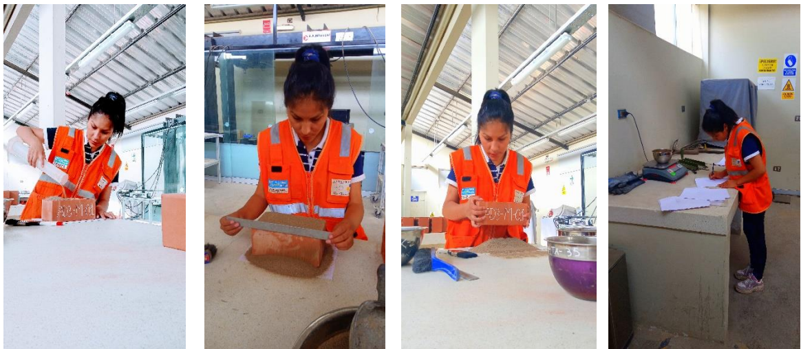
Figura 27. Ensayo de porcentaje de vacíos. Fuente: Elaboración propia.
