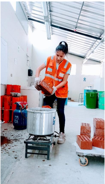
Figura 102. Ensayo de absorción máxima de los ladrillos MVF – Parte 2.
