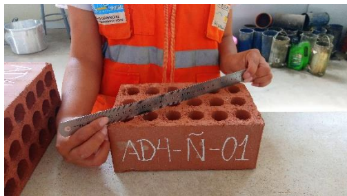
Figura 26. Ensayo de alabeo. Fuente: Elaboración propia.
