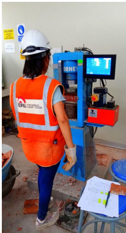
Figura 80. Ensayo de Resistencia a la Compresión de los ladrillos ÑOÑO – Parte 2.
