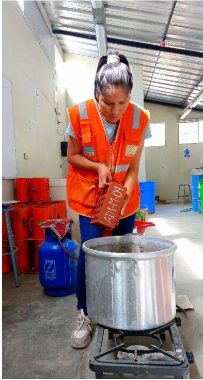
Figura 101. Ensayo de absorción máxima de los ladrillos MVF – Parte 1.
