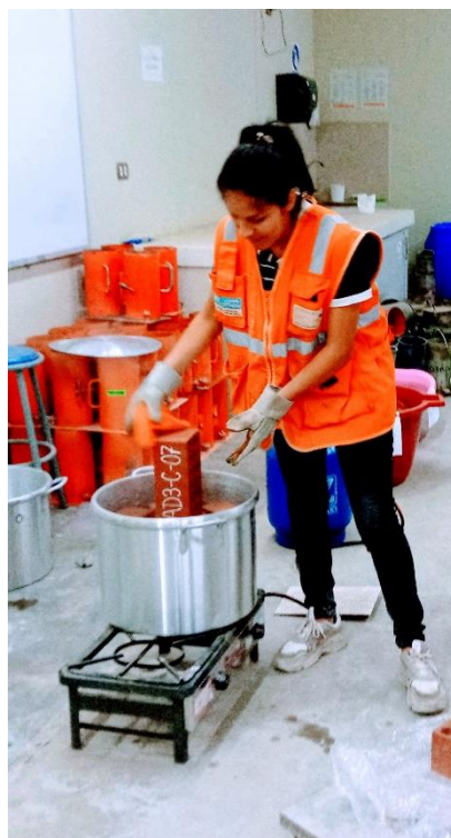
Figura 90. Ensayo de absorción máxima de los ladrillos CERANDES – Parte 2.
