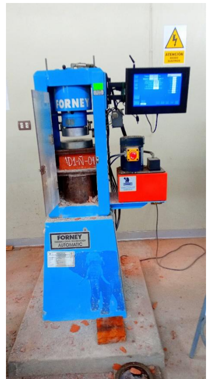
Figura 80. Ensayo de Resistencia a la Compresión de los ladrillos ÑOÑO – Parte 2.
