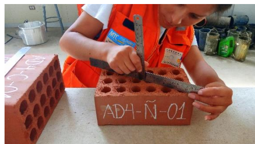
Figura 26. Ensayo de alabeo. Fuente: Elaboración propia.
