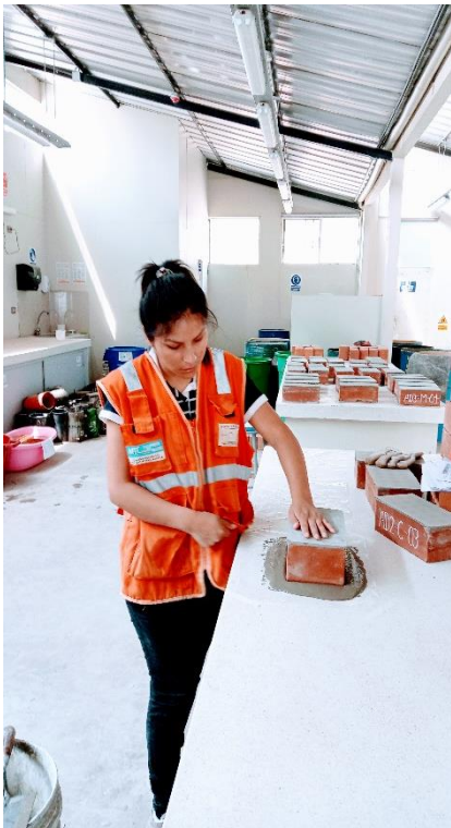
Figura 80. Ensayo de Resistencia a la Compresión de los ladrillos ÑOÑO – Parte 2.
