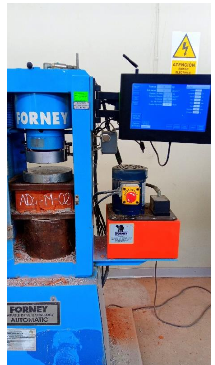
Figura 104. Ensayo de resistencia de materiales de los ladrillos MVF – Parte 2.
