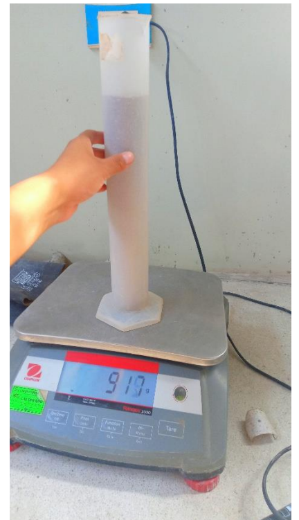
Figura 72. Ensayo de porcentaje de vacíos de los ladrillos ÑOÑO - Parte 2.
