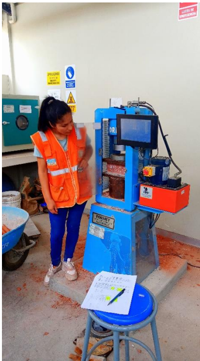
Figura 92. Ensayo de resistencia a la compresión de los ladrillos CERANDES – Parte 2.
