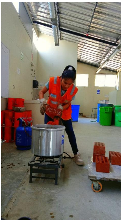
Figura 102. Ensayo de absorción máxima de los ladrillos MVF – Parte 2.
