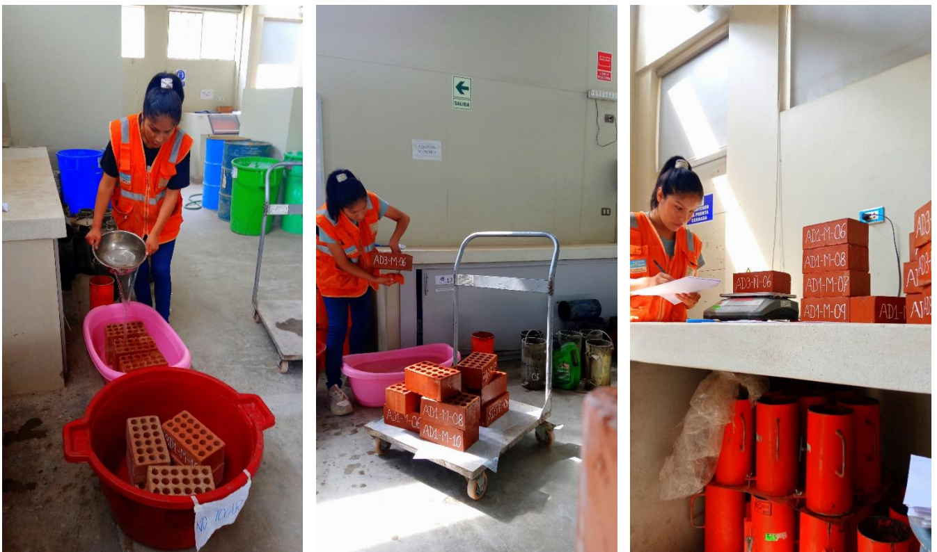
Figura 100. Ensayo de absorción de los ladrillos MVF – Parte 2.
