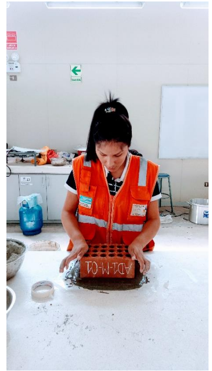
Figura 103. Ensayo de resistencia a la compresión de los ladrillos MVF – Parte 1.
