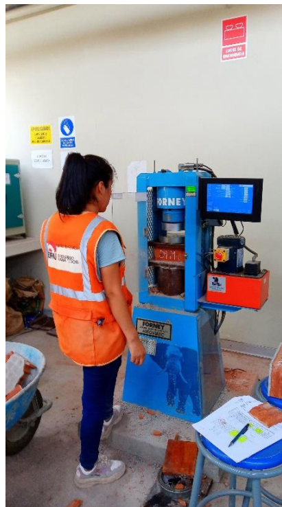
Figura 104. Ensayo de resistencia de materiales de los ladrillos MVF – Parte 2.
