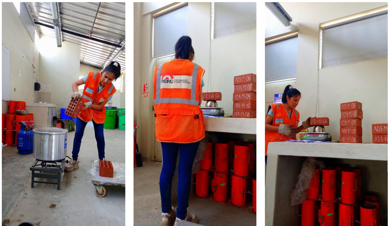
Figura 78. Ensayo de absorción máxima de los ladrillos ÑOÑO – Parte 2.
