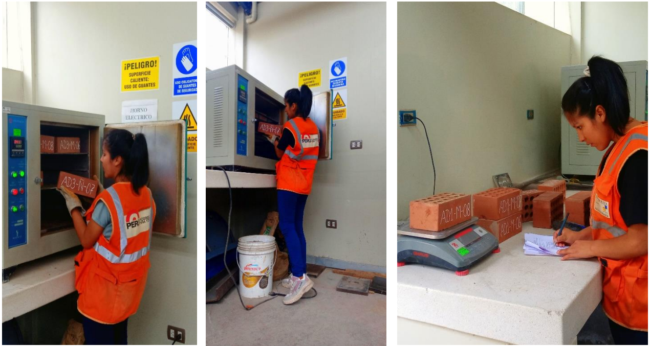
Figura 75. Ensayo de absorción de los ladrillos ÑOÑO – Parte 1.
