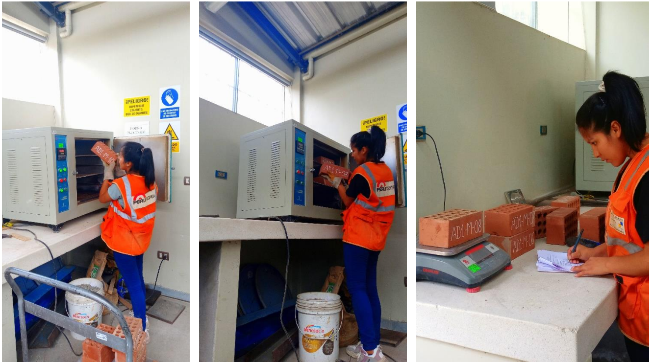
Figura 99. Ensayo de absorción de los ladrillos MVF – Parte 1.
