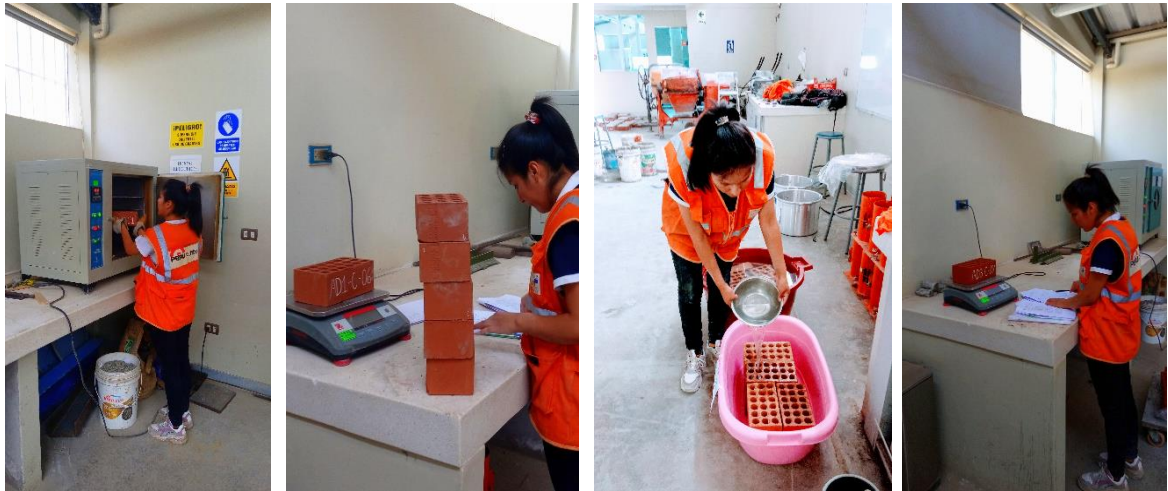
Figura 28. Ensayo de absorción. Fuente: Elaboración propia.
