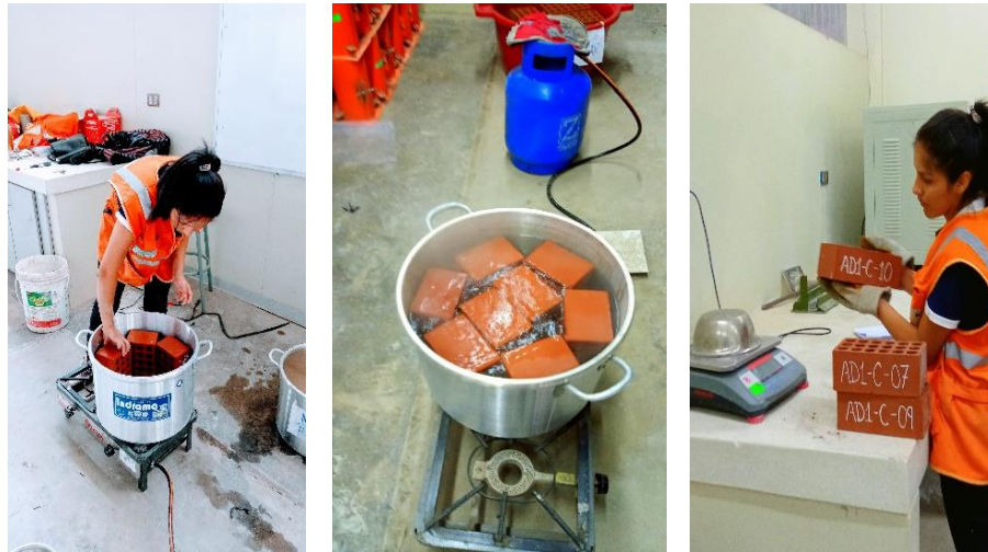
Figura 29. Ensayo de absorción máxima. Fuente: Elaboración propia.
