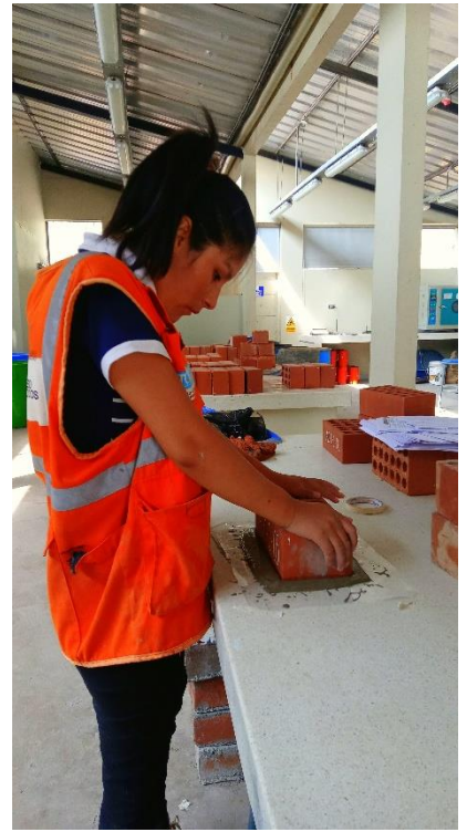
Figura 79. Ensayo de Resistencia a la Compresión de los ladrillos ÑOÑO – Parte 1.
