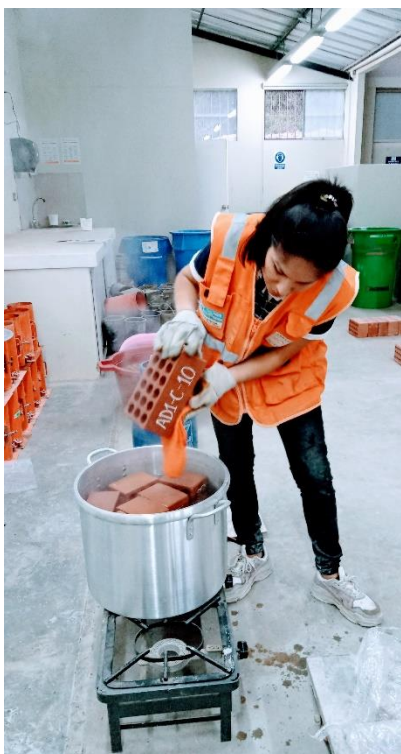
Figura 90. Ensayo de absorción máxima de los ladrillos CERANDES – Parte 2.
