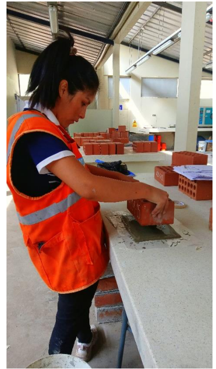
Figura 91. Ensayo de resistencia a la compresión de los ladrillos CERANDES – Parte 1.
