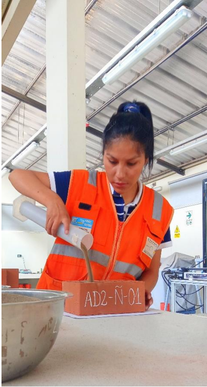
Figura 71. Ensayo de porcentaje de vacíos de los ladrillos ÑOÑO - parte 1.
