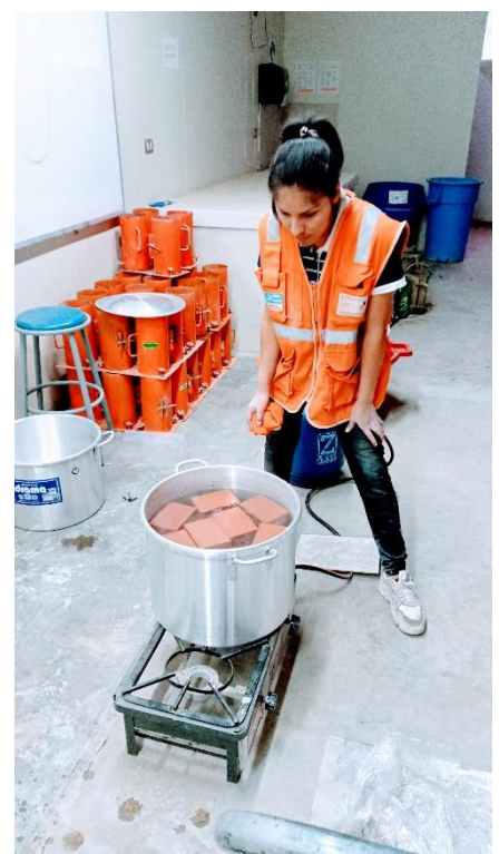
Figura 89. Ensayo de absorción máxima de los ladrillos CERANDES – Parte 1.
