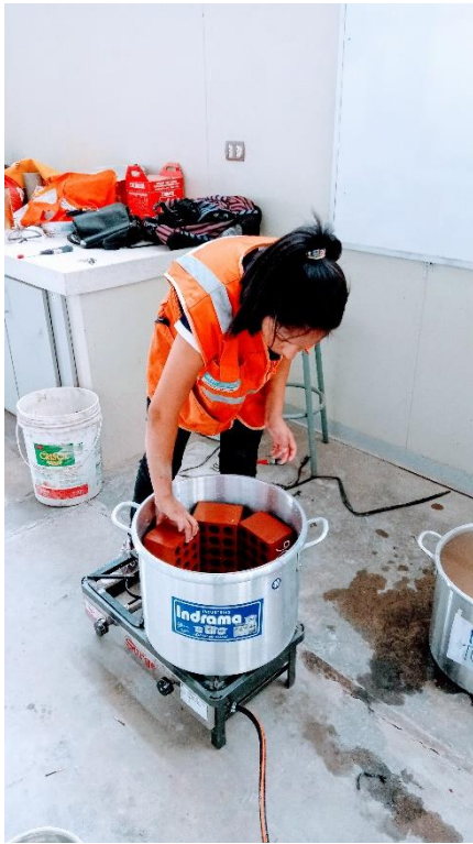
Figura 89. Ensayo de absorción máxima de los ladrillos CERANDES – Parte 1.
