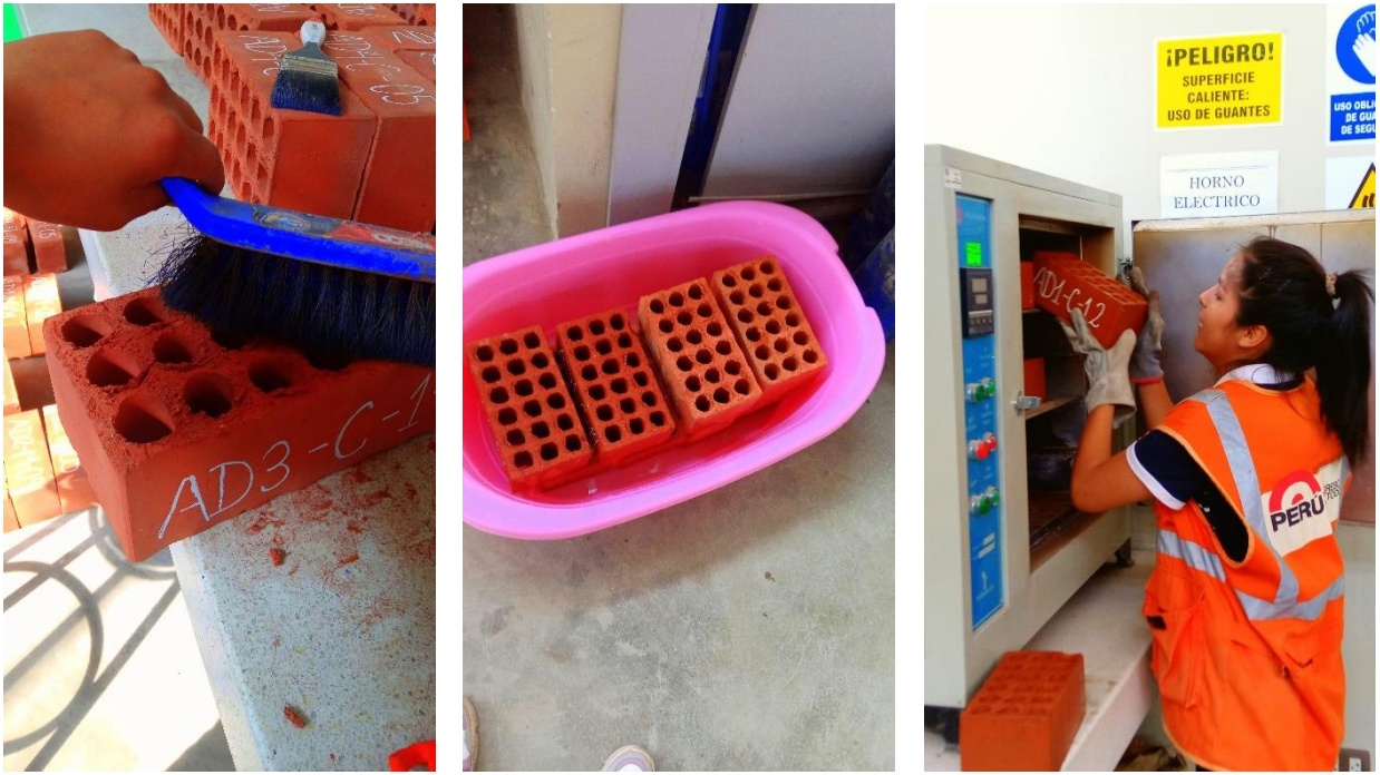
Figura 85. Ensayo de eflorescencia de los ladrillos CERANDES.
