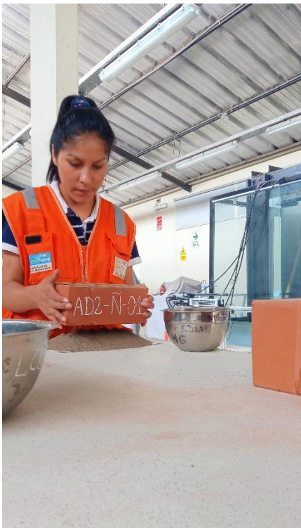
Figura 72. Ensayo de porcentaje de vacíos de los ladrillos ÑOÑO - Parte 2.
