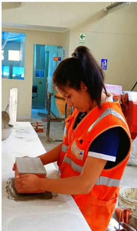
Figura 104. Ensayo de resistencia de materiales de los ladrillos MVF – Parte 2.
