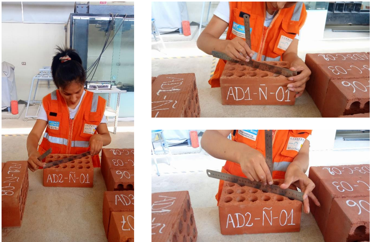
Figura 70. Ensayo de alabeo de los ladrillos ÑOÑO.
