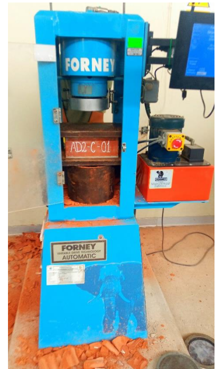
Figura 92. Ensayo de resistencia a la compresión de los ladrillos CERANDES – Parte 2.
