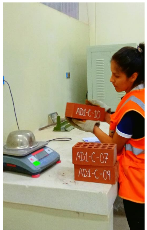
Figura 90. Ensayo de absorción máxima de los ladrillos CERANDES – Parte 2.
