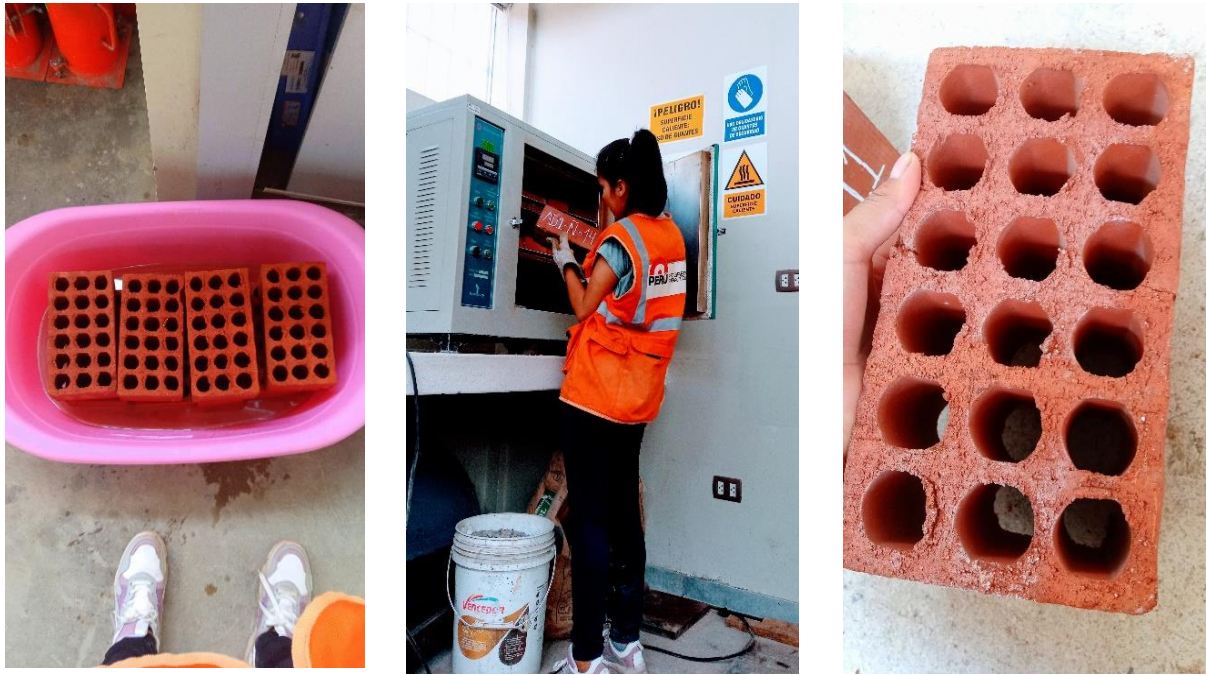
Figura 73. Ensayo de eflorescencia de la ladrillera ÑOÑO
