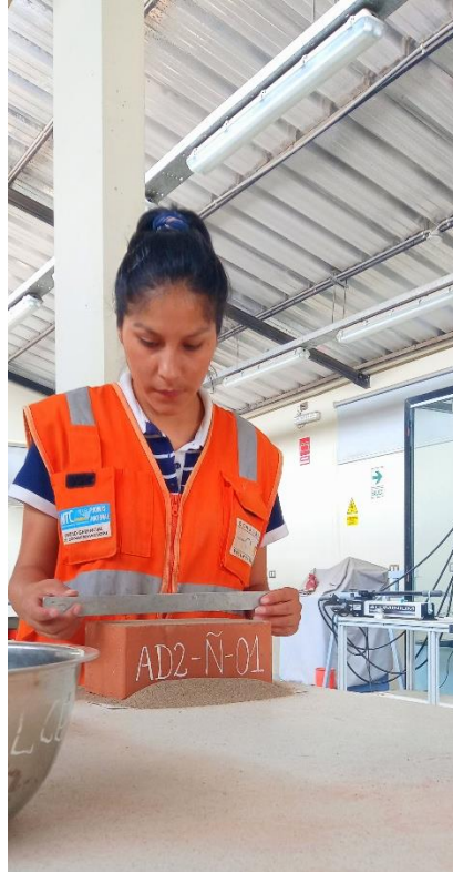
Figura 71. Ensayo de porcentaje de vacíos de los ladrillos ÑOÑO - parte 1.
