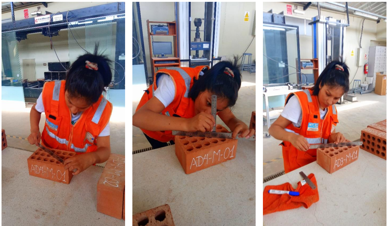
Figura 94. Ensayo de alabeo de los ladrillos MVF.
