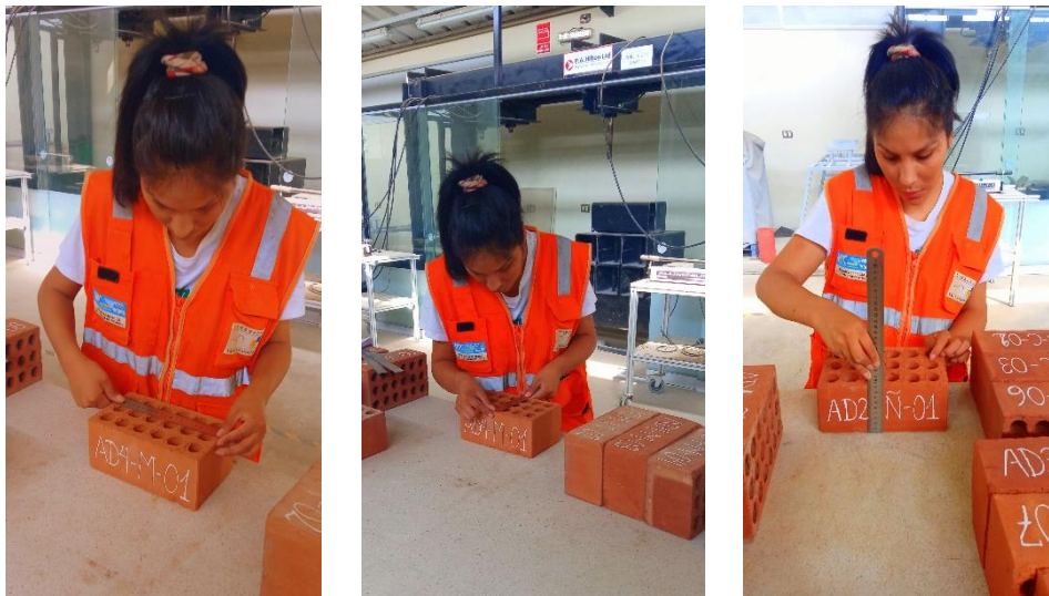
Figura 23. Ensayo de variación dimensional. Fuente: Elaboración propia.
