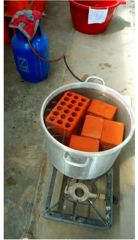
Figura 101. Ensayo de absorción máxima de los ladrillos MVF – Parte 1.
