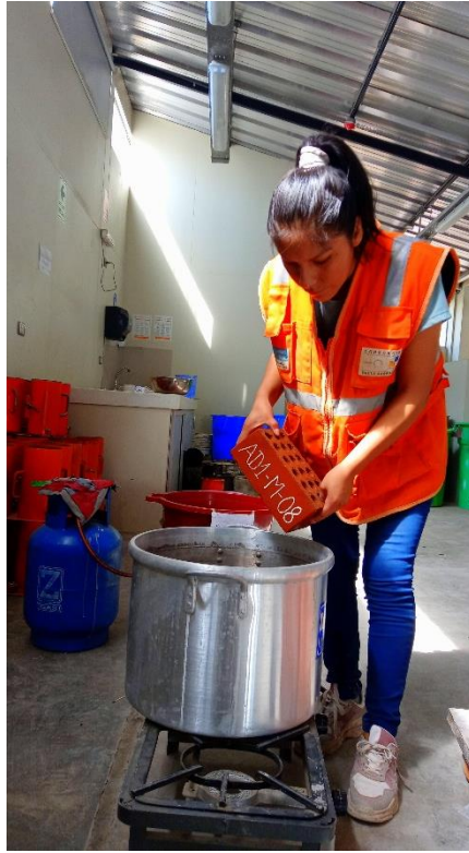
Figura 101. Ensayo de absorción máxima de los ladrillos MVF – Parte 1.
