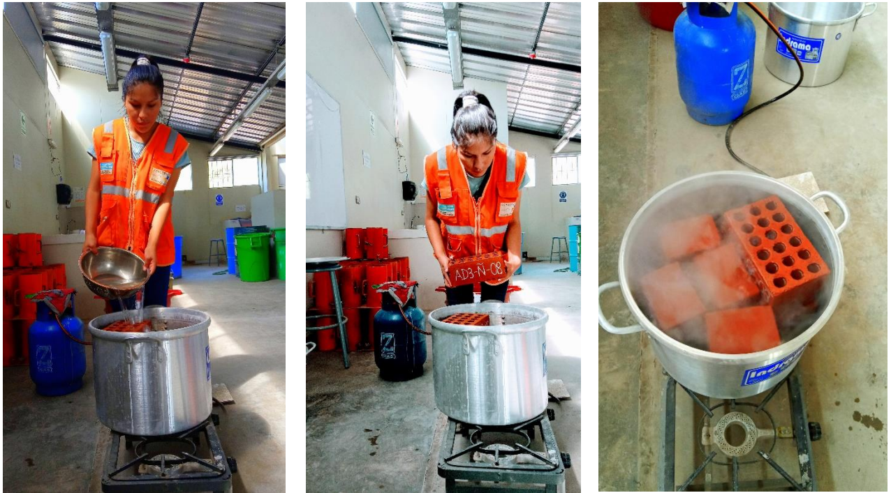
Figura 77. Ensayo de absorción máxima de los ladrillos ÑOÑO – Parte 1.
