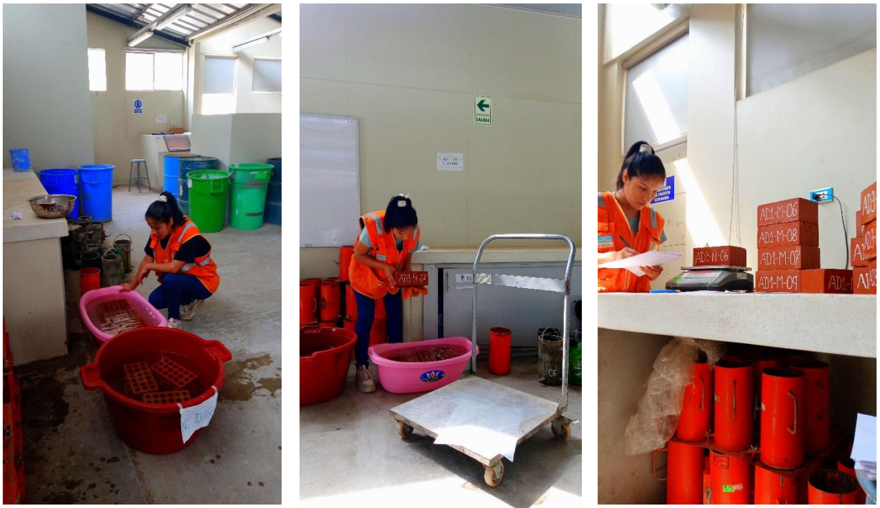
Figura 76. Ensayo de absorción de los ladrillos ÑOÑO – Parte 2.
