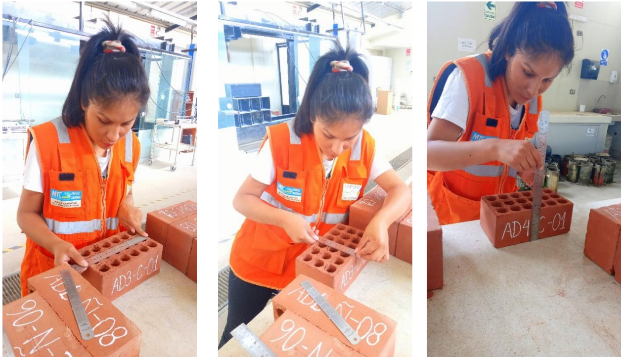
Figura 81. Ensayo de variación dimensional de los ladrillos CERANDES.
