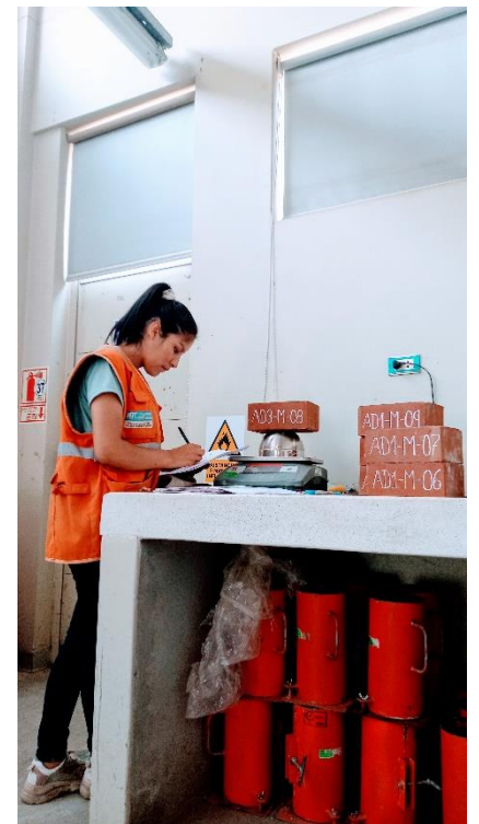
Figura 102. Ensayo de absorción máxima de los ladrillos MVF – Parte 2.
