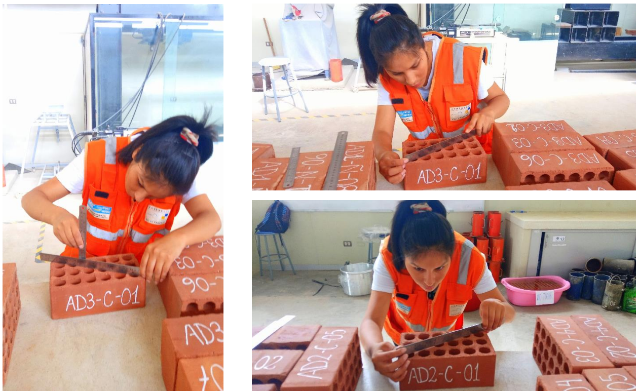
Figura 82. Ensayo de alabeo de los ladrillos CERANDES.
