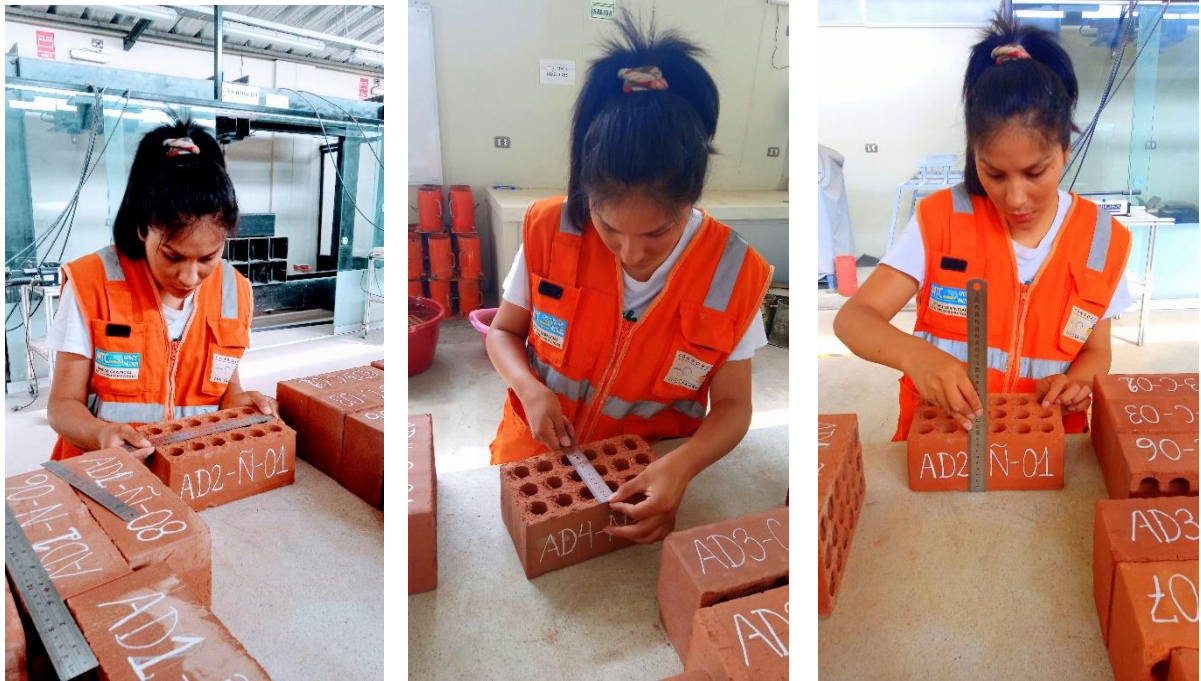
Figura 69. Ensayo de variación dimensional de los ladrillos ÑOÑO
