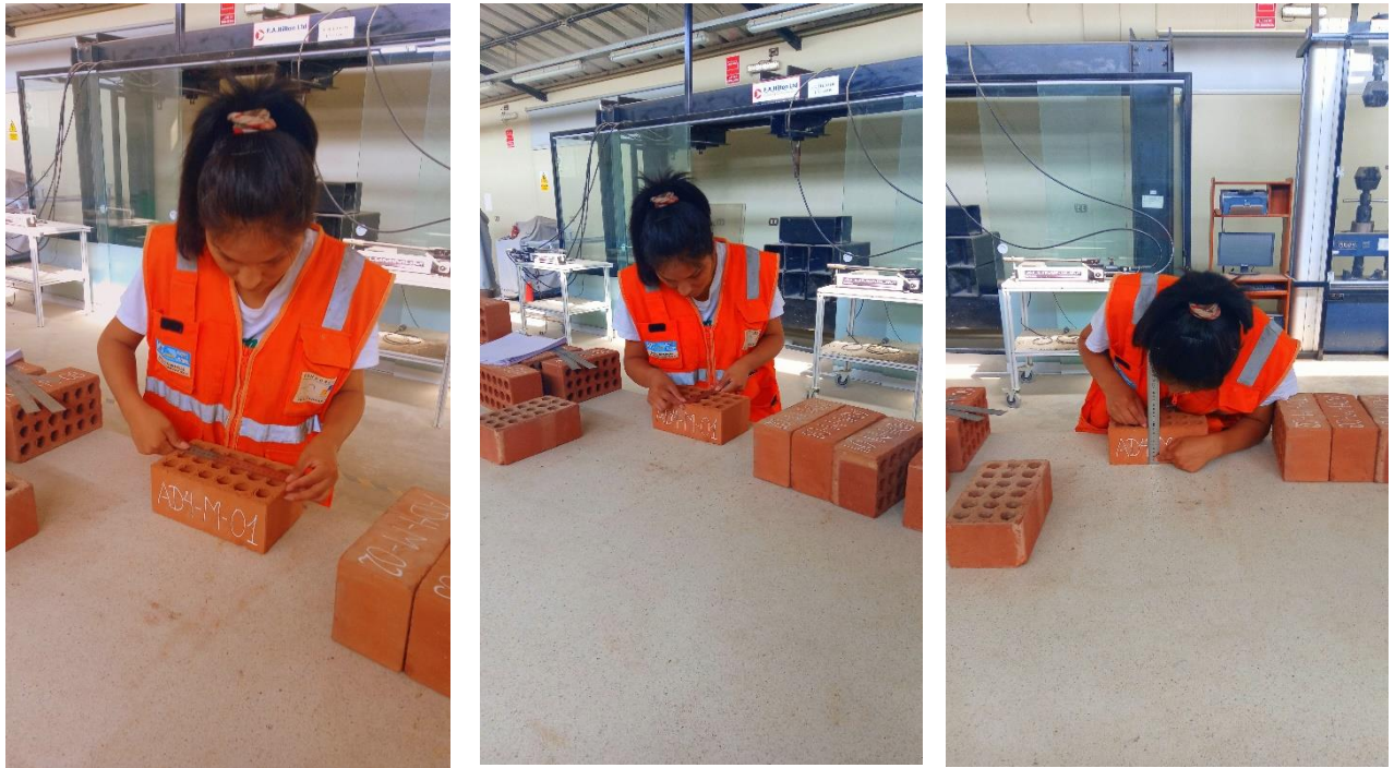
Figura 93. Ensayo de variación dimensional de los ladrillos MVF.
