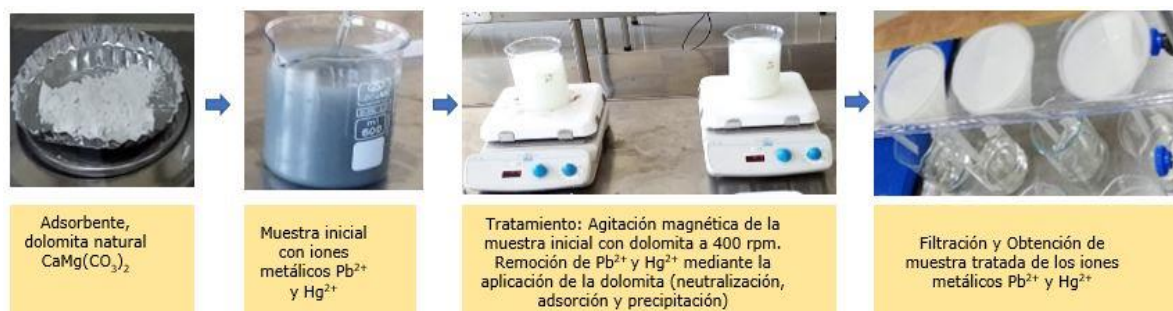
Figura 2. Esquema del proceso de tratamiento empleando la dolomita como adsorbente en la remoción de Pb^{2+} y Hg^{2+} .
