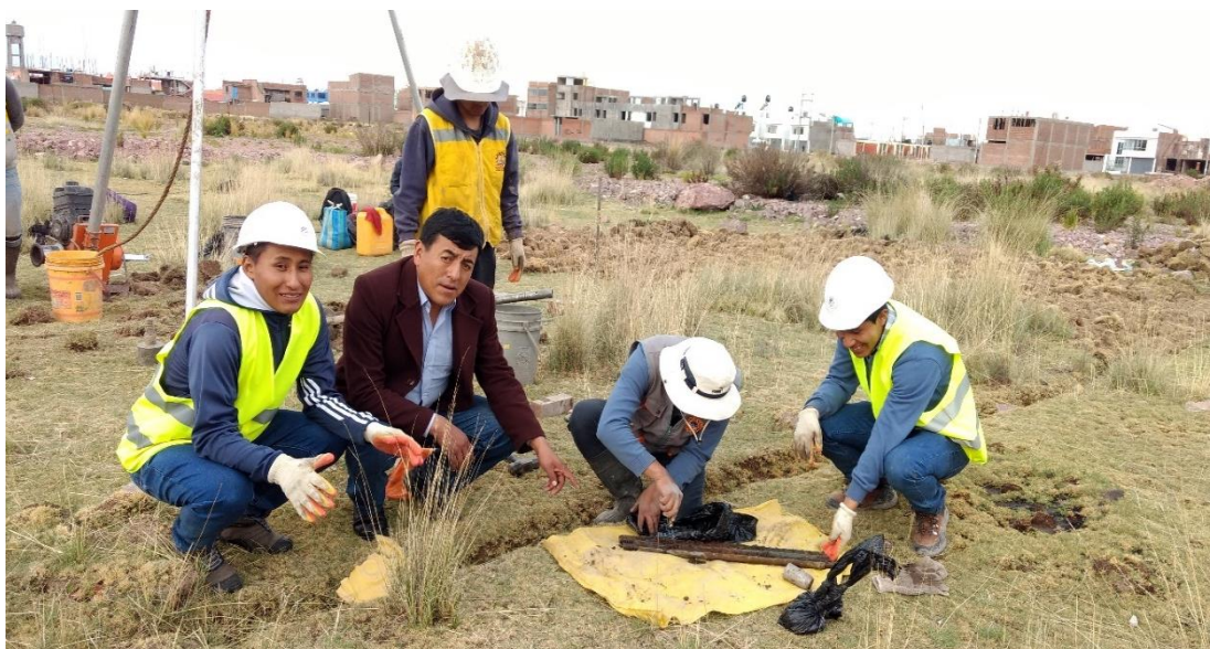
Figura 27. Extracción de muestra con el SPT.
