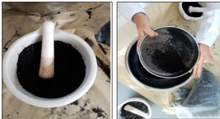
Figure 4. Triturado y Tamizado del Biochar.
