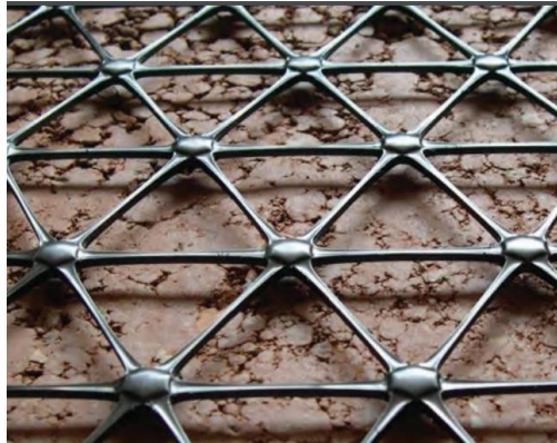
Figura 04. Geomalla triaxial. Fuente: (TENSAR, 2014)
