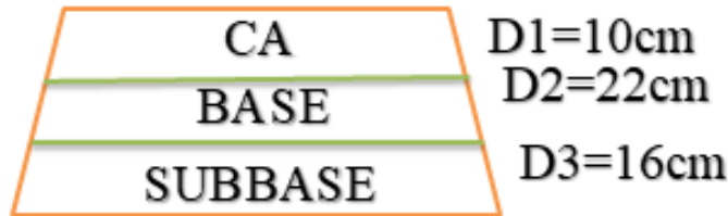
Figura 64. Espesores del pavimento flexible estabilizado con 4% de adición de cemento. Fuente: Elaboración propia.
