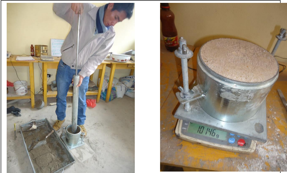
Fotografía 07. Realizando el ensayo de compactación de suelos
