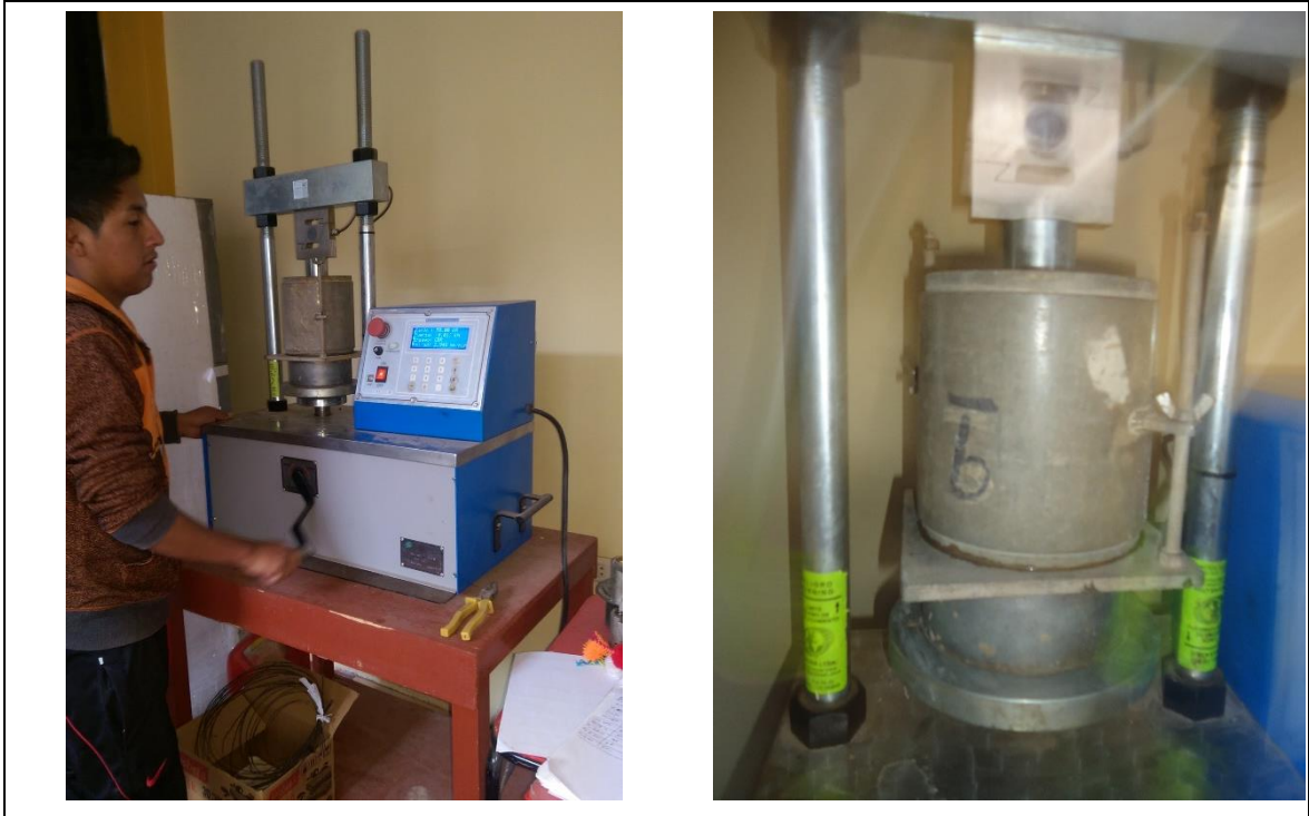
Fotografía 10. Realizando el ensayo de CBR.
