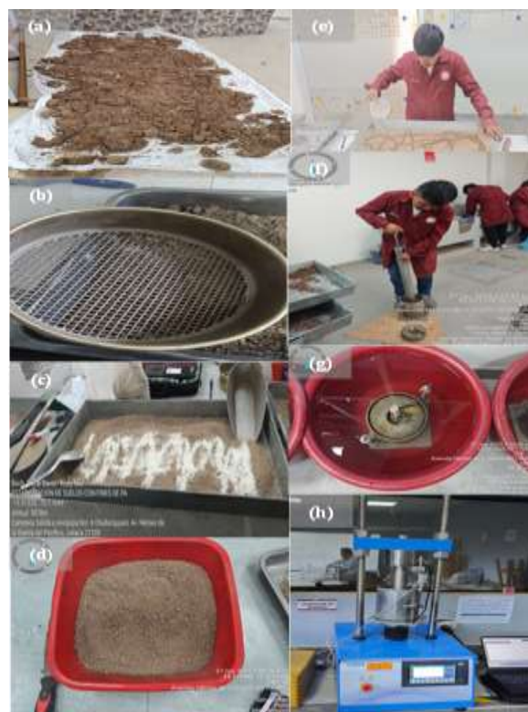
Figura 5. (a) Suelo, (b) Tamizado por Malla N° 04, (c) Adición de cal/cemento, (d) Homogenización de Suelo y adición, (e) Adición de agua, (f) Compactación de muestra adicionada, (g) Curado, y (h) Ensayo, penetración de probeta.
