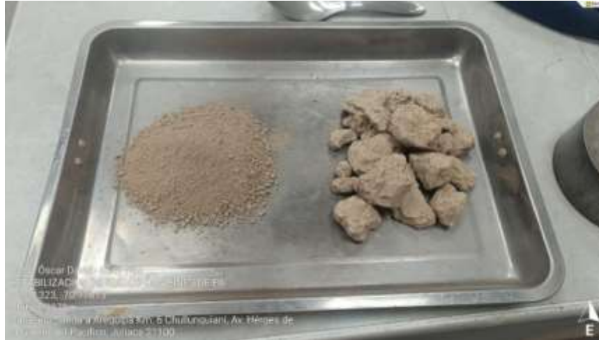
Figura 1. En la ilustración se muestra la arcilla en estado seco extraído de campo la muestra de arcilla triturada y clasificada por el tamiz N° 04.
