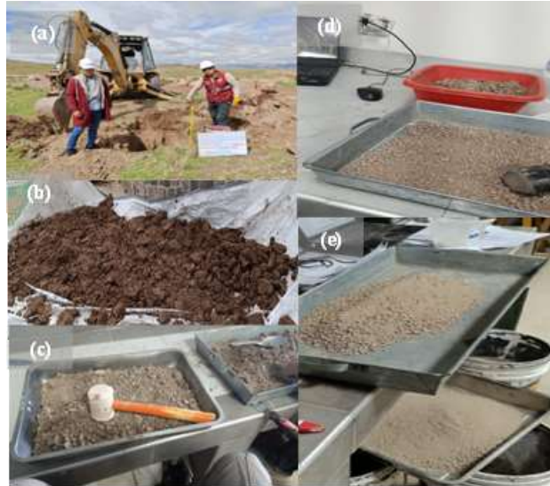
Figura 2. (a) Extracción del suelo, (b) Secado, (c) Desterronado, (d) Tamizado, (e) Almacenado.
