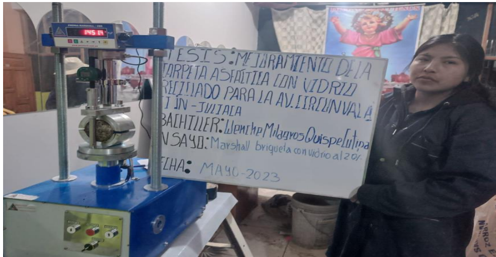
Imagen 5: Ensayo de estabilidad Marshall en laboratorio.
