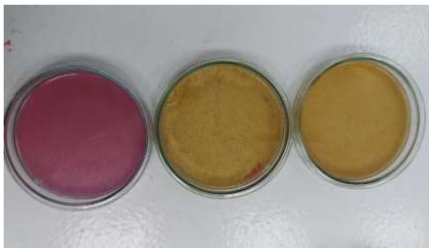
Figura 2. Ensayo microbiológico al ladrillo con lodo residual (coliformes, E Coli y Salmonella)
