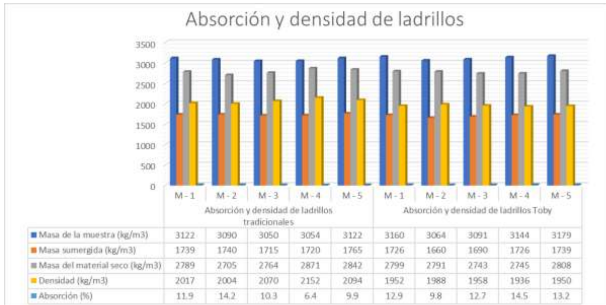
Figura 3. Absorción y densidad de ladrillos
