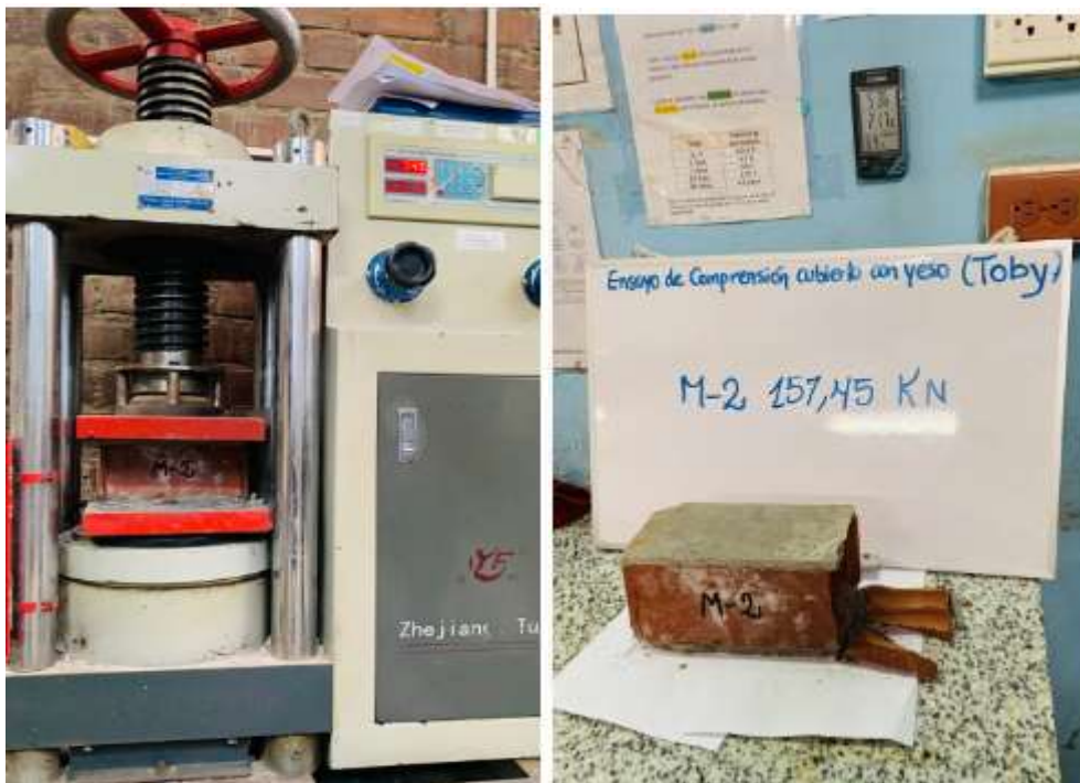
Figura 5. Proceso de evaluación de resistencia a la compresión
