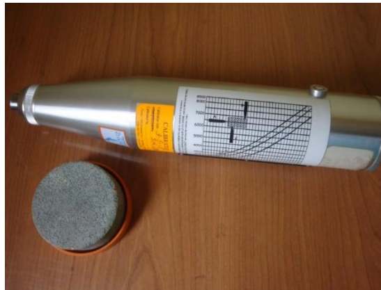
Figura 62. Esclerómetro usado para el ensayo. Fuente: Propia.
