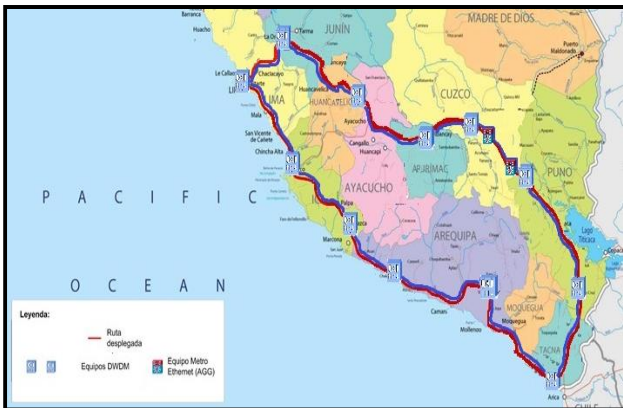
Figura 40. Diseño dela red DWDM y el recorrido dela fibra óptica en todo el Perú.
