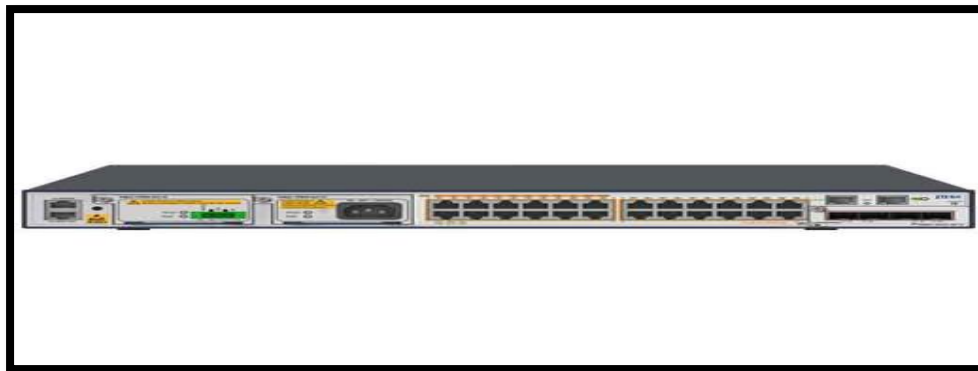
Figura 10. Router de nivel acceso.
