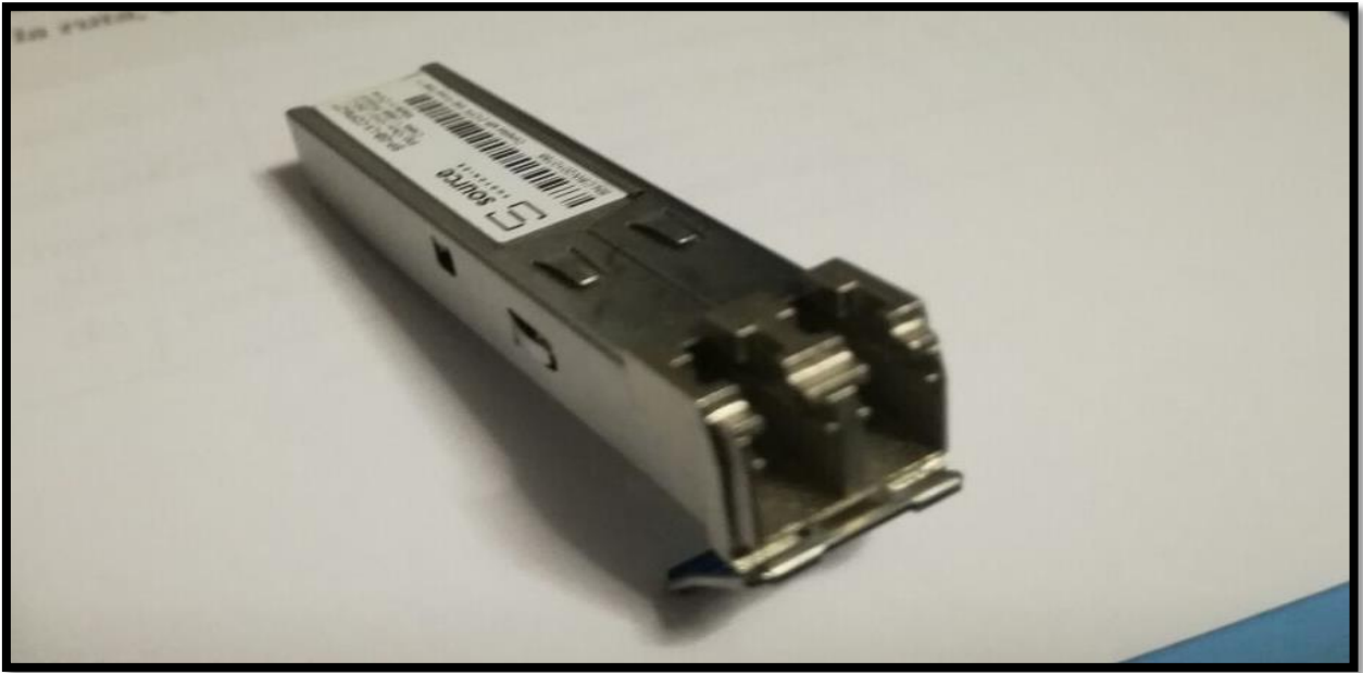
Figura 23. Transmisor óptico Transceiver.
