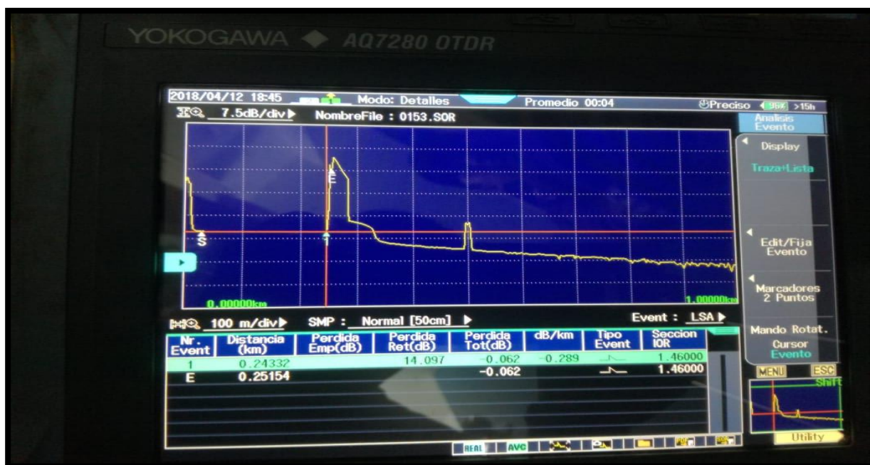
Figura 26. Medición de hilos con OTDR.
