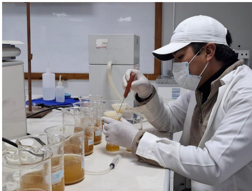
Figura 27. Filtración del adsorbente.
