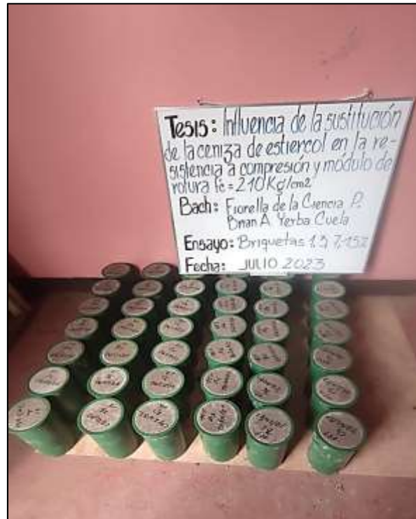
Anexo 7: Moldeado de briquetas para un diseño f_c = 210 \text{ kg/cm}^2 con la sustitución porcentual en 1%, 3%, 7% y 15%.
