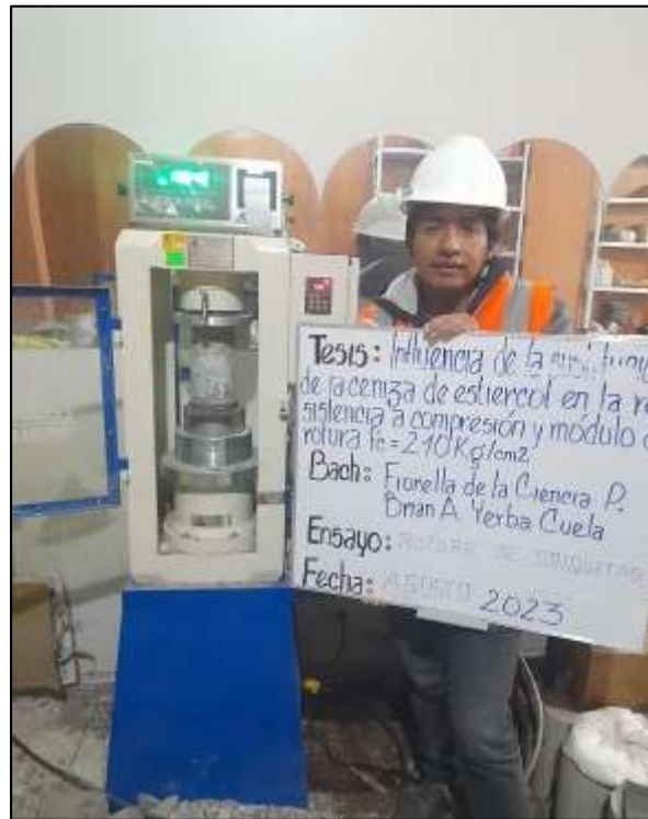
Anexo 9: Rotura de Briquetas en el laboratorio CICMIC B&P SRL Juliaca - Puno.
