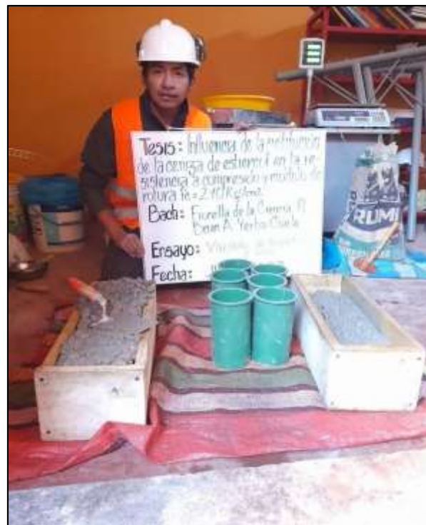
Anexo 6: Moldeado de briquetas y vigas para un diseño f_c=210\text{kg/cm}^2 .
