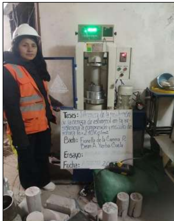
Anexo 10: Ensayo de Rotura de Briquetas en el laboratorio CICMIC B&P SRL Juliaca - Puno.
