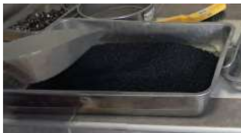
Figura 4. Recolección y clasificación, caucho reciclado pasante malla N°4.
