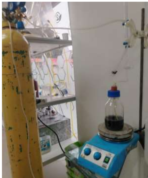
Figura 1. Coprecipitación química para sintetizar nanopartículas de magnetita.
