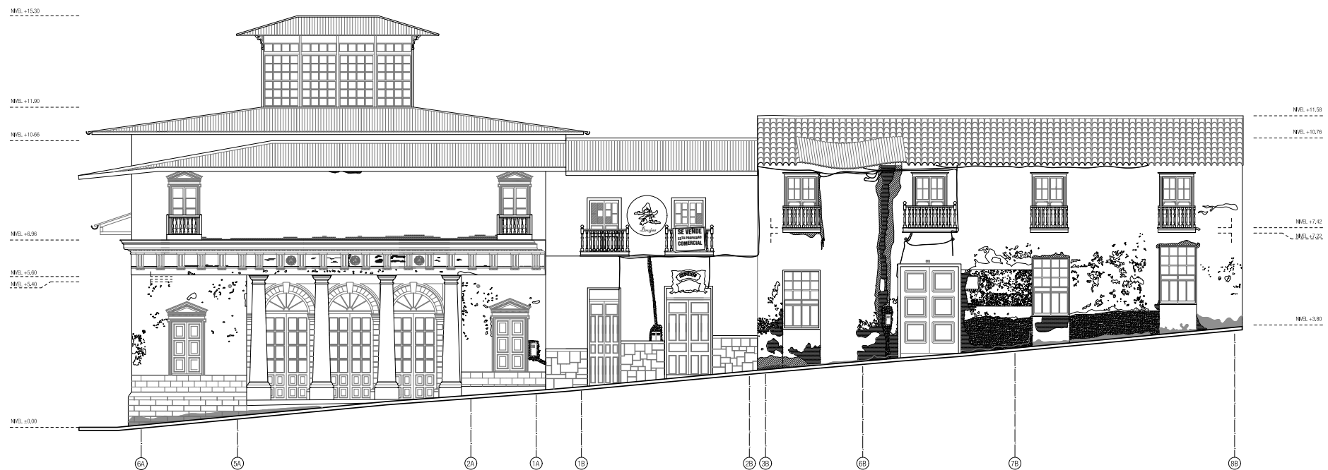
Figura 111. Estado Actual fachada principal. Elaboración propia
