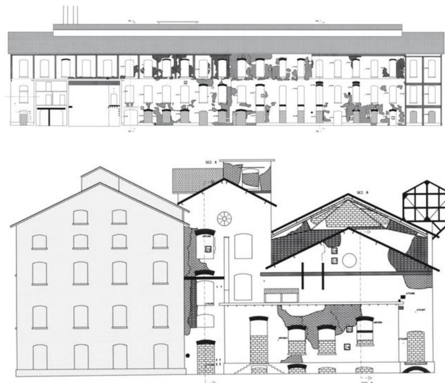
Figura 76. Levantamiento del estado del edificio antes de ser intervenido. Fuente: Fondazione Renzo Piano, 2001. https://goo.gl/L4wnna
