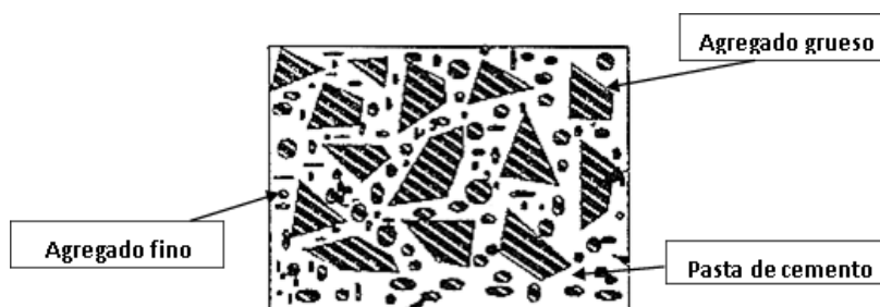
Figura 1. Estructura del concreto endurecido Fuente: Civilgeeks.com
