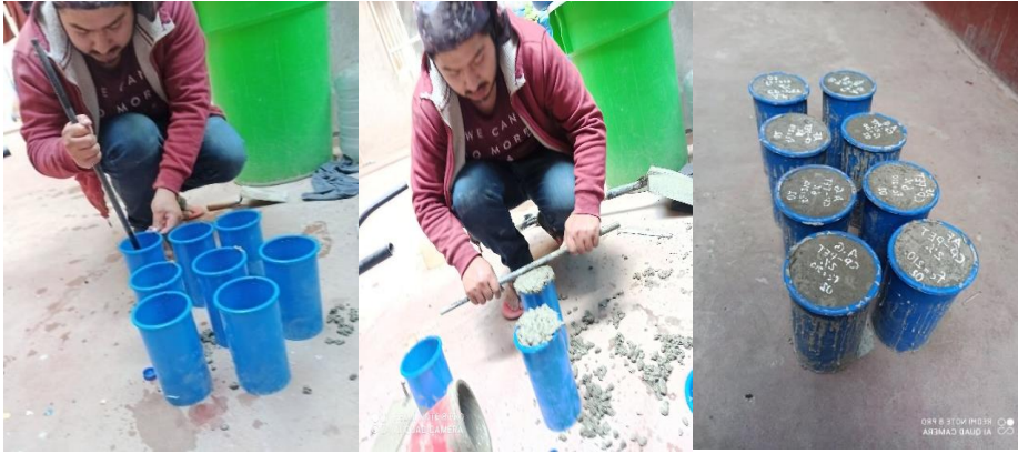
Imagen 6. Vaciado de probetas cilíndricas Fuente: Elaboración propia
