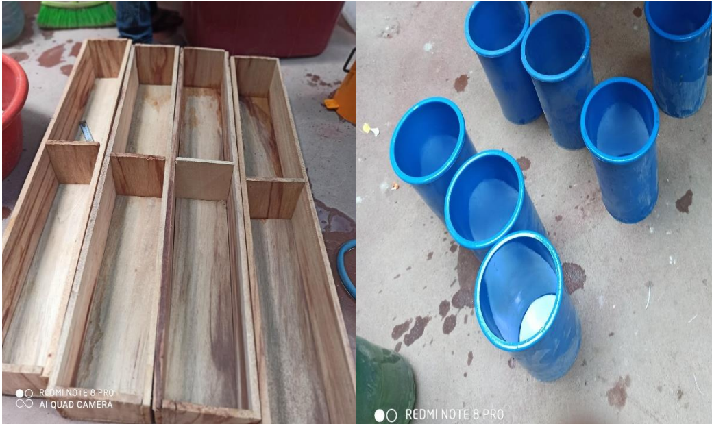
Imagen 5. Moldes cilíndricos y prismáticos para ensayos de resistencia a la compresión y resistencia a la flexión
