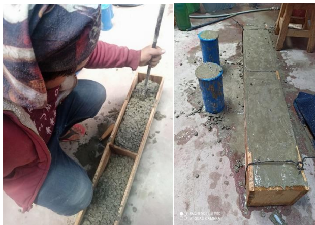
Imagen 7. Vaciado de las vigas Fuente: Elaboración propia
