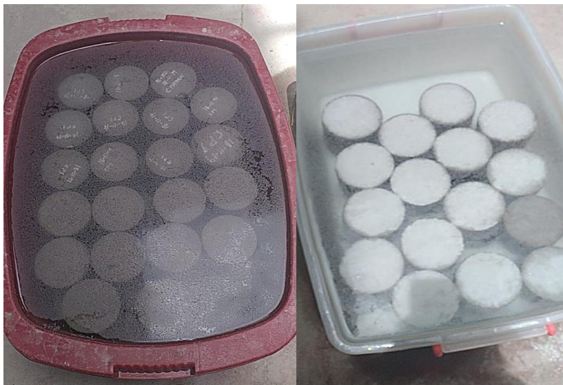
Imagen 8 Curado de muestras cilíndricas de concreto Fuente: Elaboración propia
