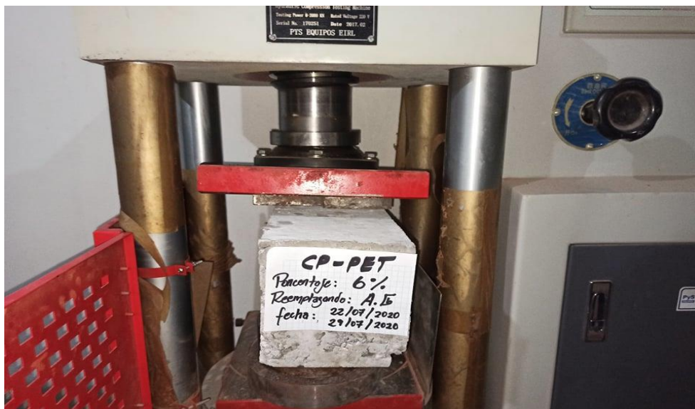
Fotografía 6. Ensayo a flexión viga CP-PET 6% remplazo al A.G
