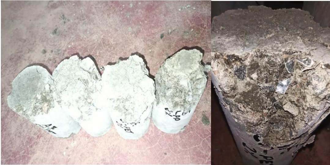
Fotografía 7. Ensayo a compresión en muestras cilíndricas con adición de PET
