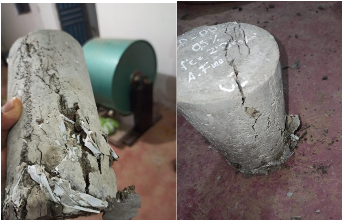
Fotografía 8. Ensayos a compresión con adición de PP
