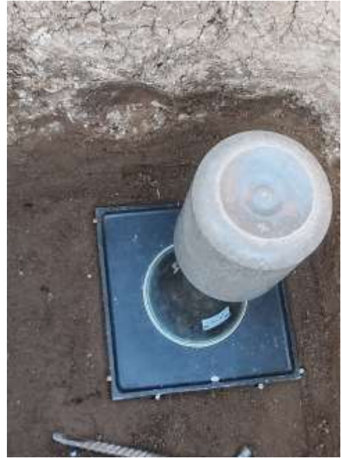
Nota. Se realizó los ensayos de densidad de campo con el cono de arena
