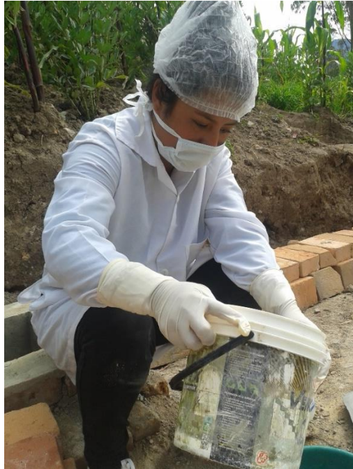
Figura 96. Toma de muestra para los parámetros físicos (Turbidez, pH, oxígeno disuelto, temperatura, sólidos disueltos totales y conductividad eléctrica)
