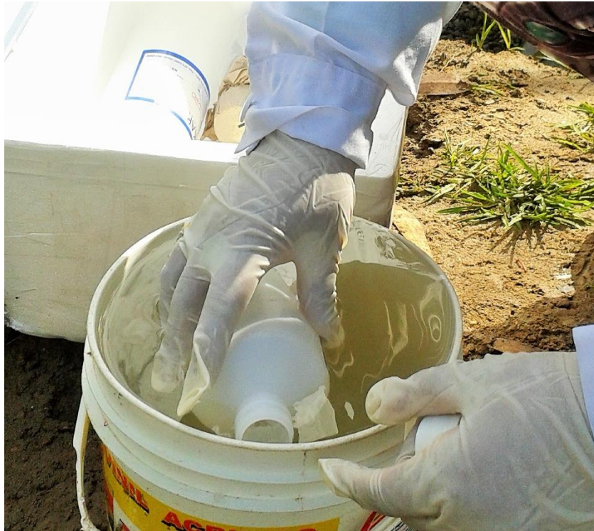
Figura 103. Toma de muestra de los parámetros físicos (Turbidez, pH, oxígeno disuelto, temperatura, sólidos disueltos totales y conductividad eléctrica)
