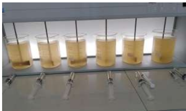
Fotografía 1. Cloruro Férrico Toma de muestra con los sifones
