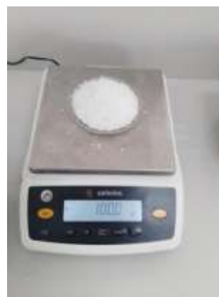
Fotografía .4 Pesado de Sulfato de Aluminio
