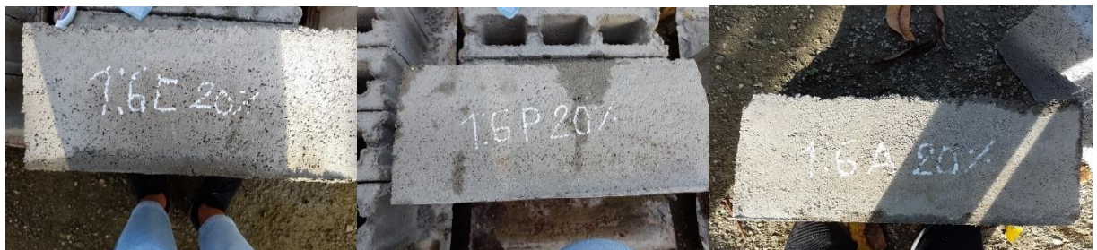
Figura 6. Etiquetado de muestras para rotura en ensayo de compresión de concreto.
