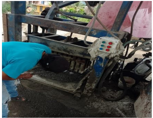
Figura 7. Vibrado de bloques de concreto en máquina volqueteera compacta.
