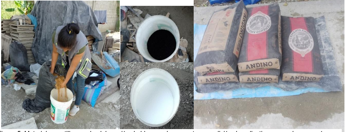
Figura 5. Materiales a utilizar en la elaboración de bloques de concreto con adición de poliestireno, caucho y aserrín.
