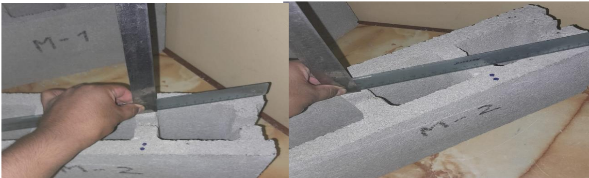
Figura 8. Toma de medida para ensayo de alabeo.
