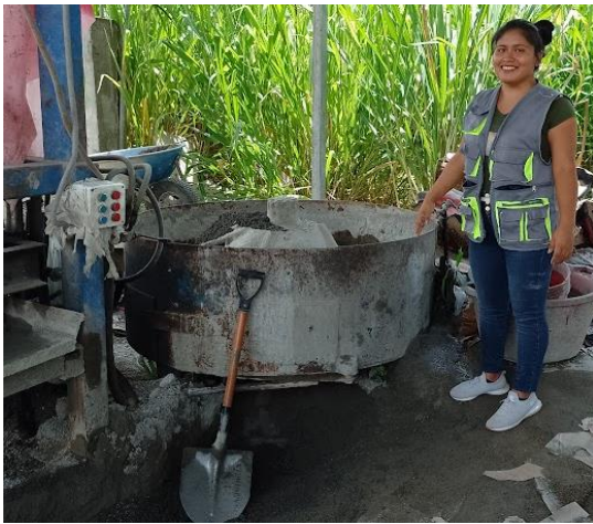
Figura 6. Mezclado de materiales en mezcladora tipo batea.
