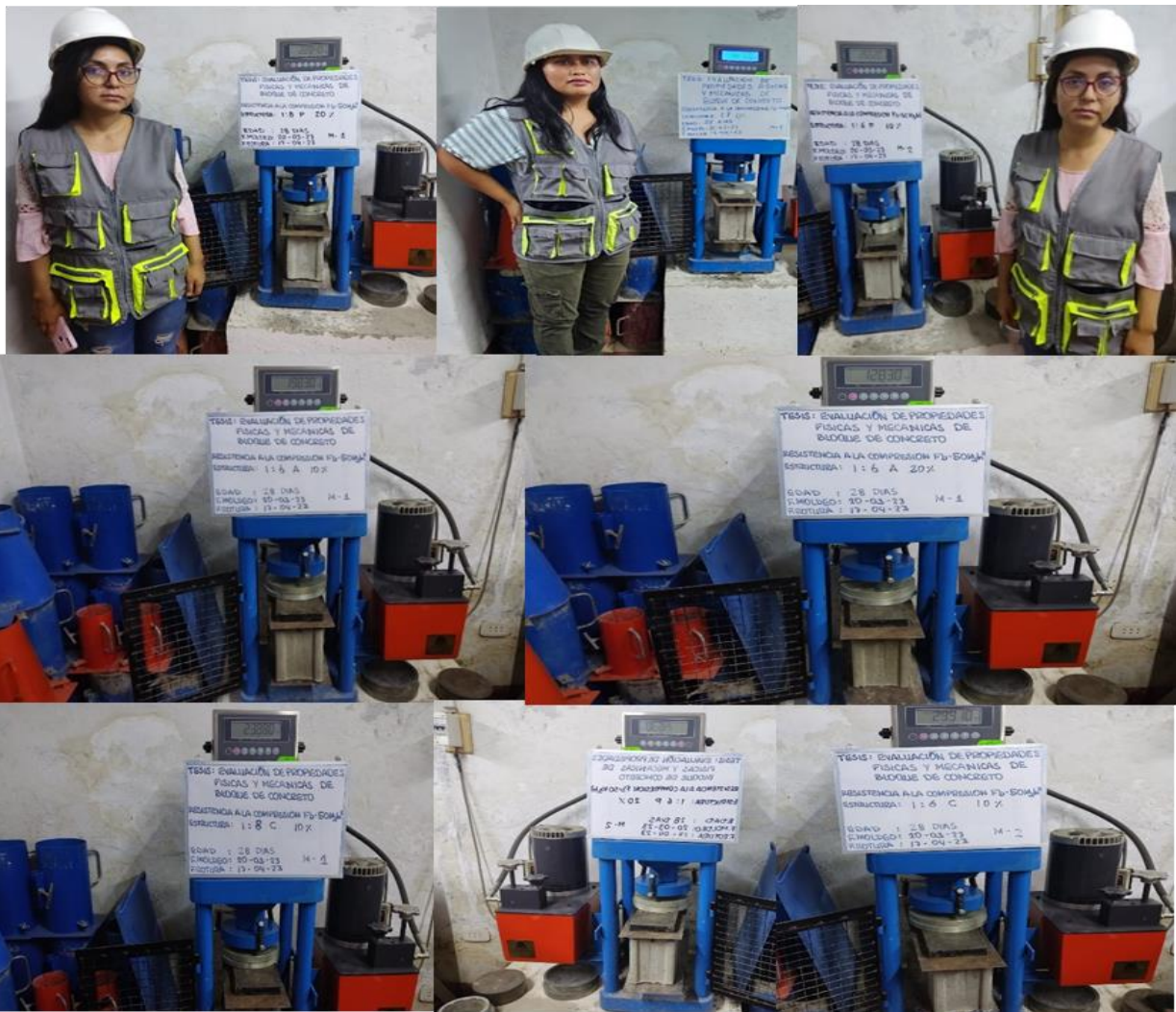
Figura 12. Ensayo de compresión de concreto a los 28 días de curado.
