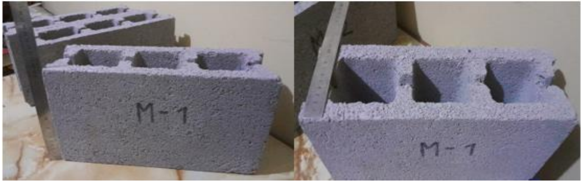
Figura 9. Toma de medidas de bloques de concreto (alto, ancho, y largo) para ensayo de variación dimensional.
