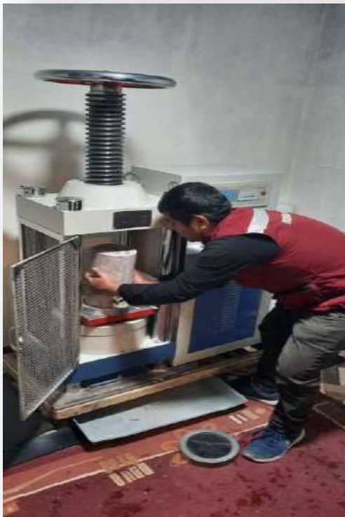
IMAGEN 04. En la imagen se observa la prueba de resistencia a la compresión (ASTM C39)
