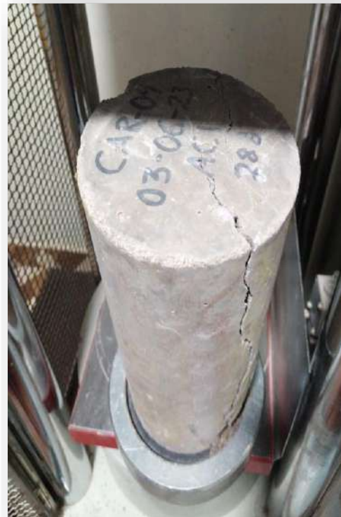
IMAGEN 04. En la imagen se observa la prueba de resistencia a la compresión (ASTM C39)
